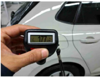
Lackstärke Seitenwand hinten rechts
