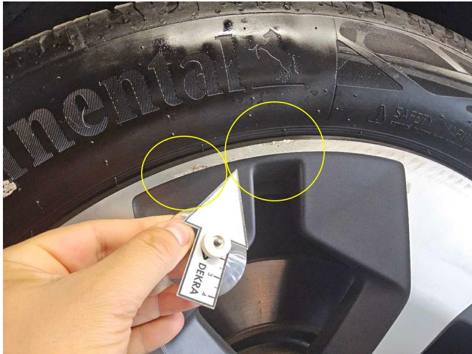
Bild 27 : Glanzgedrehte Alufelgen vorne links, verschrammt
