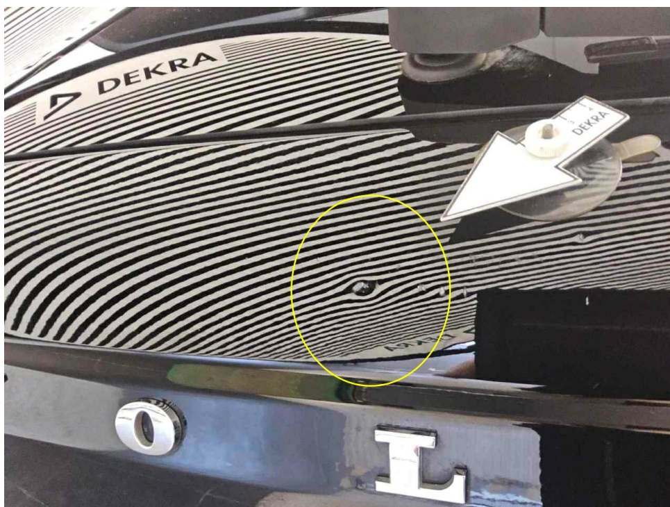
Bild 16 : Heckklappe, eingedellt, instandsetzen und lackieren mit Lackaufbau
