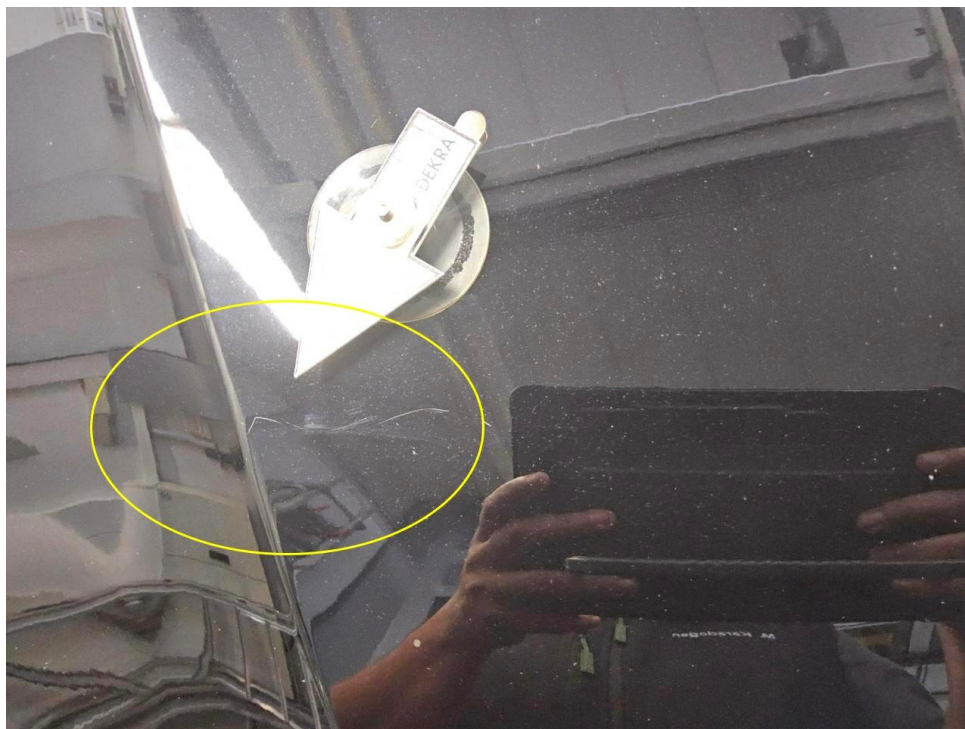
Bild 25 : Motorhaube Lackierung, zerkratzt, polieren
