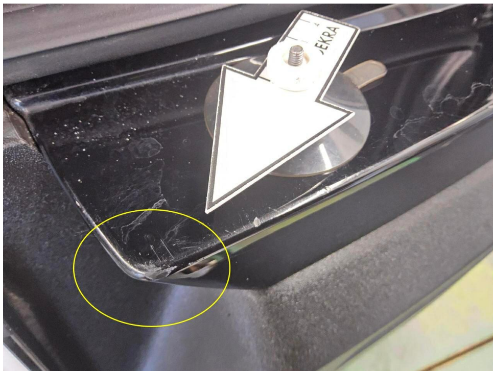
Bild 20 : Stoßfänger hinten Lackierung, zerkratzt, lackieren
