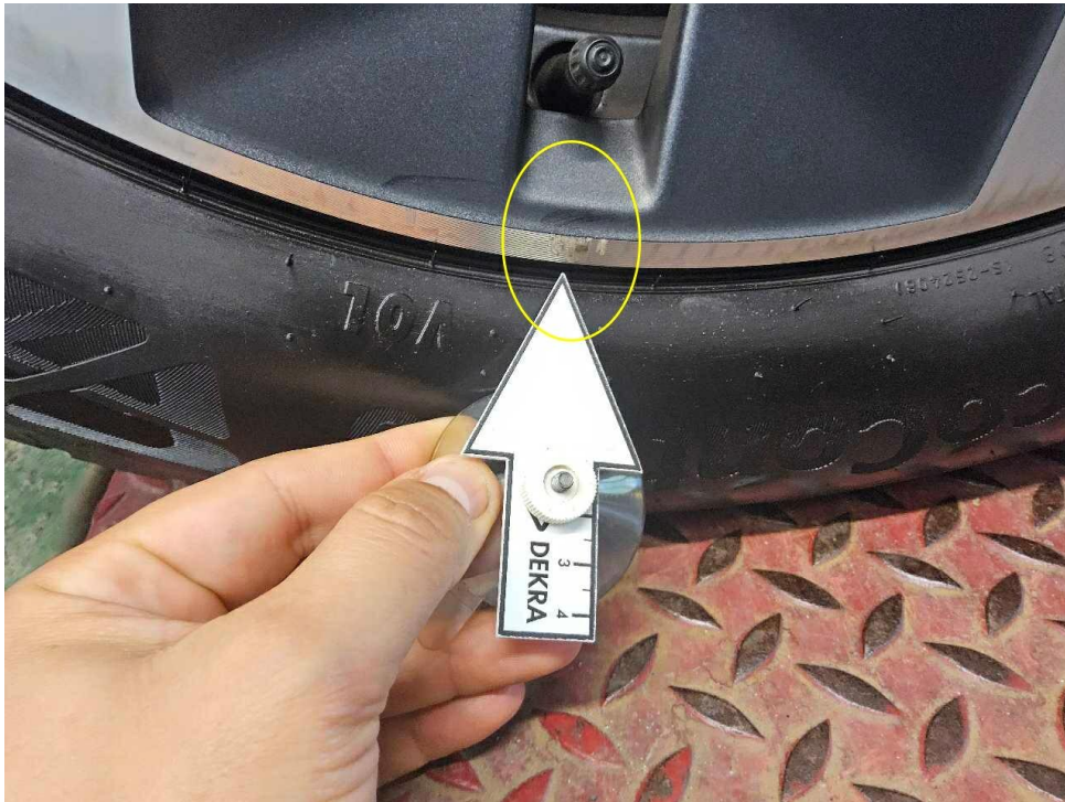
Bild 29 : Glanzgedrehte Alufelgen vorne rechts, leicht oxidiert
