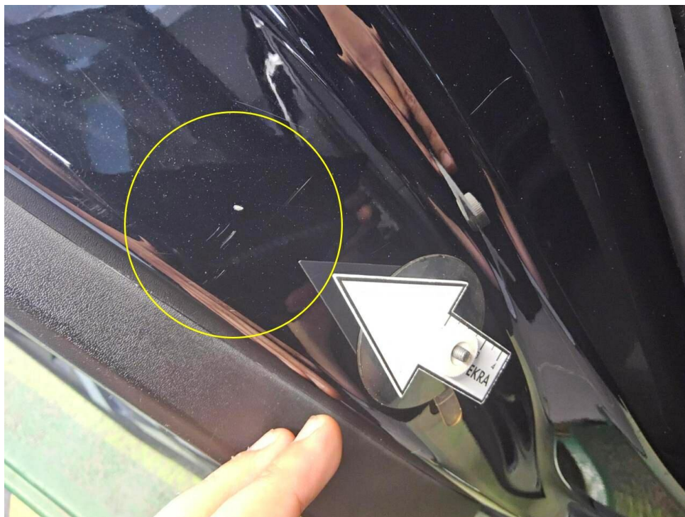
Bild 15 : Tür hinten rechts Einstieg Lackierung, zerkratzt, smart repair
