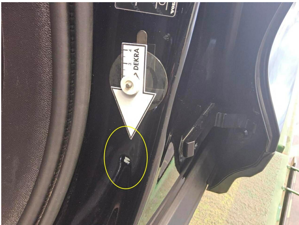
Bild 24 : Tür vorne links Einstieg Lackierung, zerkratzt, smart repair
