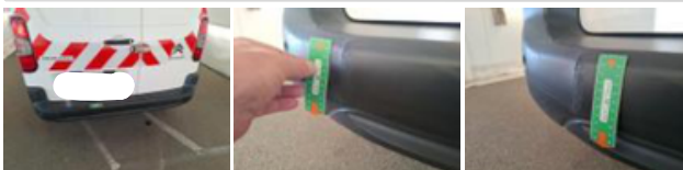
Pare-chocs AR, Déformé / Forcé, E - Remplacer
