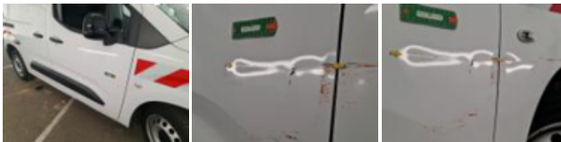
Aile AVD, Bosse(s) et griffe(s), LI - Réparer et peindre (complet)
