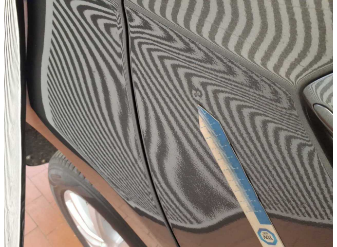
Damage 4: Door - rear right side: Door (Drücken und Auslegen/Polieren) - Dent / paintcoat damage - Smart repair
