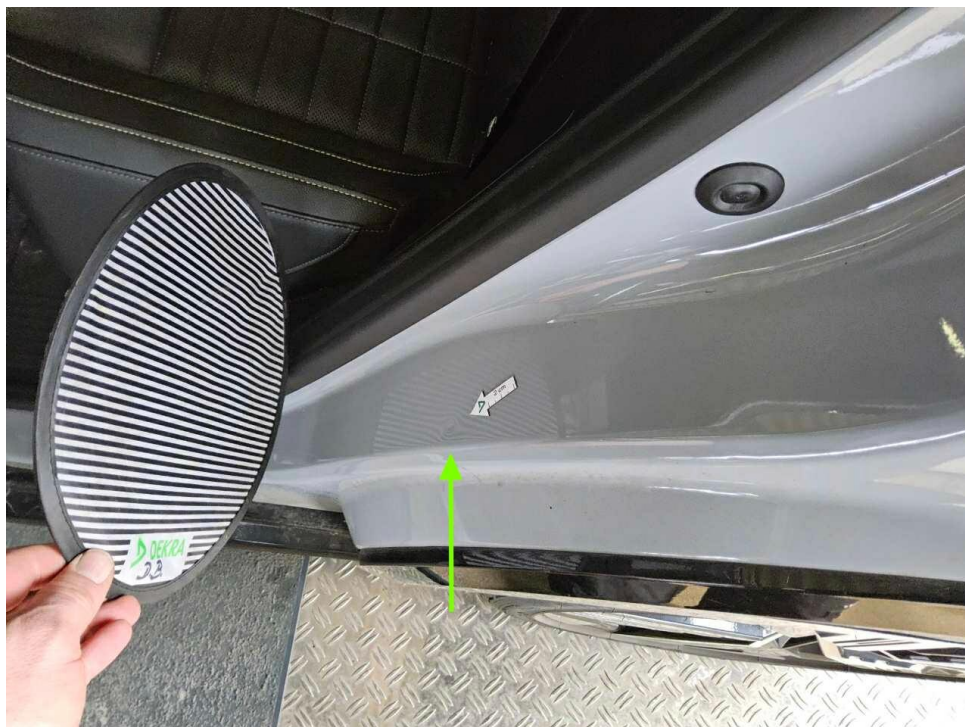
Bild 22 : Tür hinten links Einstieg, eingedellt, drücken
