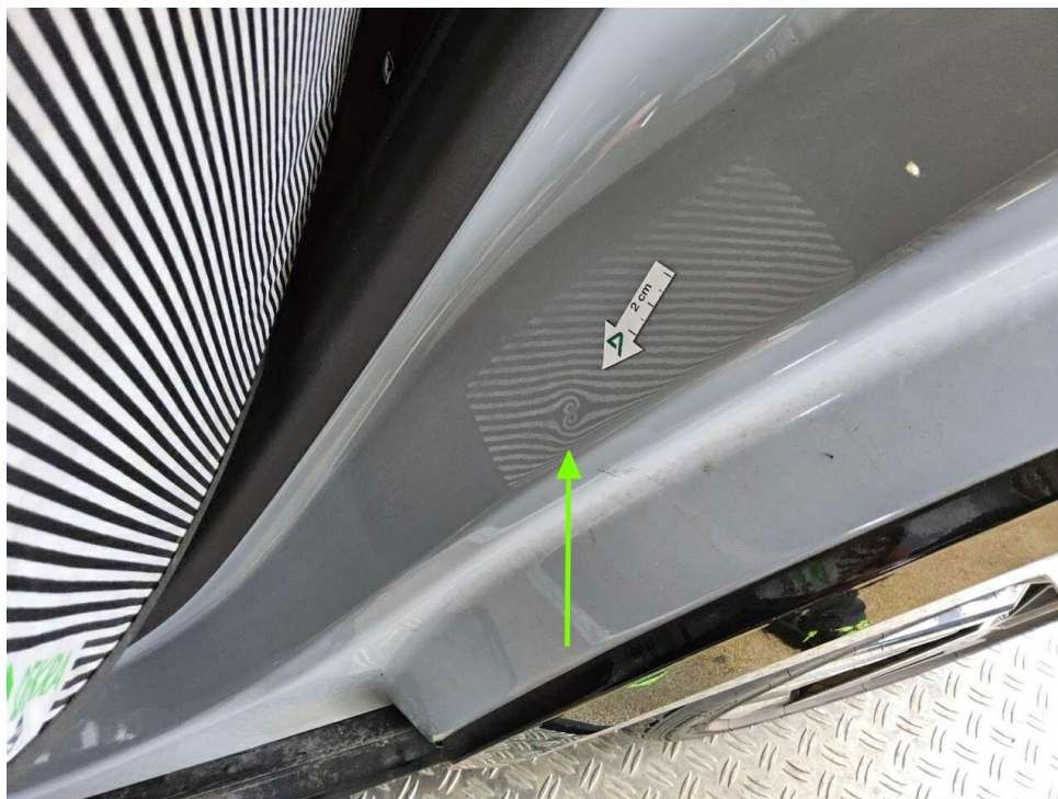
Bild 23 : Tür hinten links Einstieg, eingedellt, drücken
