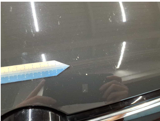
Damage 5: Bonnet: Bonnet (teilweise lackieren) - Stone chips - Paint
