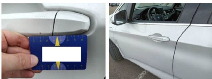
Deur LV - Deurklink LV - Kras - Spuiten
