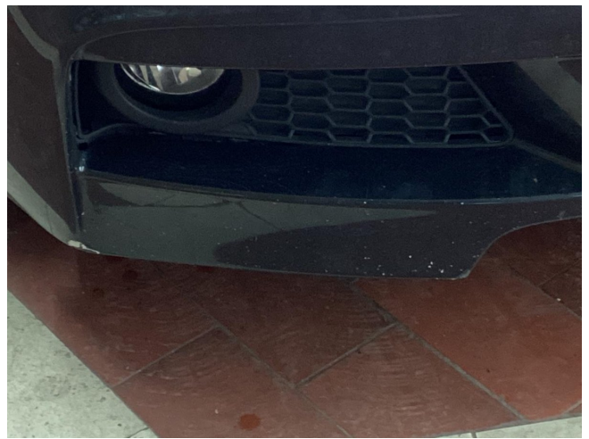
Stoßfänger vorne verformt - erneuern
