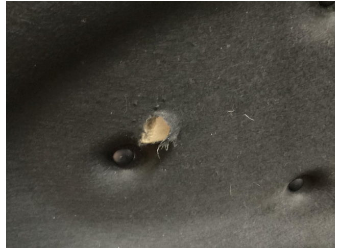
Dämmung Motorhaube Nagetierfraß - erneuern
