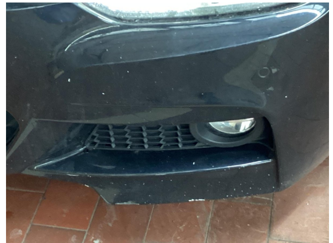
Stoßfänger vorne verformt - erneuern
