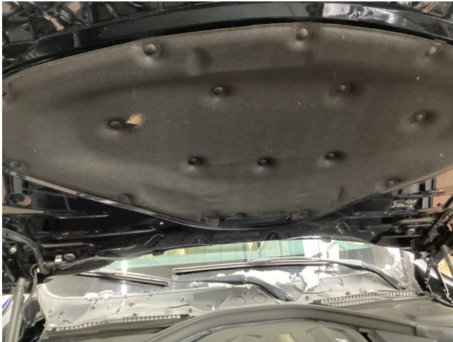
Dämmung Motorhaube Nagetierfraß - erneuern
