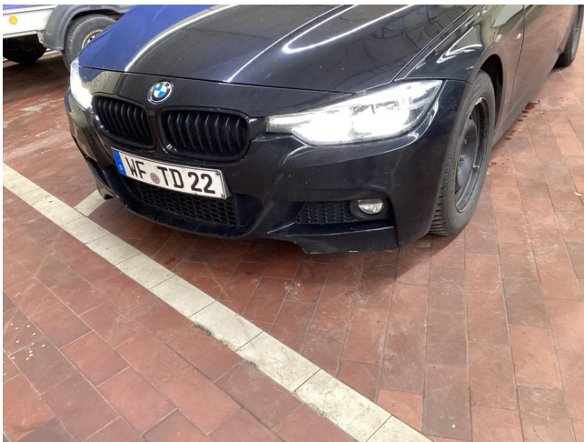
Stoßfänger vorne verformt - erneuern
