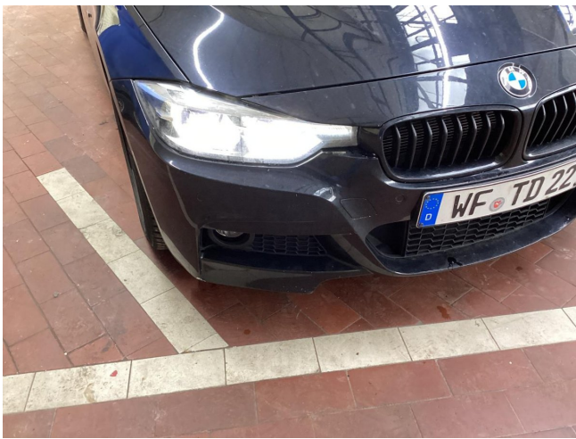
Stoßfänger vorne verformt - erneuern
