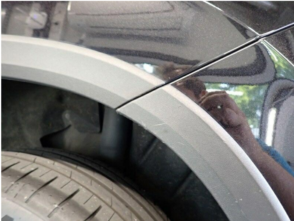
Bild 17 : Restreparaturspuren am Heck sichtbar, Heckklappe, Stoßfänger hinten, Kratzer, Verformungen, silikonkrater und Staubeinschlüsse
