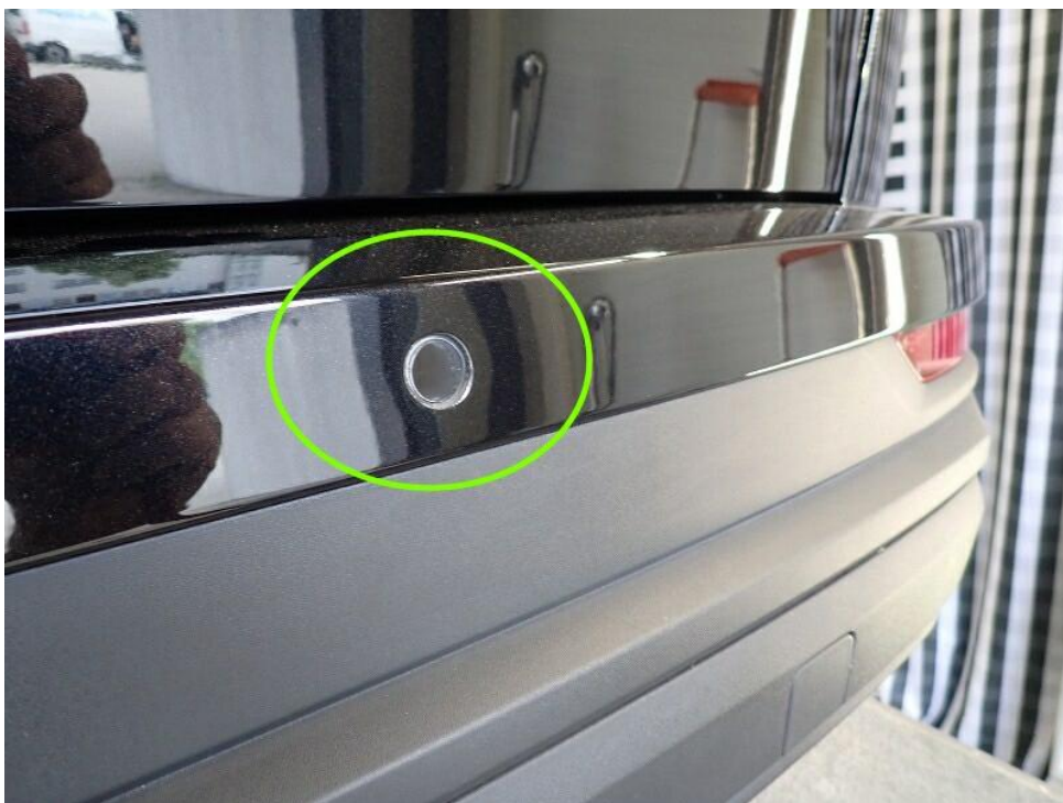
Bild 18 : Restreparaturspuren am Heck sichtbar, Heckklappe, Stoßfänger hinten, Kratzer, Verformungen, silikonkrater und Staubeinschlüsse
