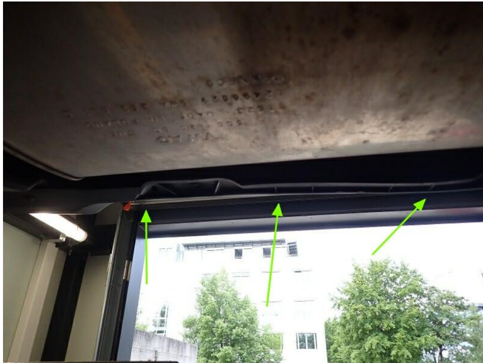
Bild 33 : Restreparaturspuren am Heck sichtbar, Heckklappe, Stoßfänger hinten, Kratzer, Verformungen, silikonkrater und Staubeinschlüsse
