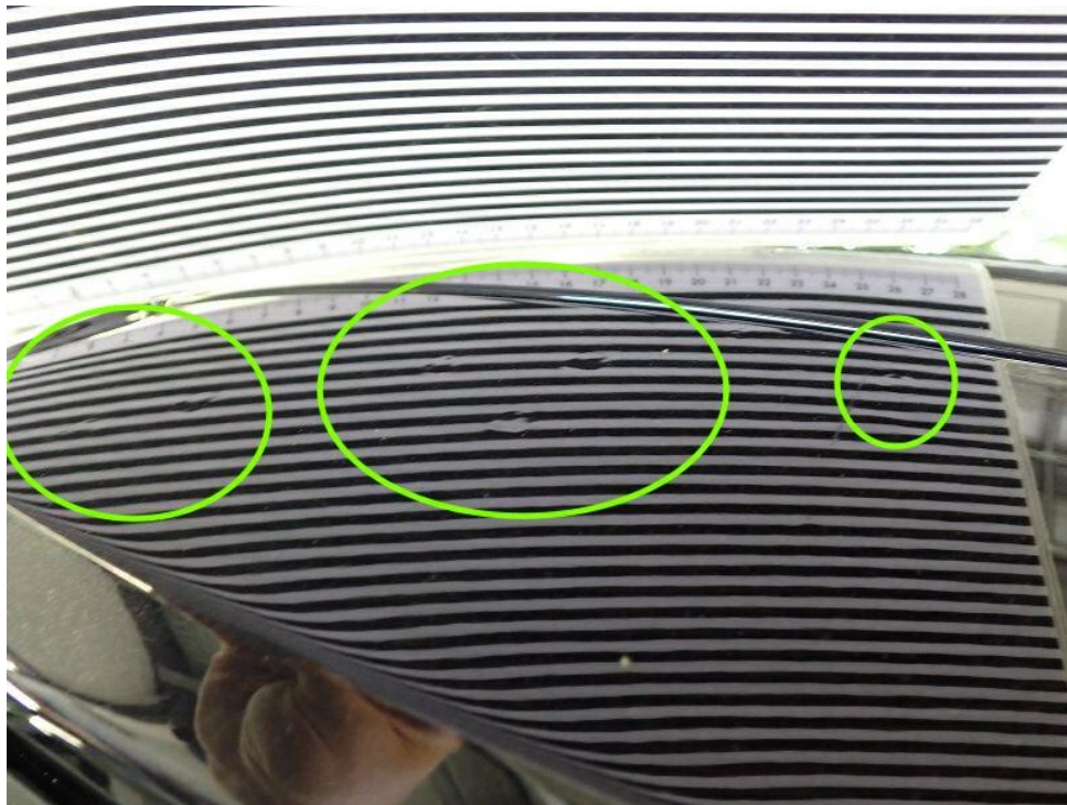
Bild 39 : Restreparaturspuren am Heck sichtbar, Heckklappe, Stoßfänger hinten, Kratzer, Verformungen, silikonkrater und Staubeinschlüsse
