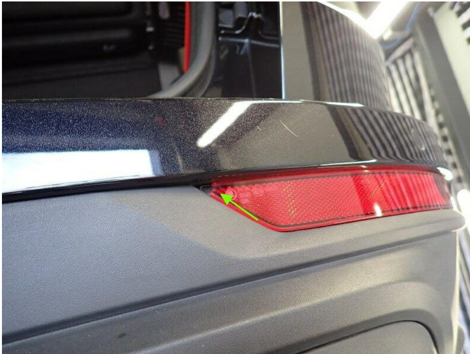
Bild 35 : Restreparaturspuren am Heck sichtbar, Heckklappe, Stoßfänger hinten, Kratzer, Verformungen, silikonkrater und Staubeinschlüsse
