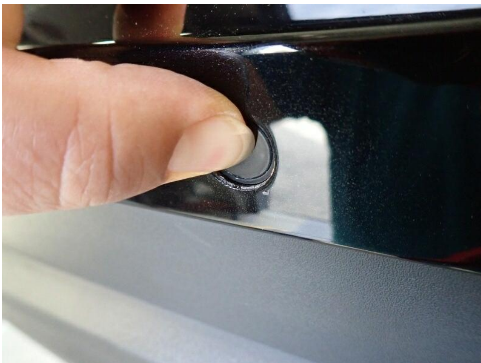
Bild 20 : Restreparaturspuren am Heck sichtbar, Heckklappe, Stoßfänger hinten, Kratzer, Verformungen, silikonkrater und Staubeinschlüsse
