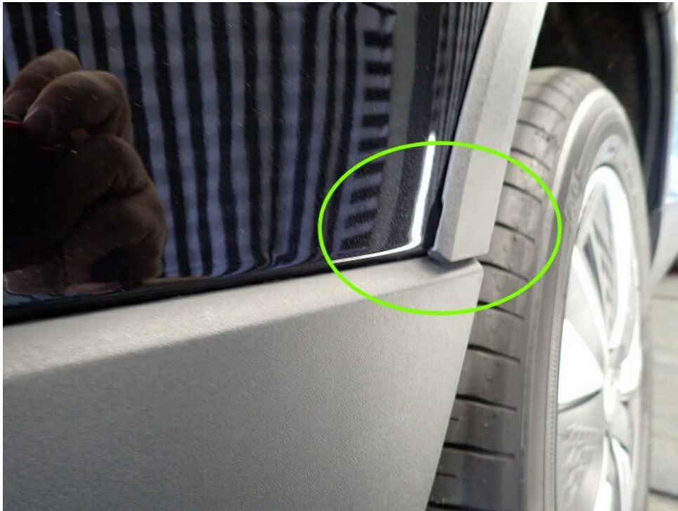
Bild 15 : Restreparaturspuren am Heck sichtbar, Heckklappe, Stoßfänger hinten, Kratzer, Verformungen, silikonkrater und Staubeinschlüsse
