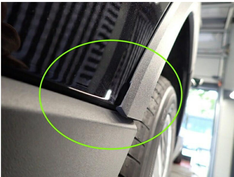
Bild 16 : Restreparaturspuren am Heck sichtbar, Heckklappe, Stoßfänger hinten, Kratzer, Verformungen, silikonkrater und Staubeinschlüsse
