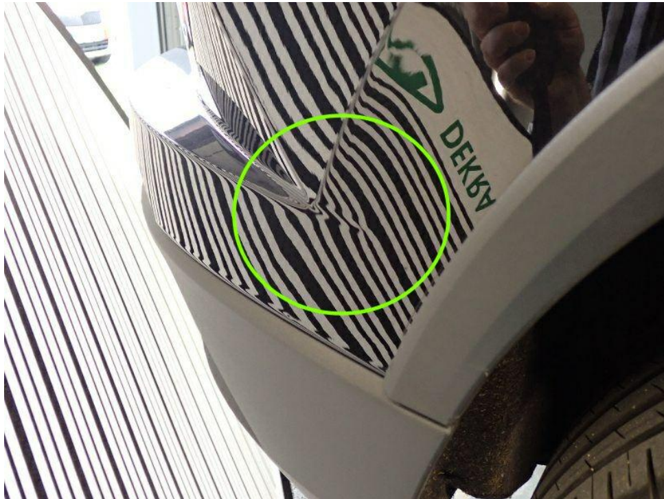
Bild 31 : Restreparaturspuren am Heck sichtbar, Heckklappe, Stoßfänger hinten, Kratzer, Verformungen, silikonkrater und Staubeinschlüsse
