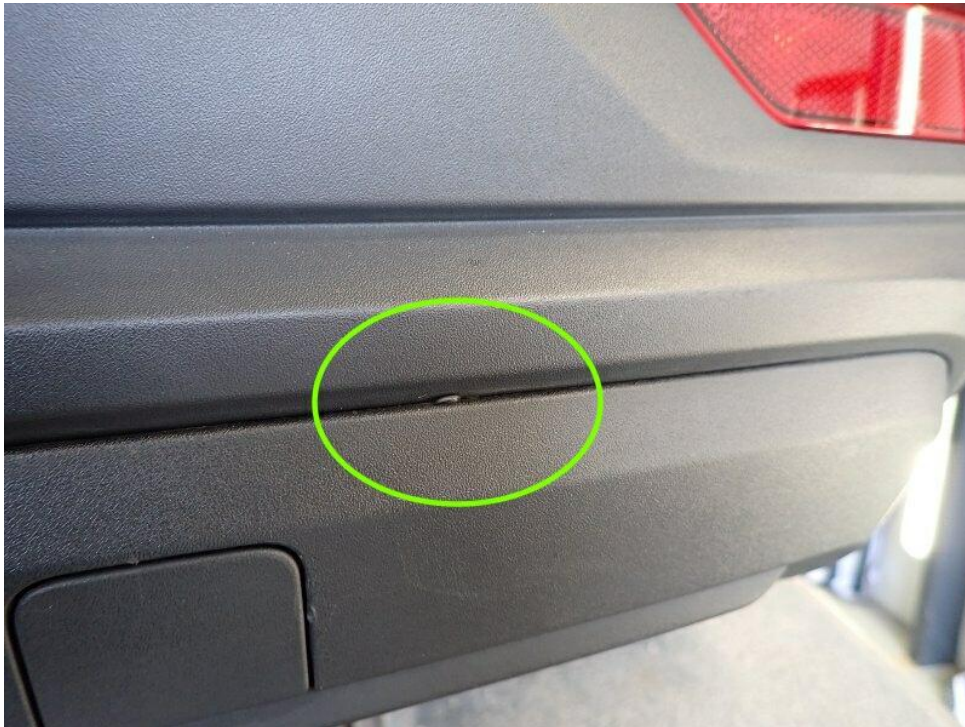
Bild 23 : Restreparaturspuren am Heck sichtbar, Heckklappe, Stoßfänger hinten, Kratzer, Verformungen, silikonkrater und Staubeinschlüsse
