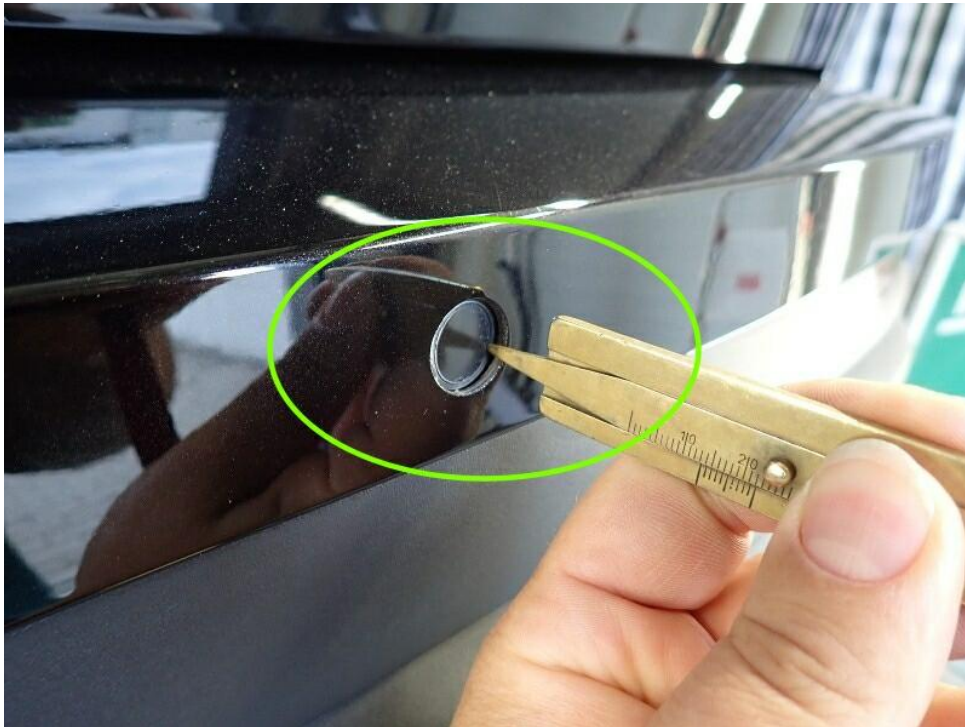
Bild 19 : Restreparaturspuren am Heck sichtbar, Heckklappe, Stoßfänger hinten, Kratzer, Verformungen, silikonkrater und Staubeinschlüsse
