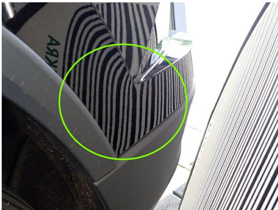
Bild 32 : Restreparaturspuren am Heck sichtbar, Heckklappe, Stoßfänger hinten, Kratzer, Verformungen, silikonkrater und Staubeinschlüsse
