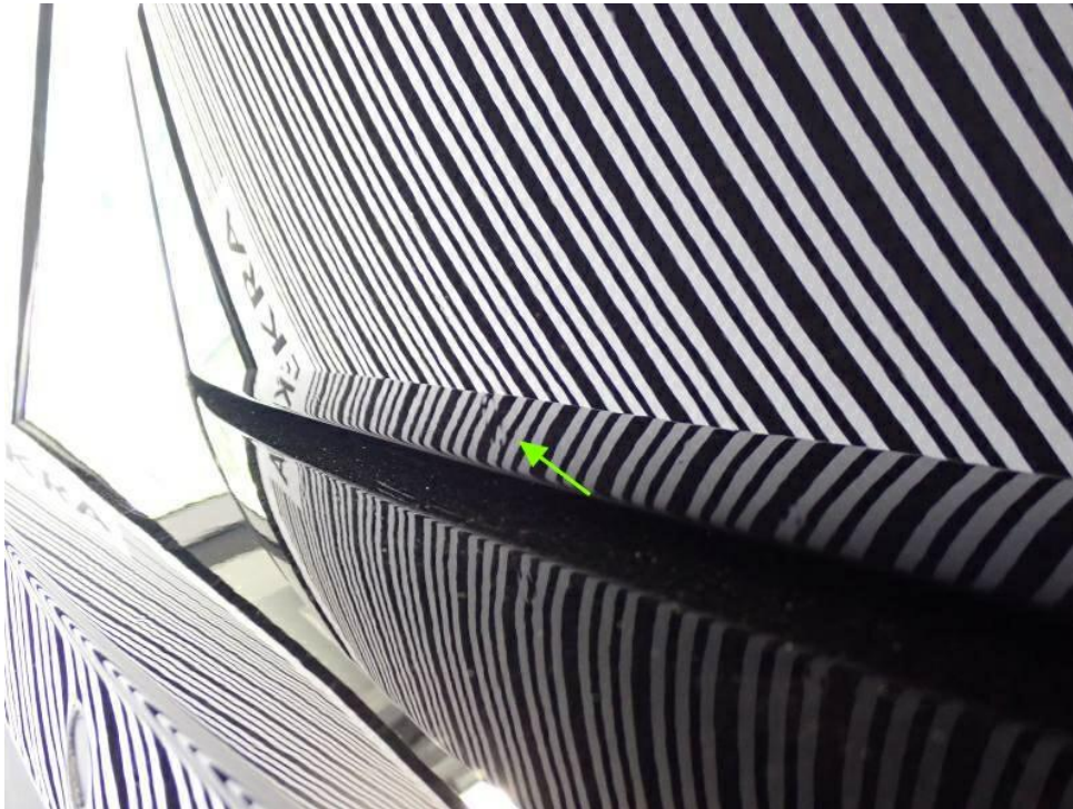
Bild 25 : Restreparaturspuren am Heck sichtbar, Heckklappe, Stoßfänger hinten, Kratzer, Verformungen, silikonkrater und Staubeinschlüsse
