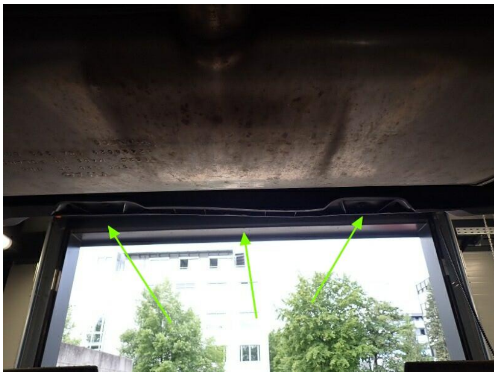
Bild 34 : Restreparaturspuren am Heck sichtbar, Heckklappe, Stoßfänger hinten, Kratzer, Verformungen, silikonkrater und Staubeinschlüsse
