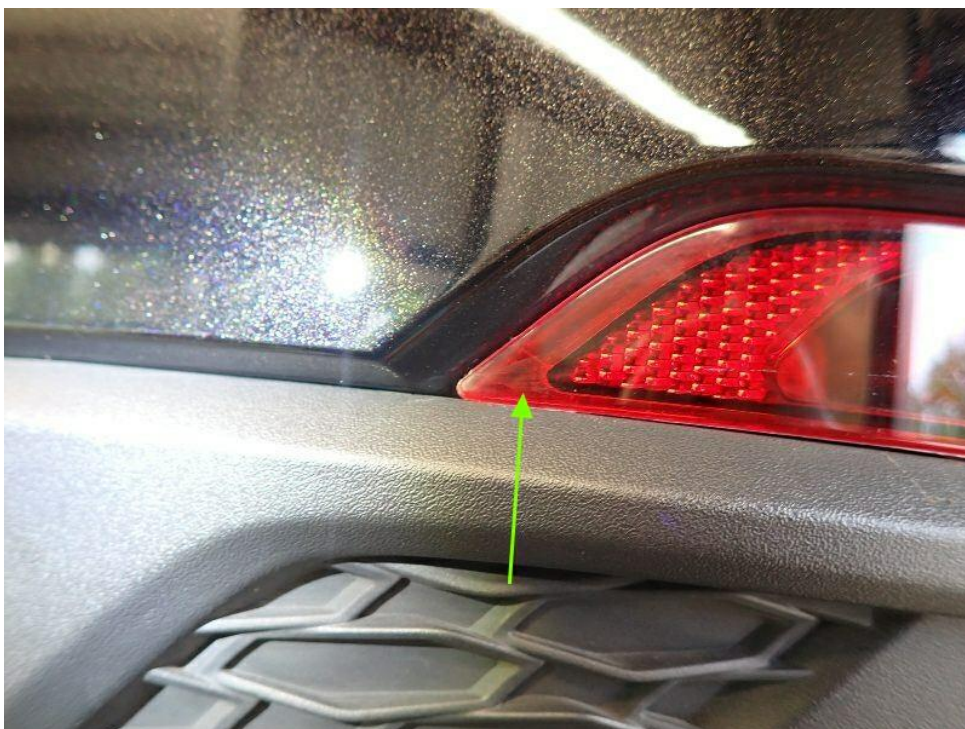
Bild 36 : Restreparaturspuren am Heck sichtbar, Heckklappe, Stoßfänger hinten, Kratzer, Verformungen, silikonkrater und Staubeinschlüsse
