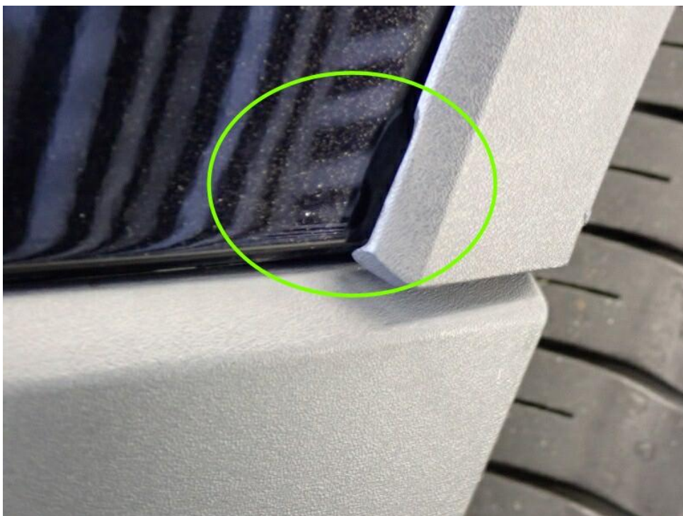
Bild 28 : Restreparaturspuren am Heck sichtbar, Heckklappe, Stoßfänger hinten, Kratzer, Verformungen, silikonkrater und Staubeinschlüsse
