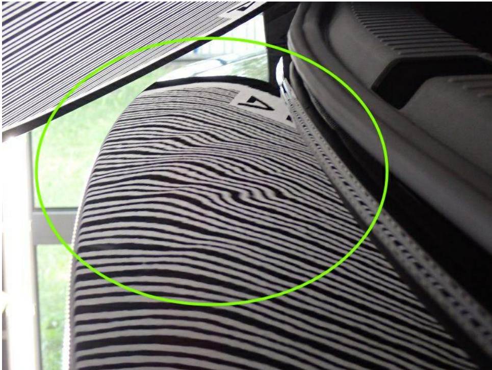
Bild 27 : Restreparaturspuren am Heck sichtbar, Heckklappe, Stoßfänger hinten, Kratzer, Verformungen, silikonkrater und Staubeinschlüsse
