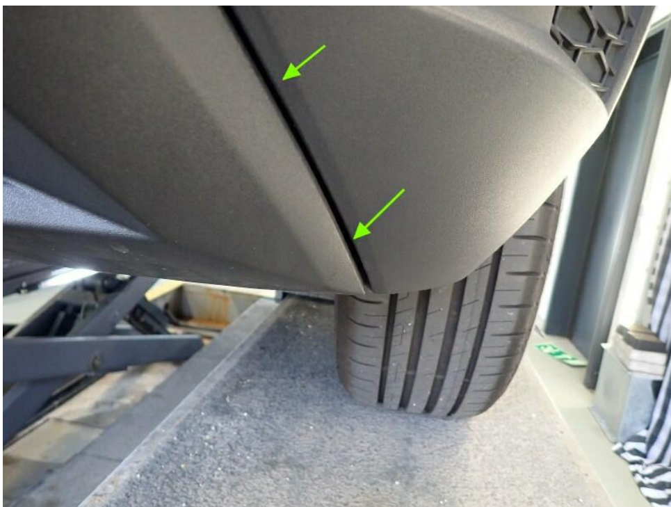
Bild 24 : Restreparaturspuren am Heck sichtbar, Heckklappe, Stoßfänger hinten, Kratzer, Verformungen, silikonkrater und Staubeinschlüsse
