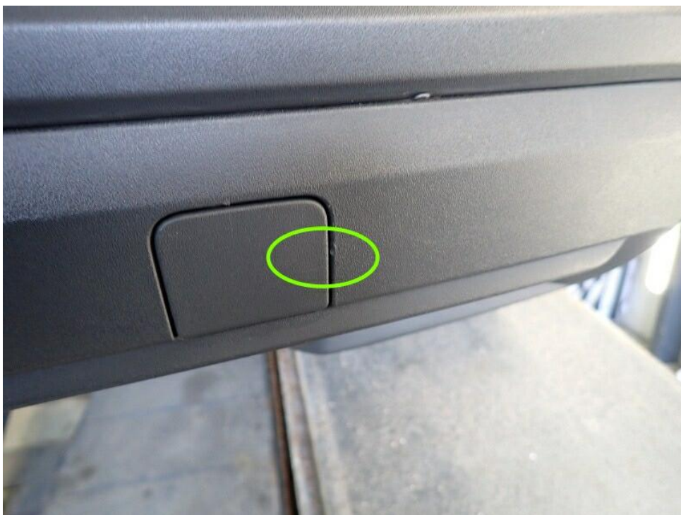
Bild 22 : Restreparaturspuren am Heck sichtbar, Heckklappe, Stoßfänger hinten, Kratzer, Verformungen, silikonkrater und Staubeinschlüsse
