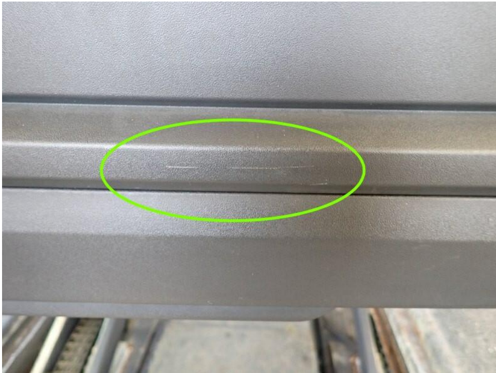
Bild 21 : Restreparaturspuren am Heck sichtbar, Heckklappe, Stoßfänger hinten, Kratzer, Verformungen, silikonkrater und Staubeinschlüsse
