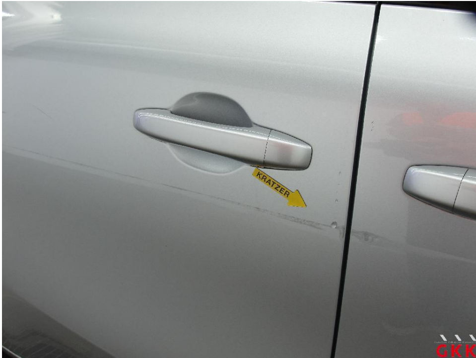
Bild 29. Schiebetür rechts, beschädigt, instand setzen - lackieren
