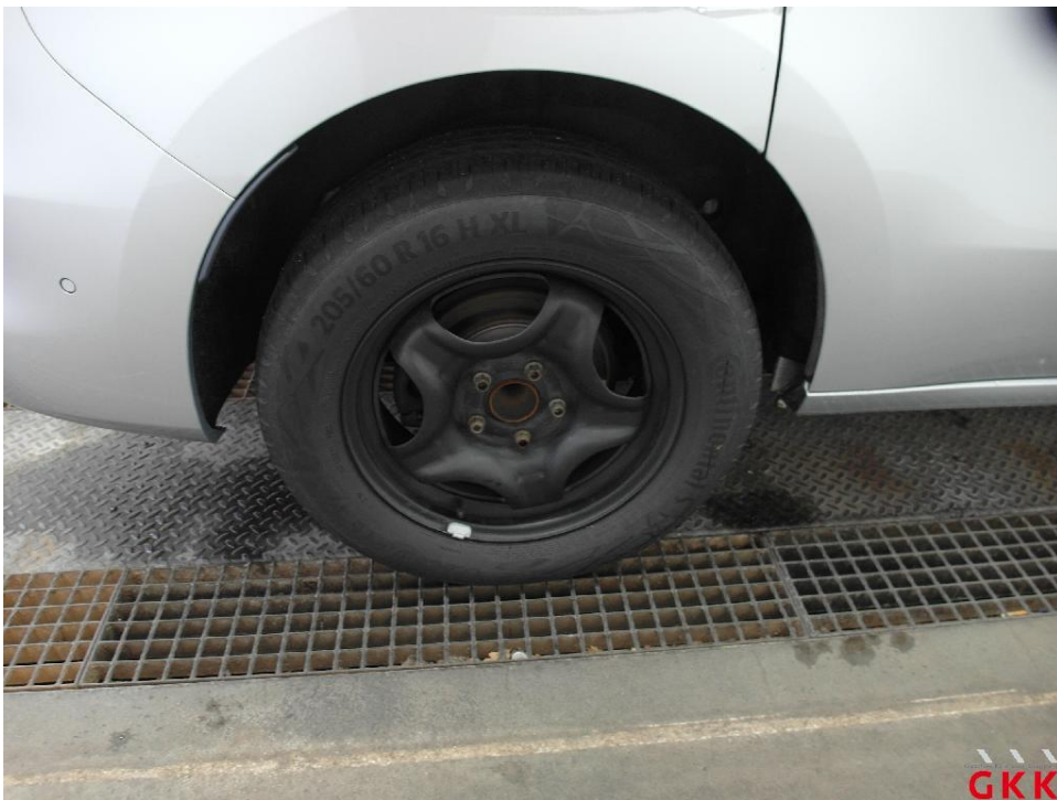
Bild 36. Radkappe(n), Satz, fehlt, ersetzen
