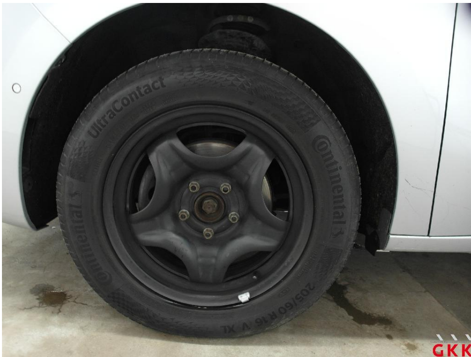
Bild 34. Radkappe(n), Satz, fehlt, ersetzen
