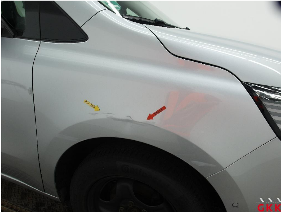
Bild 23. Kotflügel vorne rechts, beschädigt, instand setzen - lackieren
