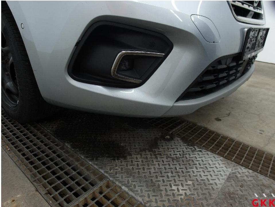
Bild 17. Stoßfänger vorne, Verkleidung -lackiert-, verkratzt, auslegen, schleifen, polieren
