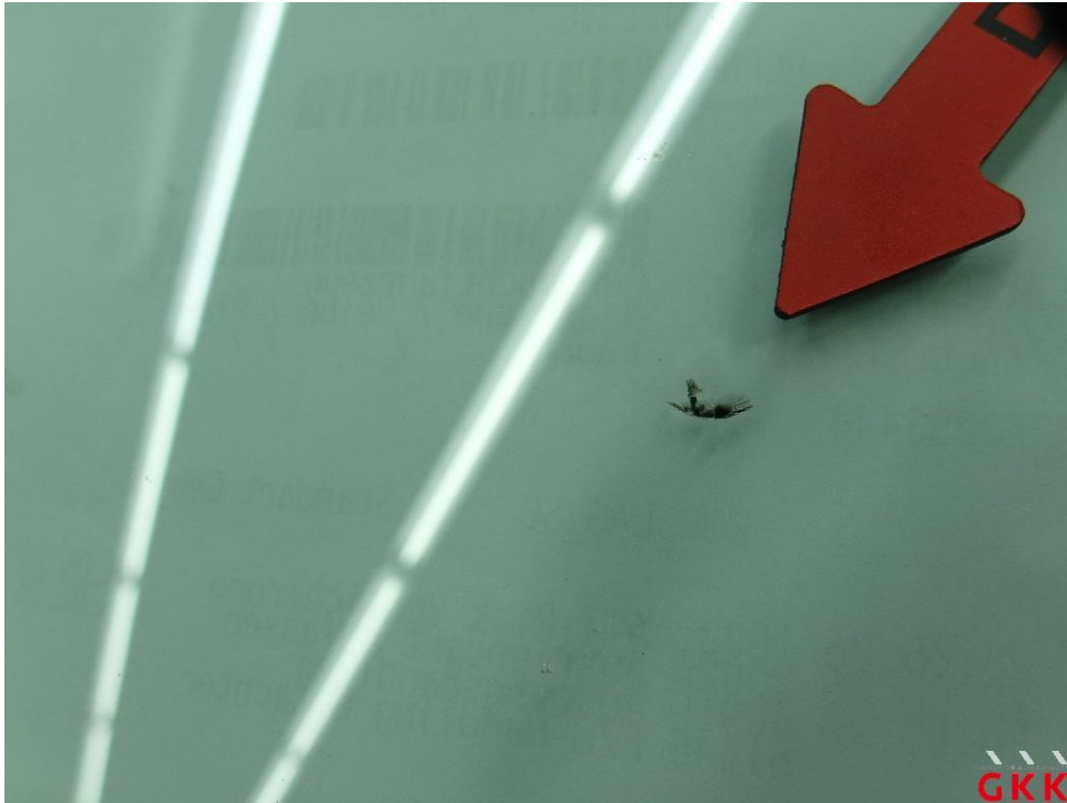
Bild 15. Frontscheibe, wärmedämmend mit Regensensor und Frontkamera, Steinschlag mit Rissbildung, ersetzen
