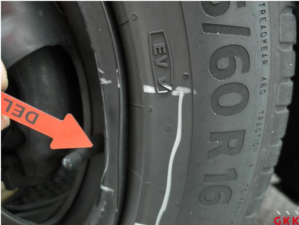
Bild 20. Stahlrad, vorne rechts, beschädigt, ersetzen
