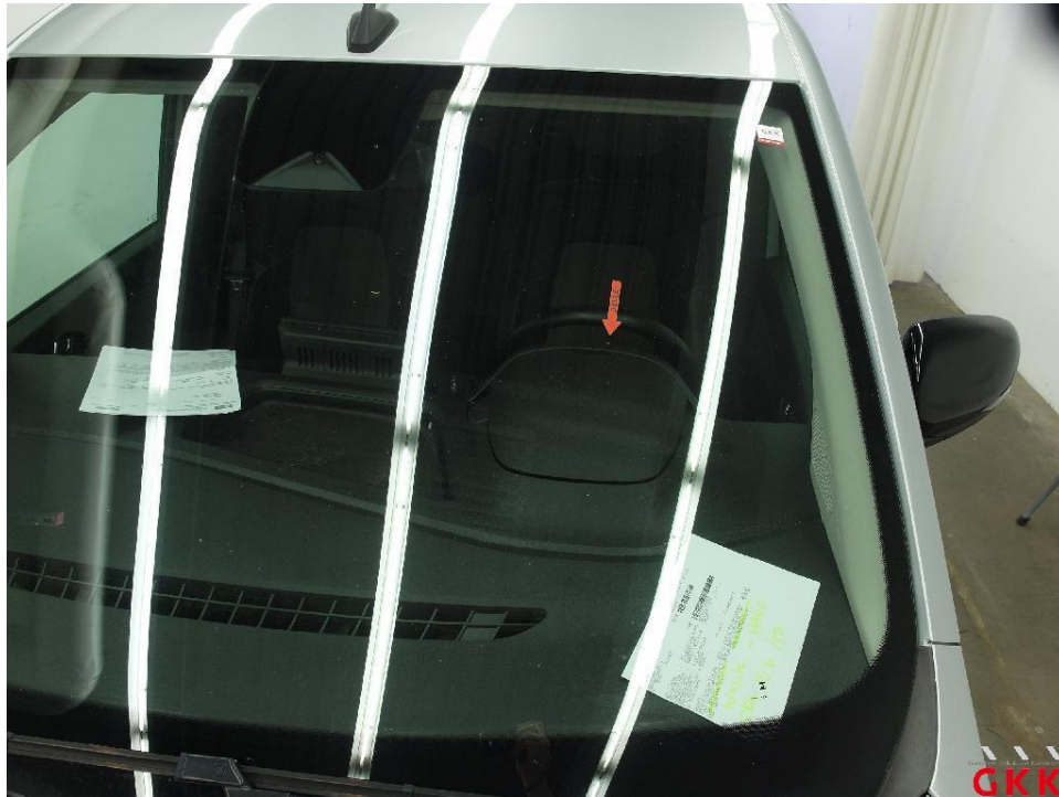
Bild 14. Frontscheibe, wärmedämmend mit Regensensor und Frontkamera, Steinschlag mit Rissbildung, ersetzen
