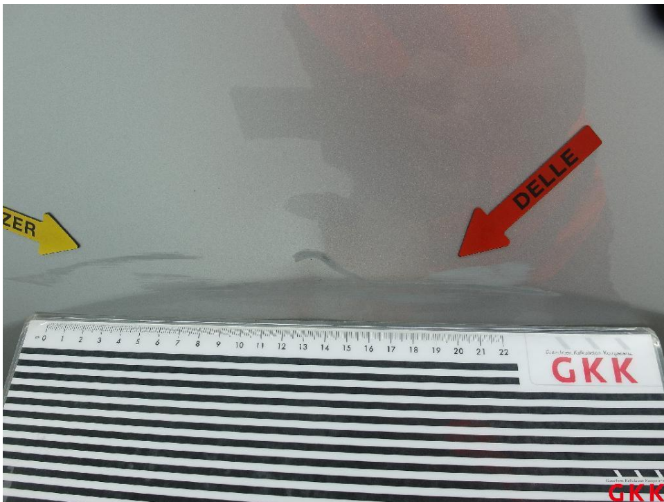
Bild 24. Kotflügel vorne rechts, beschädigt, instand setzen - lackieren
