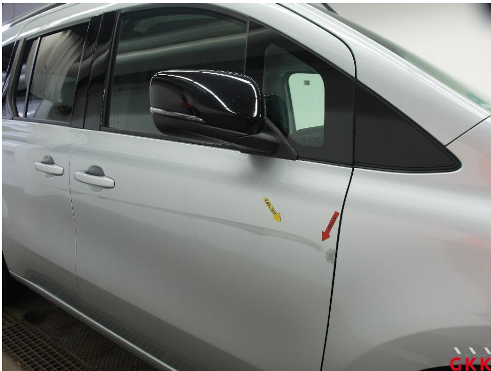
Bild 26. Tür vorne rechts, beschädigt, instand setzen - lackieren
