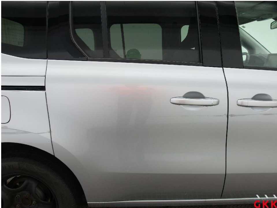
Bild 28. Schiebetür rechts, beschädigt, instand setzen - lackieren
