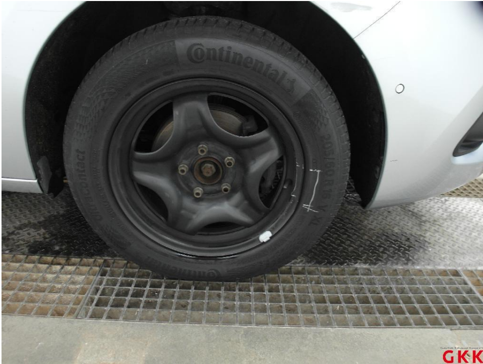
Bild 19. Stahlrad, vorne rechts, beschädigt, ersetzen
