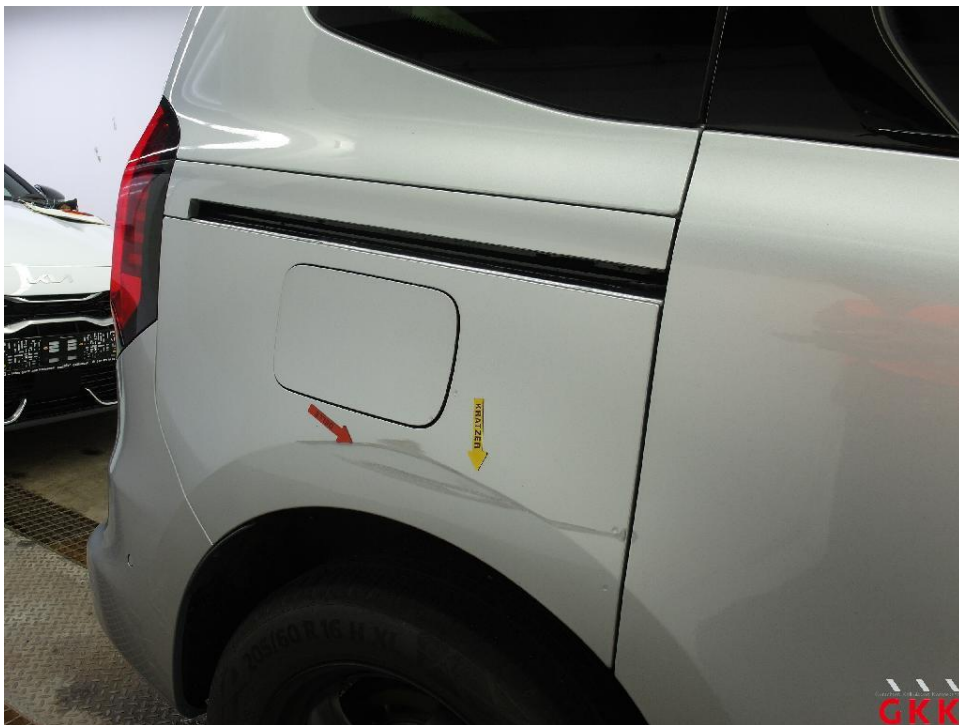
Bild 30. Seitenwand rechts, beschädigt, instand setzen - lackieren
