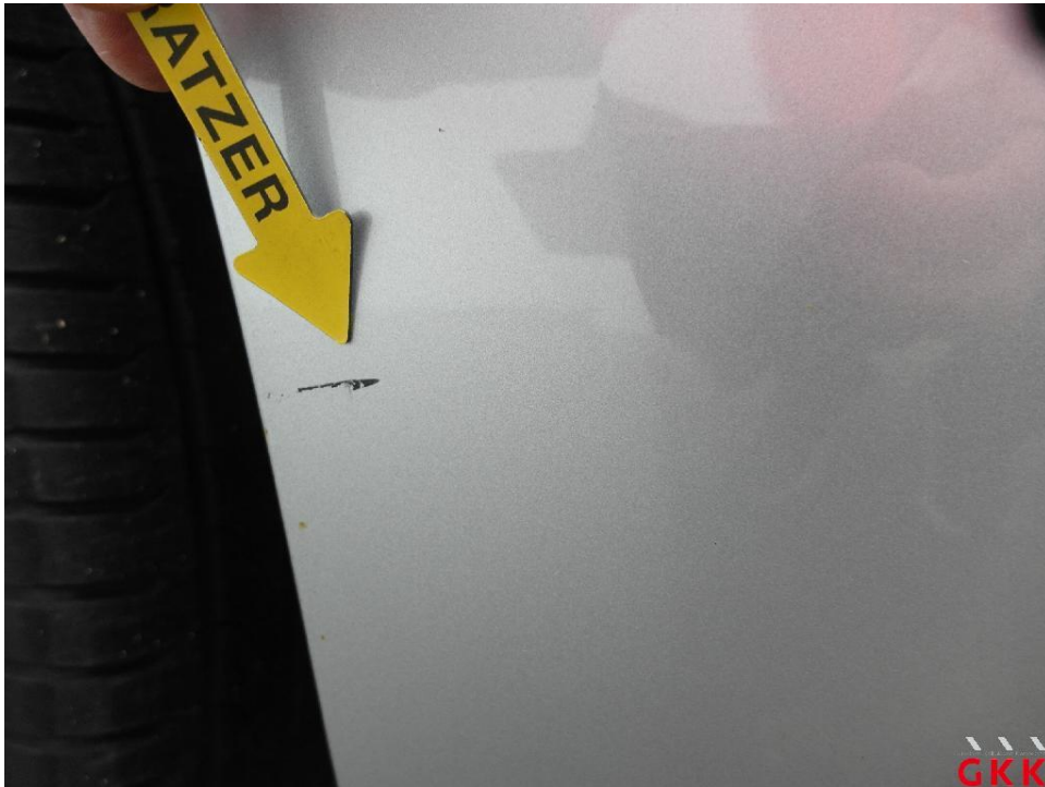
Bild 18. Stoßfänger vorne, Verkleidung -lackiert-, verkratzt, auslegen, schleifen, polieren
