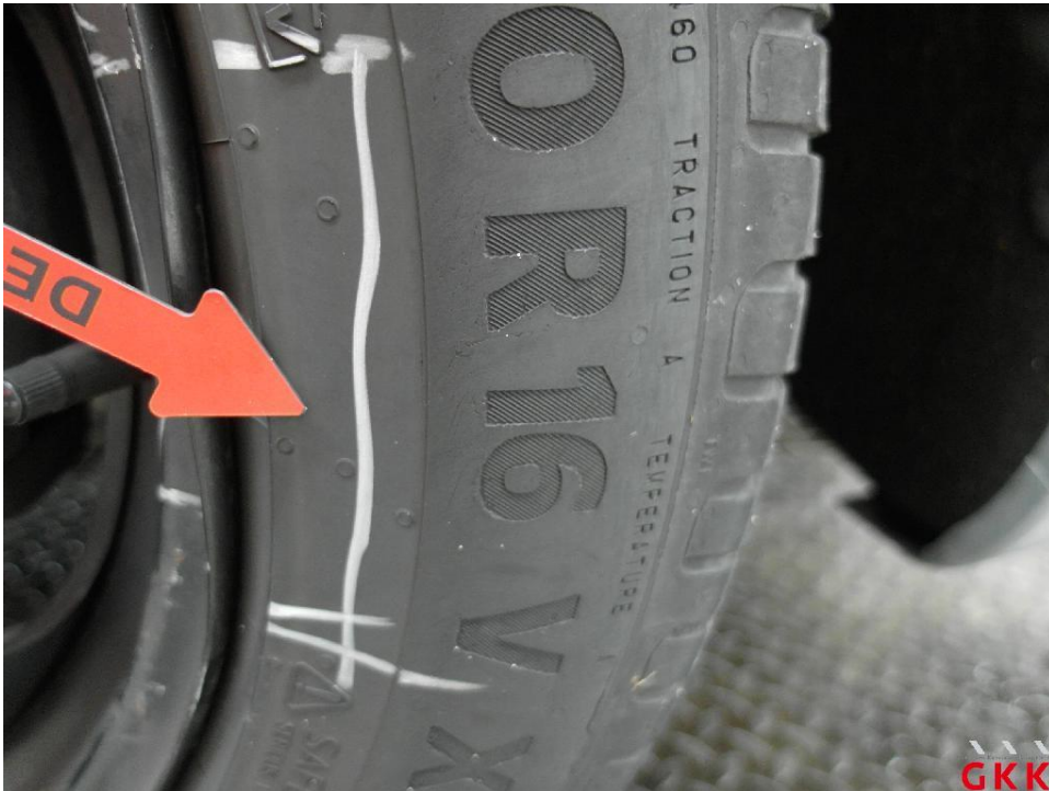
Bild 22. Reifen, vorne rechts, beschädigt, ersetzen
