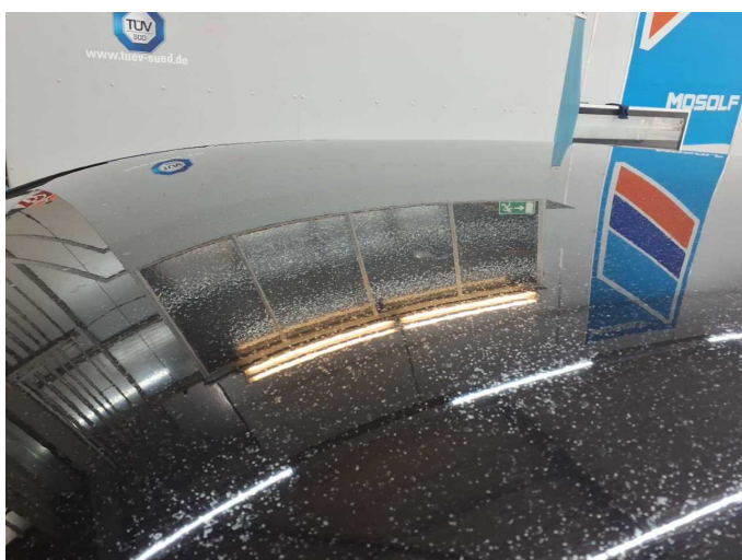
Damage 5: Roof: Roof (Verätzungen) - Paint defect - Paint
