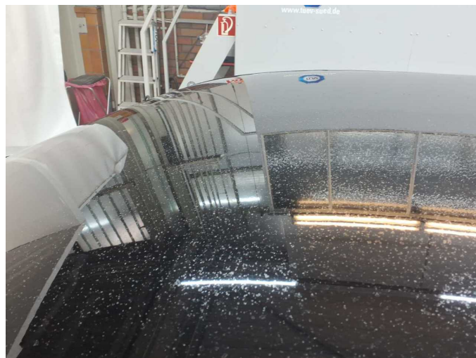
Damage 5: Roof: Roof (Verätzungen) - Paint defect - Paint
