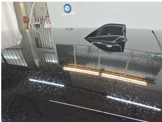
Damage 5: Roof: Roof (Verätzungen) - Paint defect - Paint
