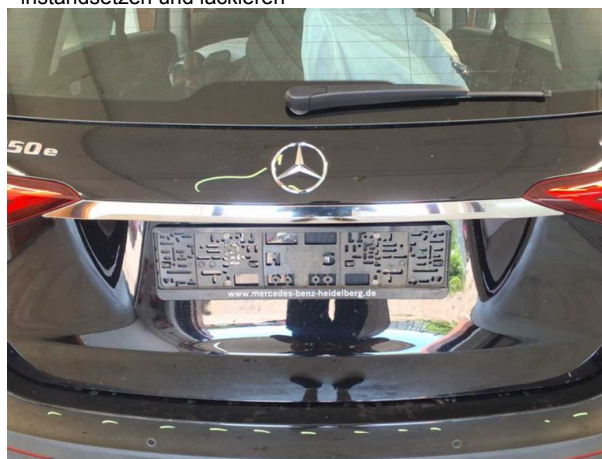
Beschädigung #8: Heckklappe/-tür: Heckklappe - Delle / Lackschaden - instandsetzen und lackieren
