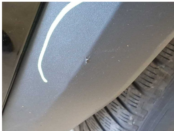
Beschädigung #3: Seitenwand rechts: Radhausverbreiterun... verkratzt / verschürft - Wertminderung
