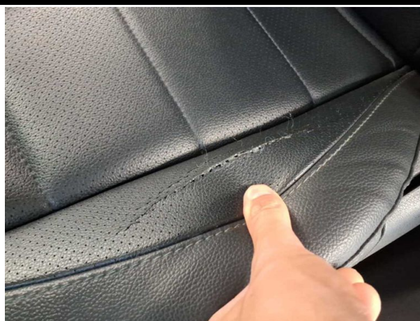
Beschädigung #5: Sitz vorn: Sitzbezug links - beschädigt - erneuern
