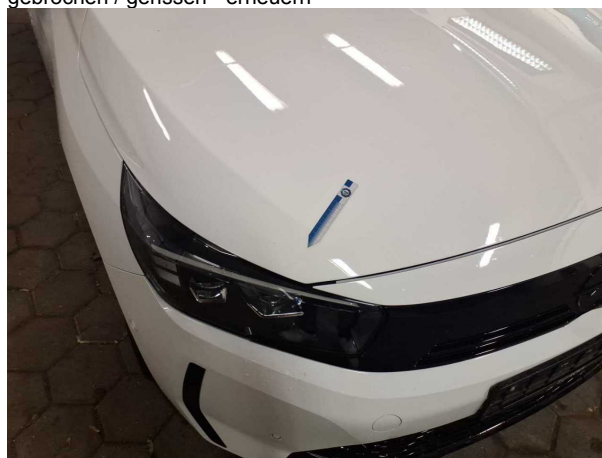
Beschädigung #2: Motorhaube: Motorhaube - Delle(n) - instandsetzen und lackieren
