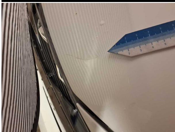
Beschädigung #2: Motorhaube: Motorhaube - Delle(n) - instandsetzen und lackieren
