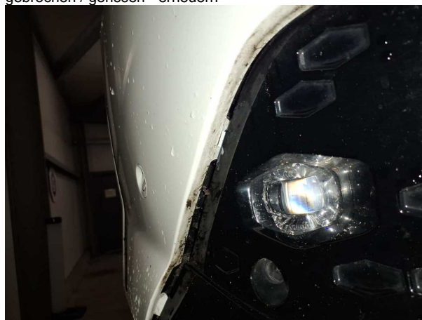
Beschädigung #1: Stossfänger vorn: Stossfänger vorn - gebrochen / gerissen - erneuern
