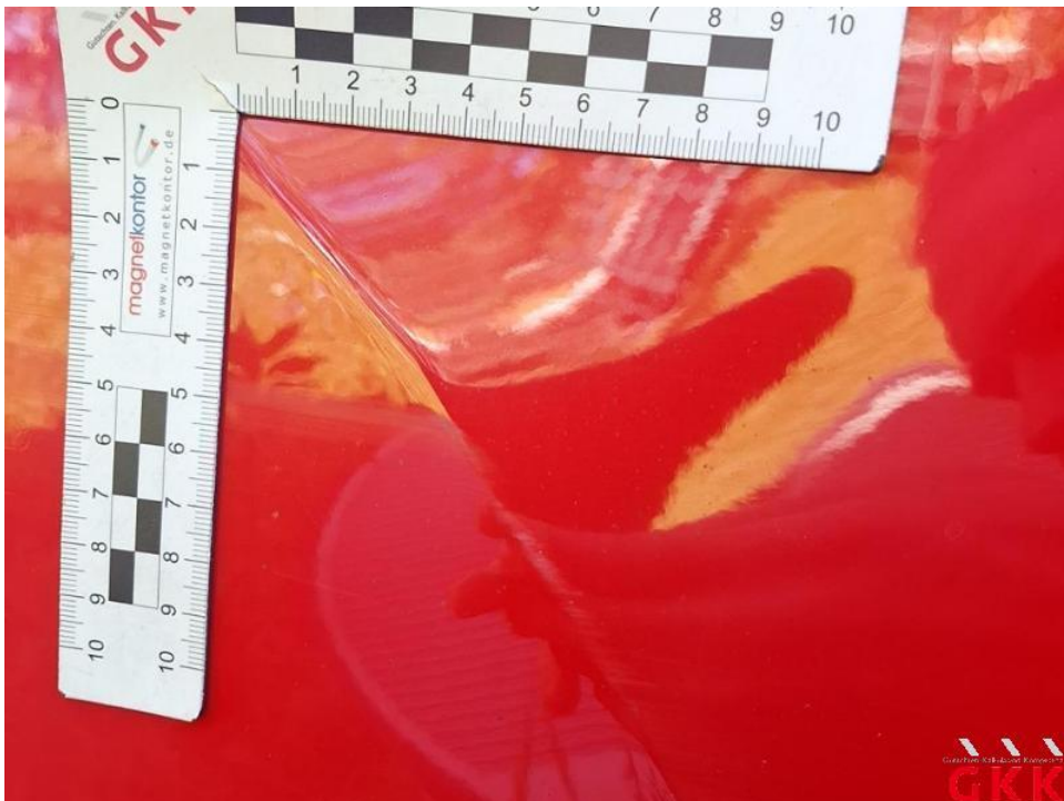
Bild 34. Seitenwand rechts, unterhalb, verkratzt, lackieren
