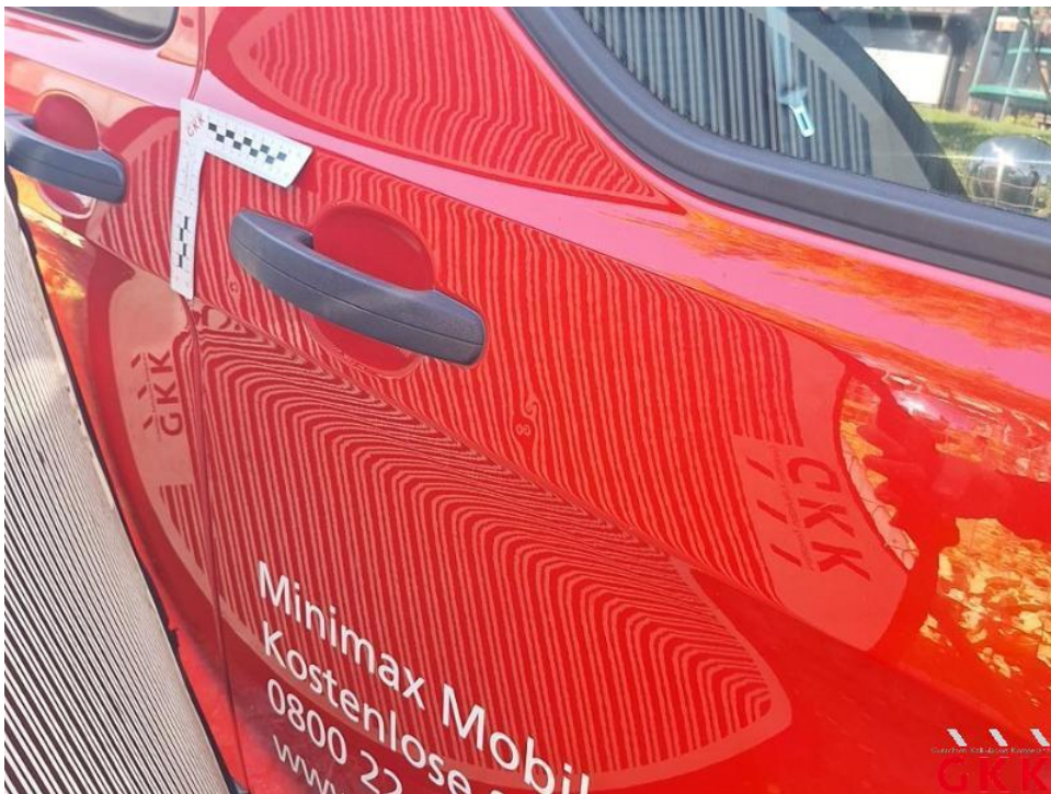
Bild 24. Tür vorne rechts, beschädigt, instand setzen - lackieren
