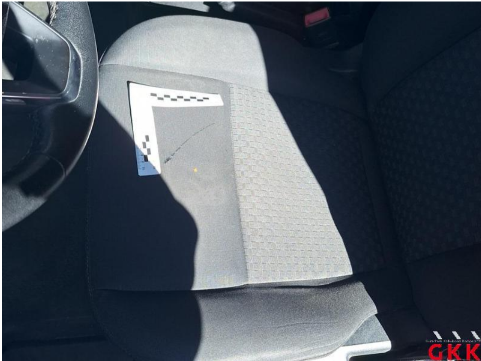
Bild 54. Sitz vorne links, Bezug Sitzkissen -Stoff-, beschädigt, ersetzen
