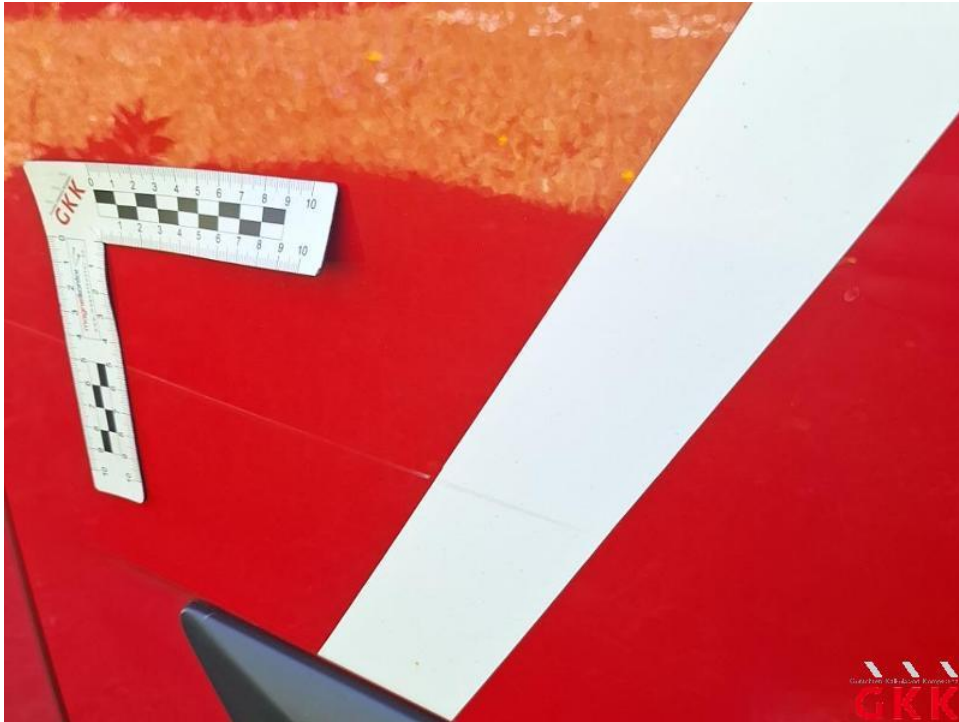
Bild 29. Schiebetür rechts, verkratzt, lackieren
