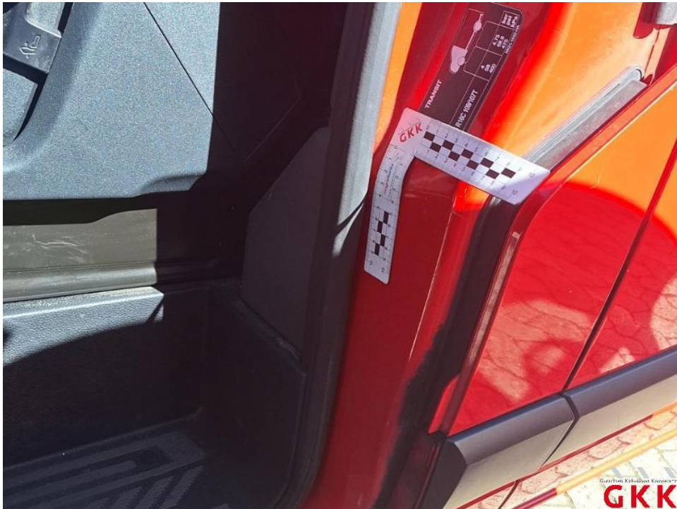
Bild 52. Tür vorne links, Einstieg, verkratzt, lackieren
