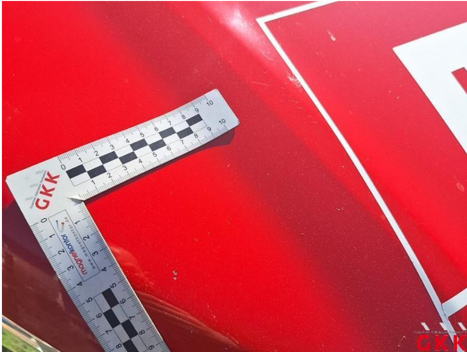
Bild 23. Motorhaube, Steinschlag, lackieren
