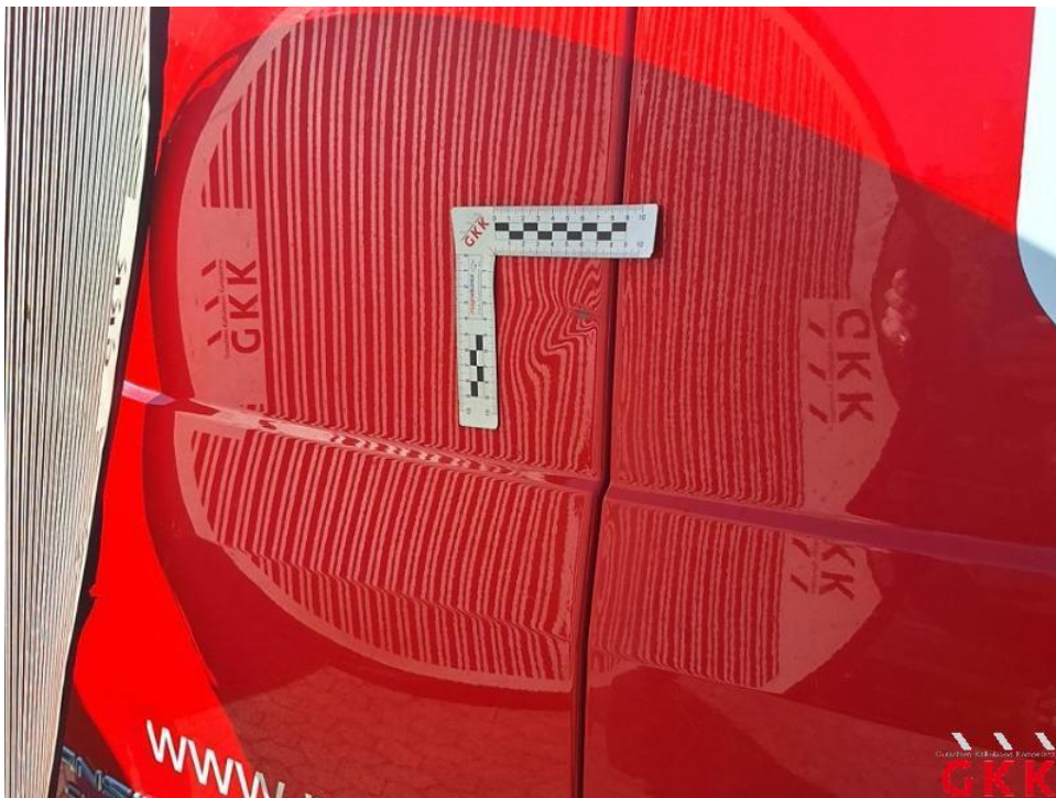
Bild 38. Hecktür links, beschädigt, instand setzen - lackieren
