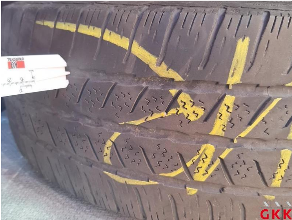
Bild 13. Reifen, 2 x beiliegend, Untermaß, ersetzen
