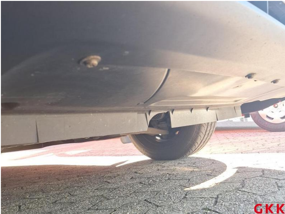
Bild 16. Stoßfänger vorne, Unterfahrschutz, beschädigt, ersetzen
