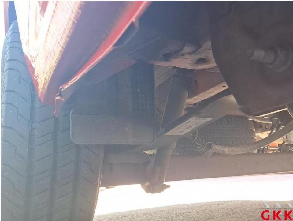
Bild 31. Schweller rechts, hinten, beschädigt, instand setzen - lackieren
