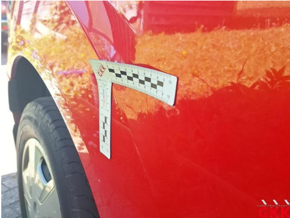
Bild 33. Seitenwand rechts, unterhalb, verkratzt, lackieren
