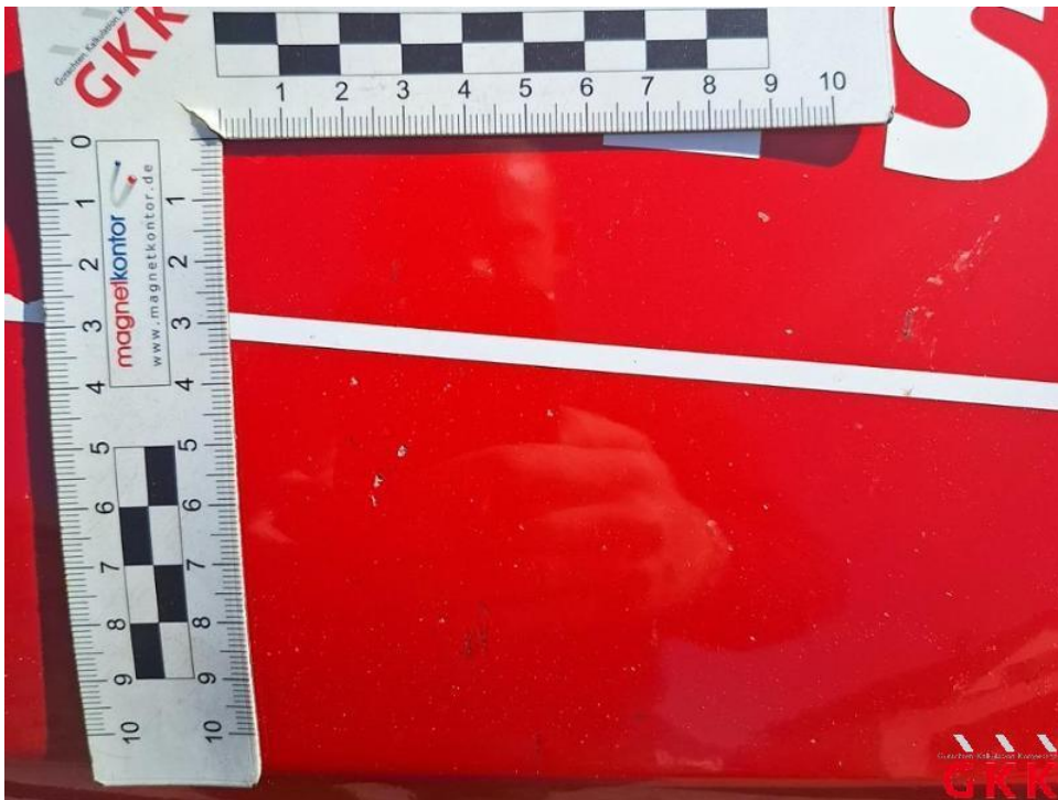
Bild 22. Motorhaube, Steinschlag, lackieren
