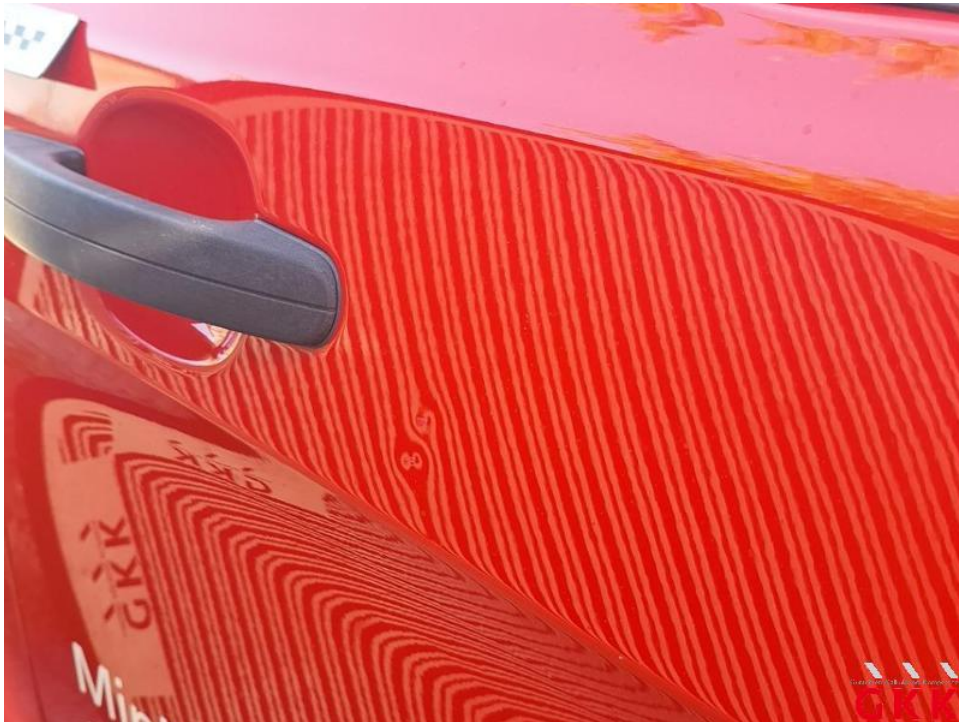
Bild 26. Tür vorne rechts, beschädigt, instand setzen - lackieren
