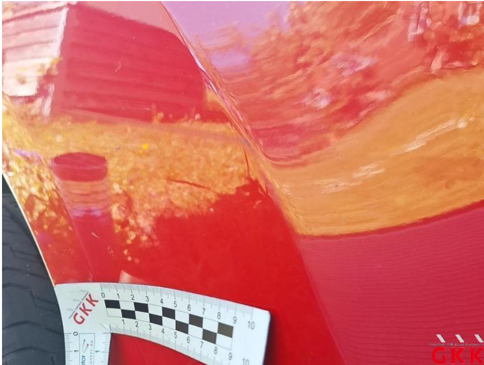
Bild 35. Seitenwand rechts, unterhalb, verkratzt, lackieren
