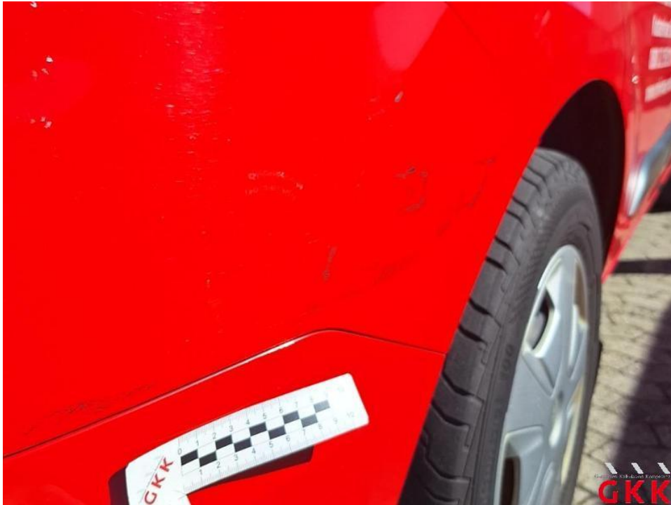
Bild 19. Stoßfänger vorne, Verkleidung oberhalb -lackiert-, verkratzt, lackieren
