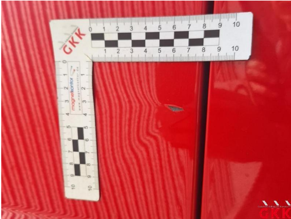
Bild 39. Hecktür links, beschädigt, instand setzen - lackieren
