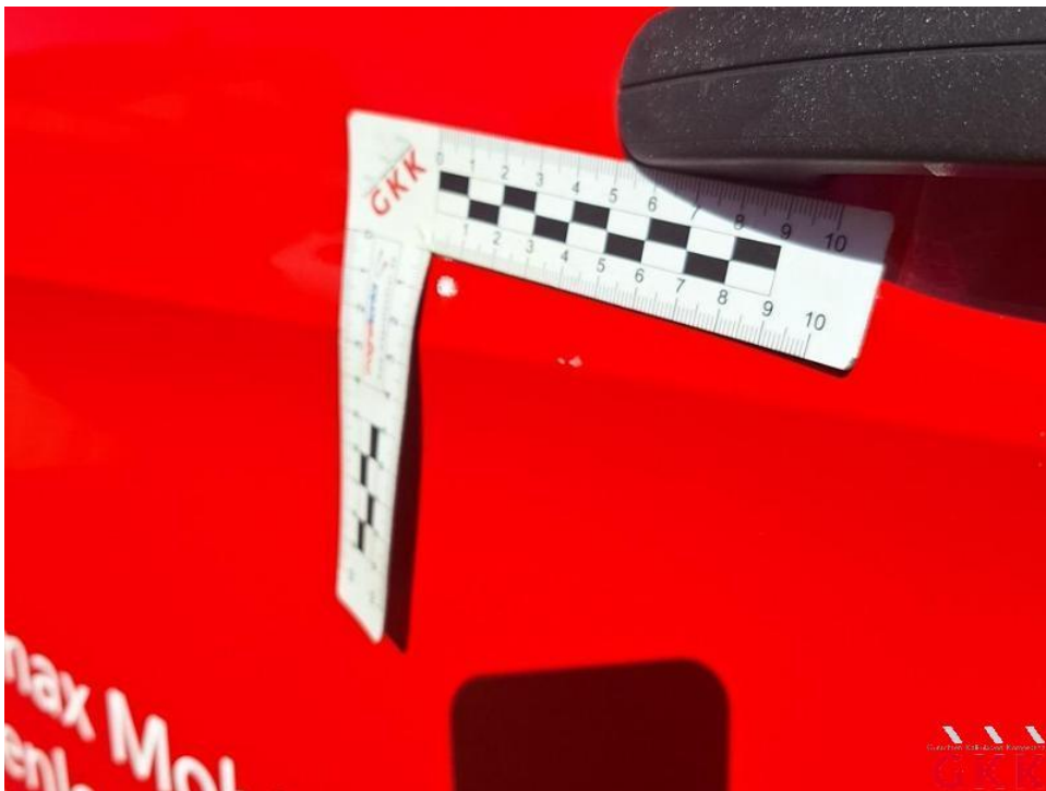
Bild 50. Tür vorne links, verkratzt, lackieren
