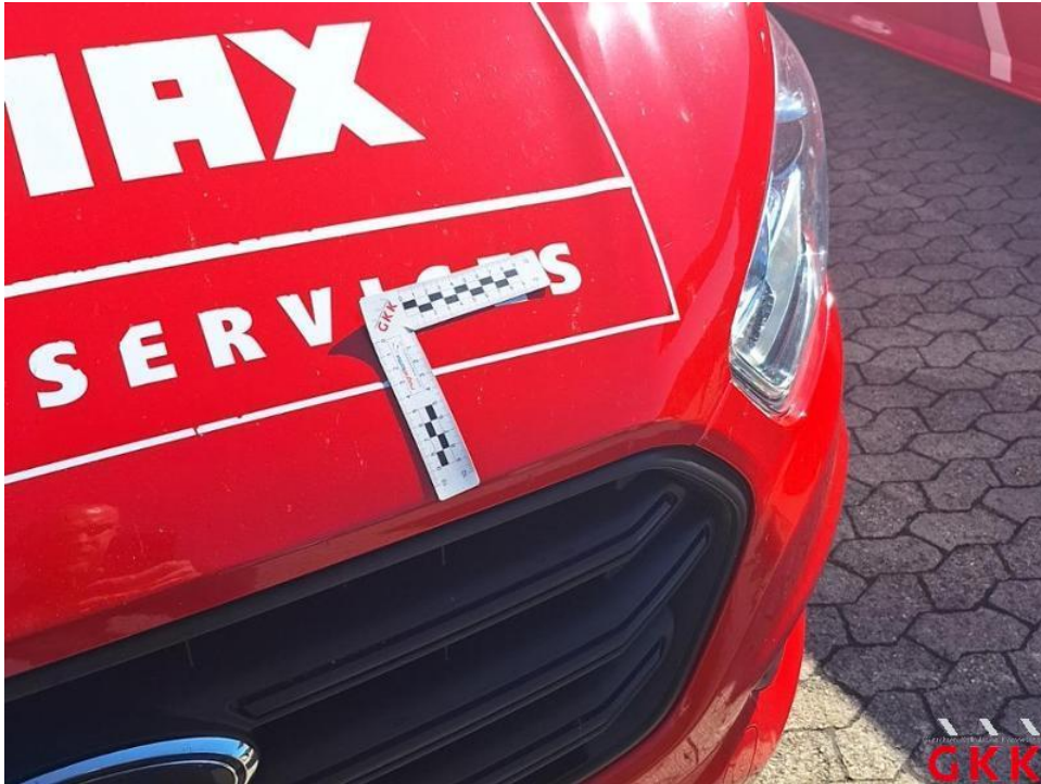
Bild 21. Motorhaube, Steinschlag, lackieren
