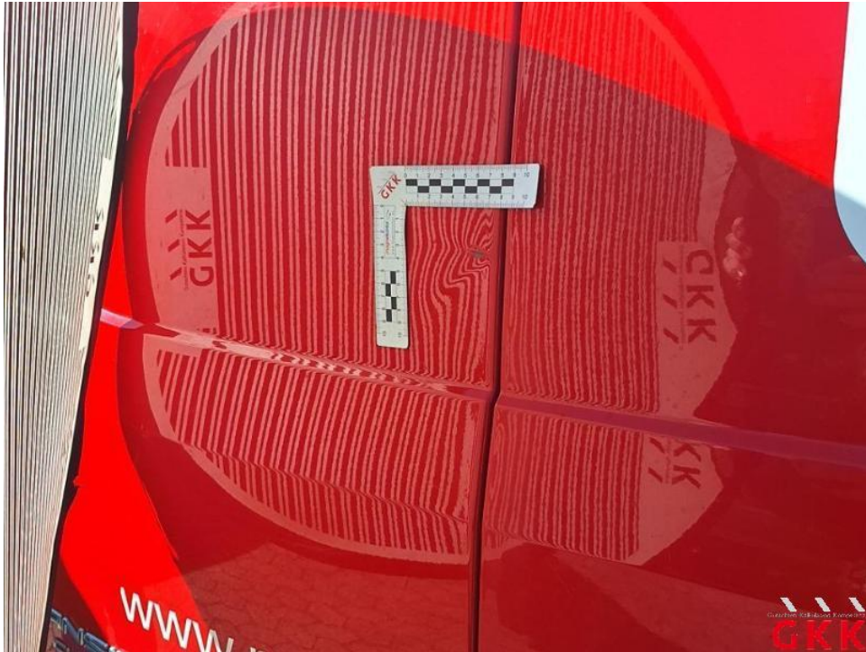
Bild 43. Tür hinten rechts, beschädigt, instand setzen
