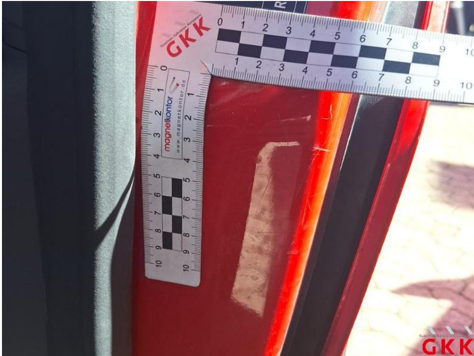
Bild 53. Tür vorne links, Einstieg, verkratzt, lackieren
