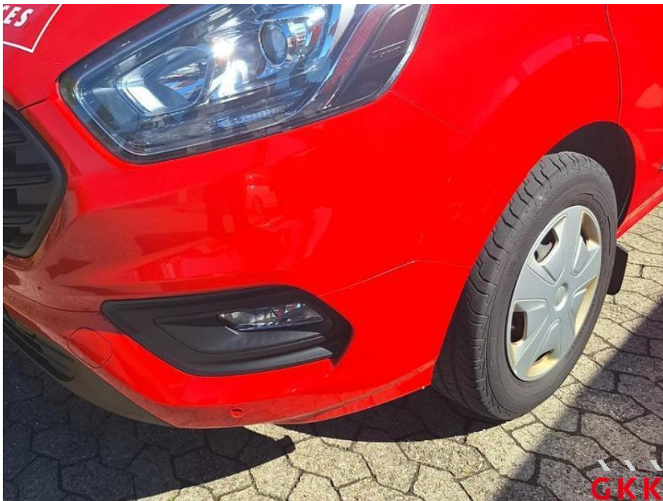
Bild 18. Stoßfänger vorne, Verkleidung oberhalb -lackiert-, verkratzt, lackieren
