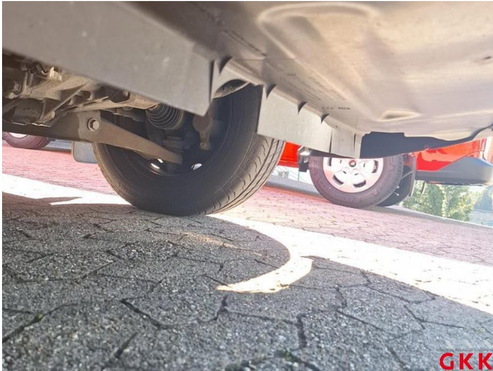
Bild 17. Stoßfänger vorne, Unterfahrschutz, beschädigt, ersetzen
