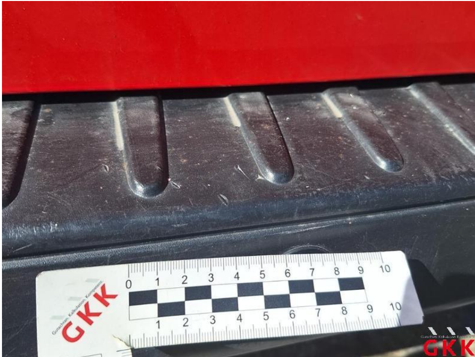
Bild 37. Stoßfänger hinten, Verkleidung -unlackiert-, verkratzt, ersetzen
