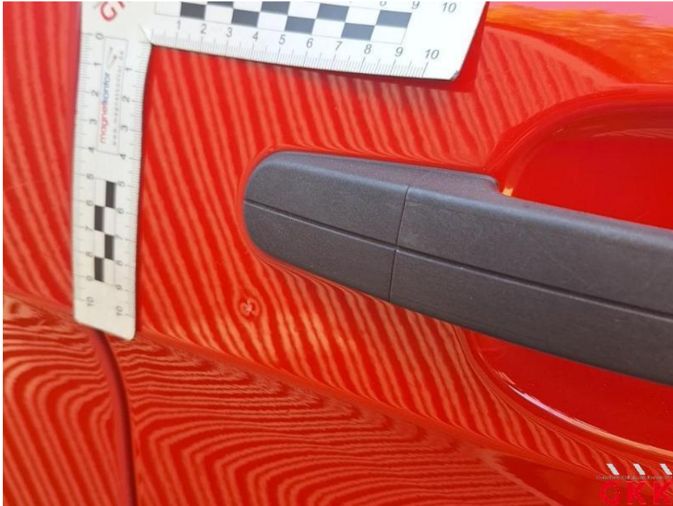
Bild 25. Tür vorne rechts, beschädigt, instand setzen - lackieren
