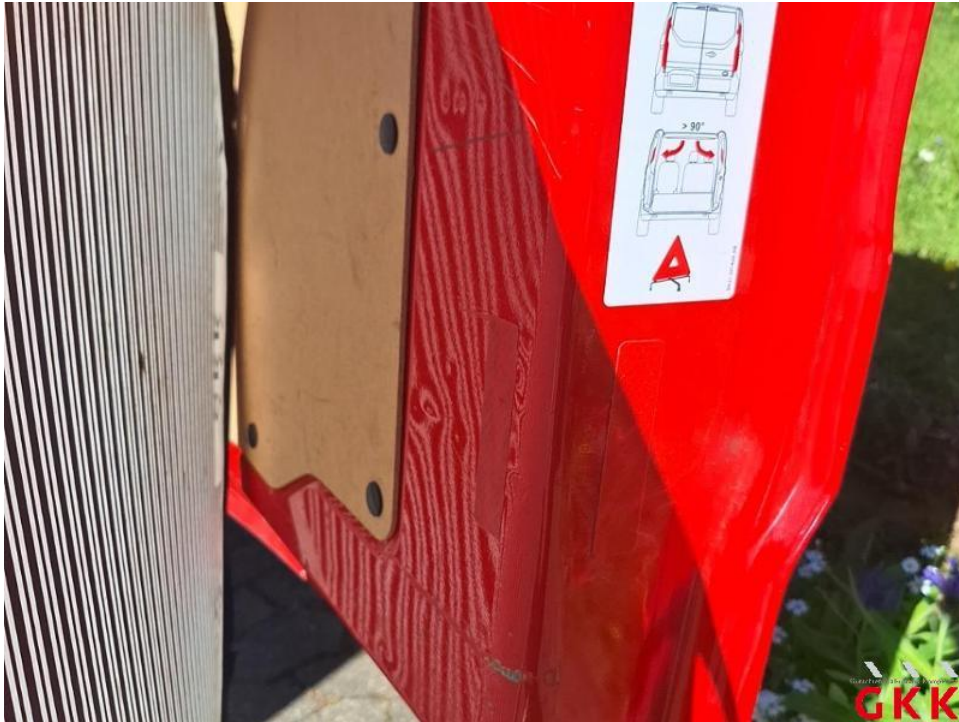
Bild 41. Tür hinten rechts, beschädigt, instand setzen
