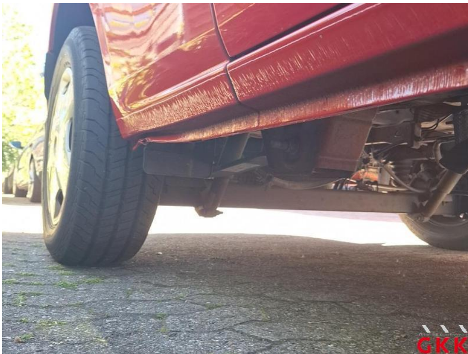
Bild 30. Schweller rechts, hinten, beschädigt, instand setzen - lackieren
