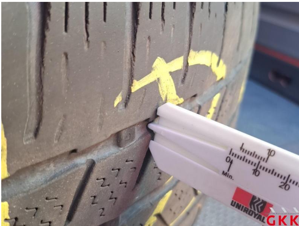
Bild 14. Reifen, 2 x beiliegend, Untermaß, ersetzen
