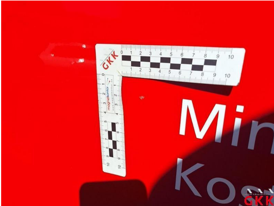
Bild 51. Tür vorne links, verkratzt, lackieren
