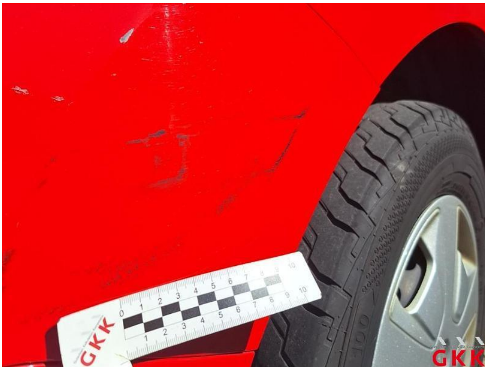
Bild 20. Stoßfänger vorne, Verkleidung oberhalb -lackiert-, verkratzt, lackieren
