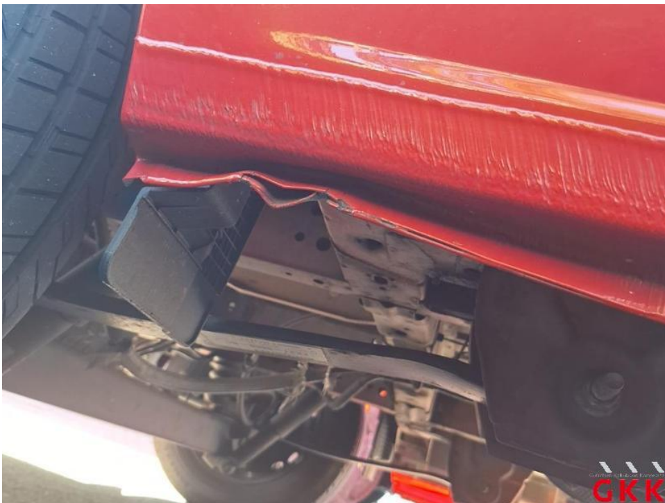
Bild 32. Schweller rechts, hinten, beschädigt, instand setzen - lackieren
