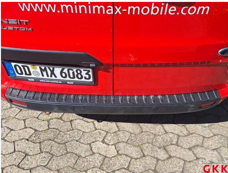
Bild 36. Stoßfänger hinten, Verkleidung -unlackiert-, verkratzt, ersetzen
