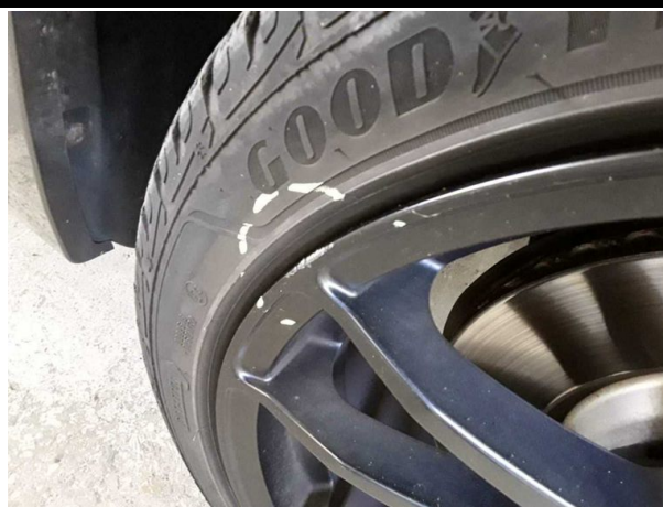
Beschädigung #4: Rad/Reifen: Leichtmetallfelge vorn rechts - verkratzt / verschürft - kein Abzug
