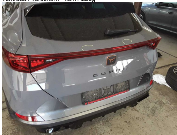
Beschädigung #6: Heckklappe/-tür: Heckklappe - Delle(n) - sanft instandsetzen
