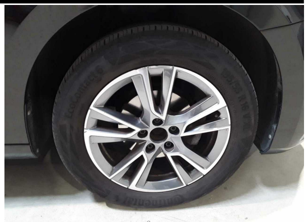
Beschädigung #4: Vorderachse: Radnabe rechts (Radnabenabdeckung) - fehlt - erneuern
