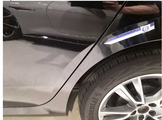
Beschädigung #7: Seitenwand links: Seitenwand - Kratzer - lackieren
