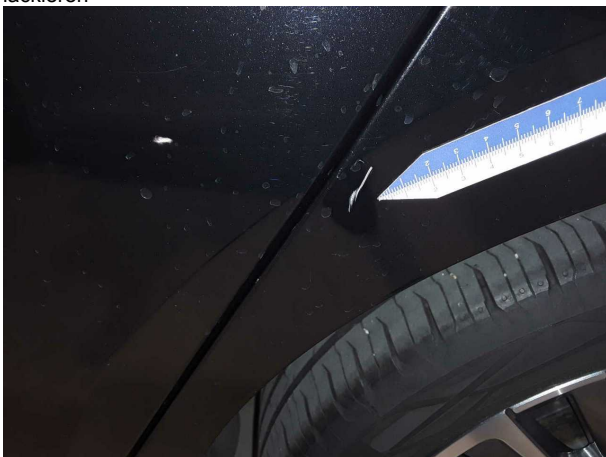
Beschädigung #7: Seitenwand links: Seitenwand - Kratzer - lackieren
