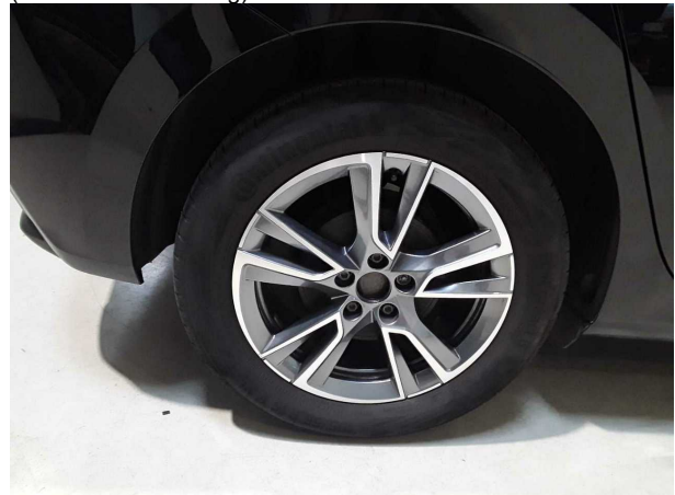
Beschädigung #2: Hinterachse: Radnabe rechts (Radnabenabdeckung) - fehlt - erneuern
