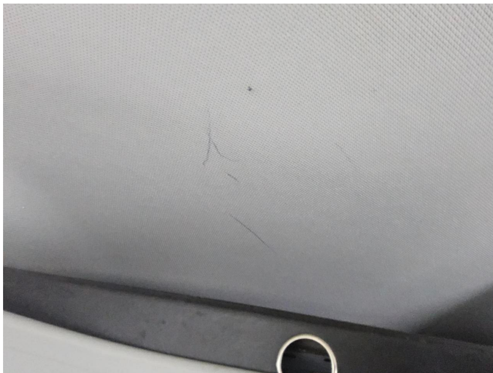
Bild 19 : Dachhimmel, fleckig, reinigen
