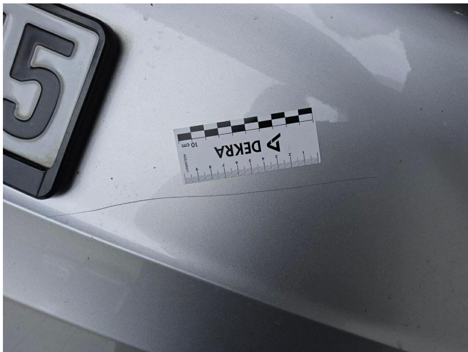
Bild 20 : Heckklappe Lackierung, zerkratzt, smart repair
