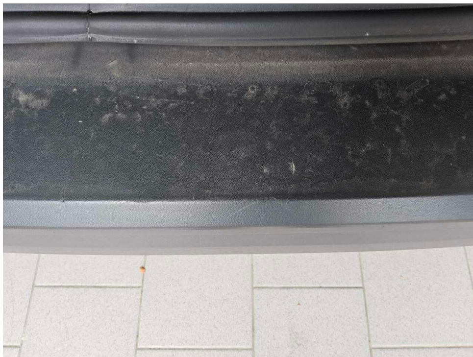
Bild 24 : Stoßfänger hinten, verschrammt, Gebrauchsspur
