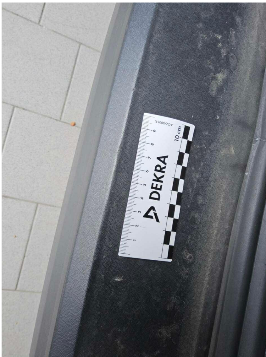
Bild 23 : Stoßfänger hinten, verschrammt, Gebrauchsspur
