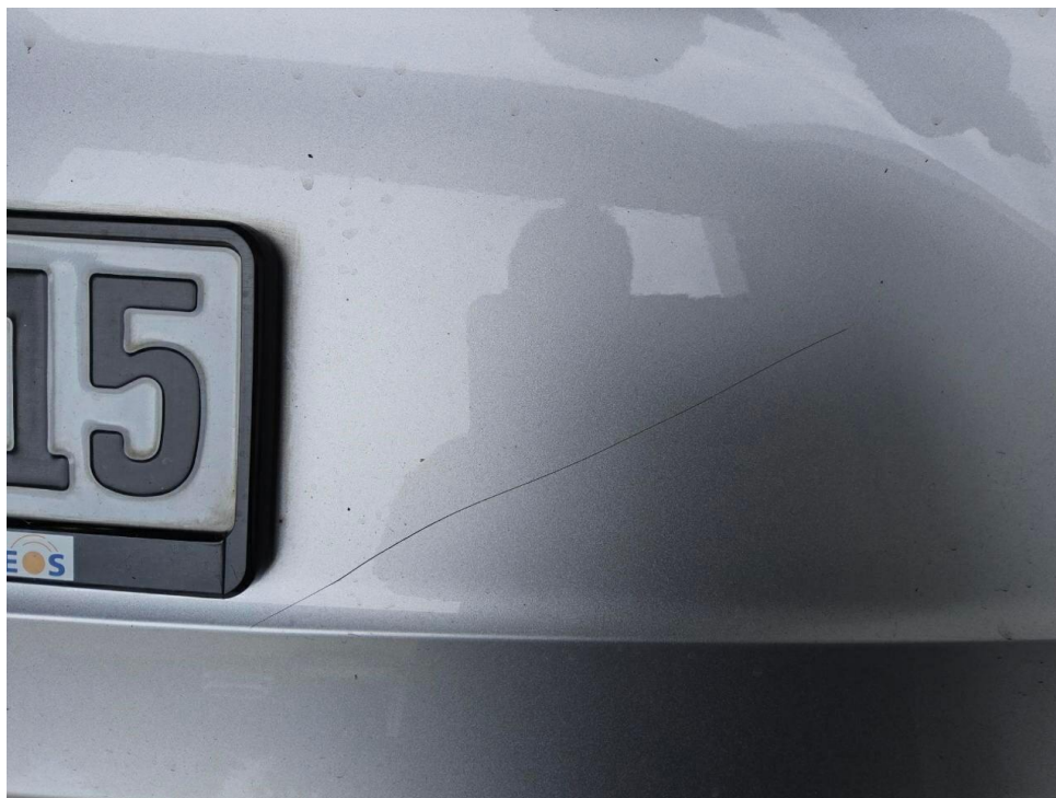
Bild 21 : Heckklappe Lackierung, zerkratzt, smart repair
