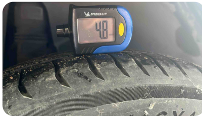
Photo de la mesure de l'usure du pneu arrière gauche
