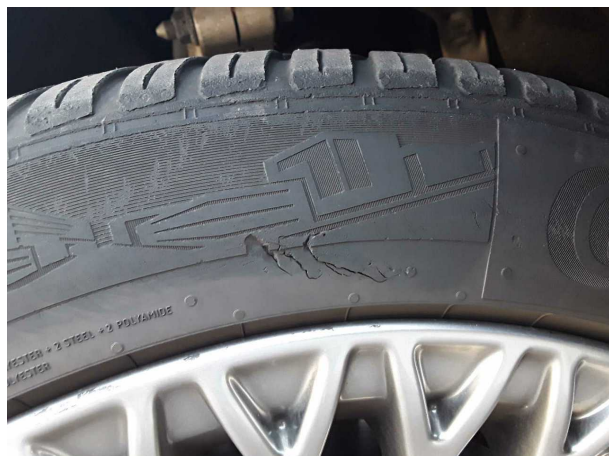
Beschädigung #6: Rad/Reifen: Reifen vorn rechts - beschädigt - erneuern
