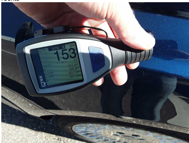
Nachlackierung 1: Dachholm rechts, Kotflügel rechts, Seitenwand rechts
