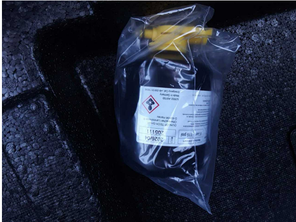
Beschädigung #1: Ausrüstung: Tirefit Füllmittel - abgelaufen - erneuern
