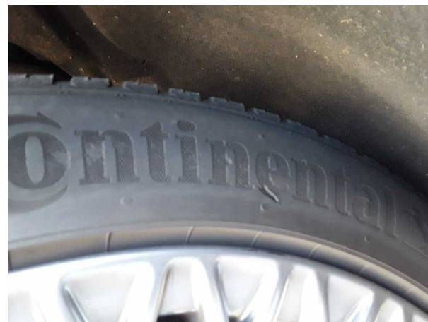
Beschädigung #6: Rad/Reifen: Reifen vorn rechts - beschädigt - erneuern
