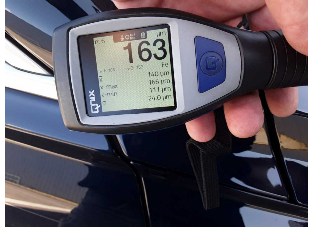
Nachlackierung 1: Dachholm rechts, Kotflügel rechts, Seitenwand rechts
