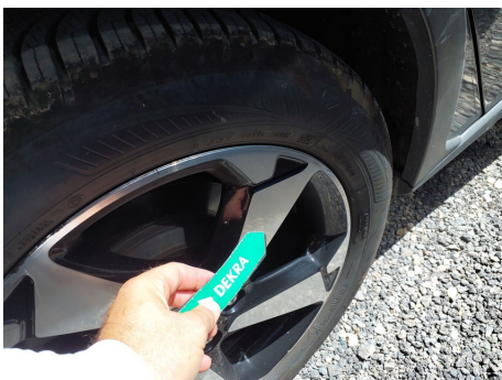
Llanta / Trasero Derecho / Ralladura
