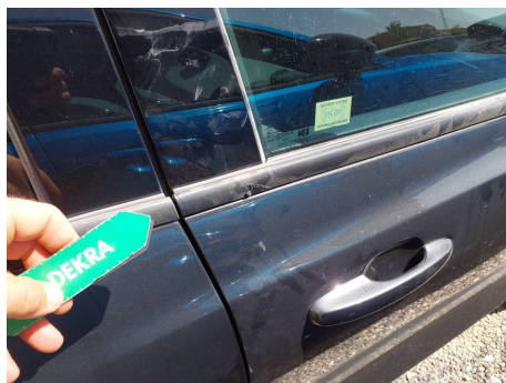
Lamelunas / Delantero Derecho / Roto
