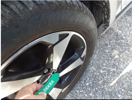
Llanta / Delantero Izquierdo / Ralladura
