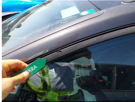
Lamelunas / Delantero Izquierdo / Roto
