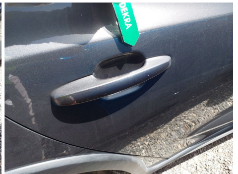
Manetas de puerta / Trasero Derecho / Ralladura
