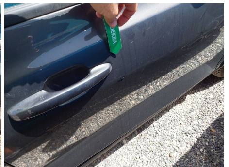
Puerta / Delantero Derecho / Ralladura
