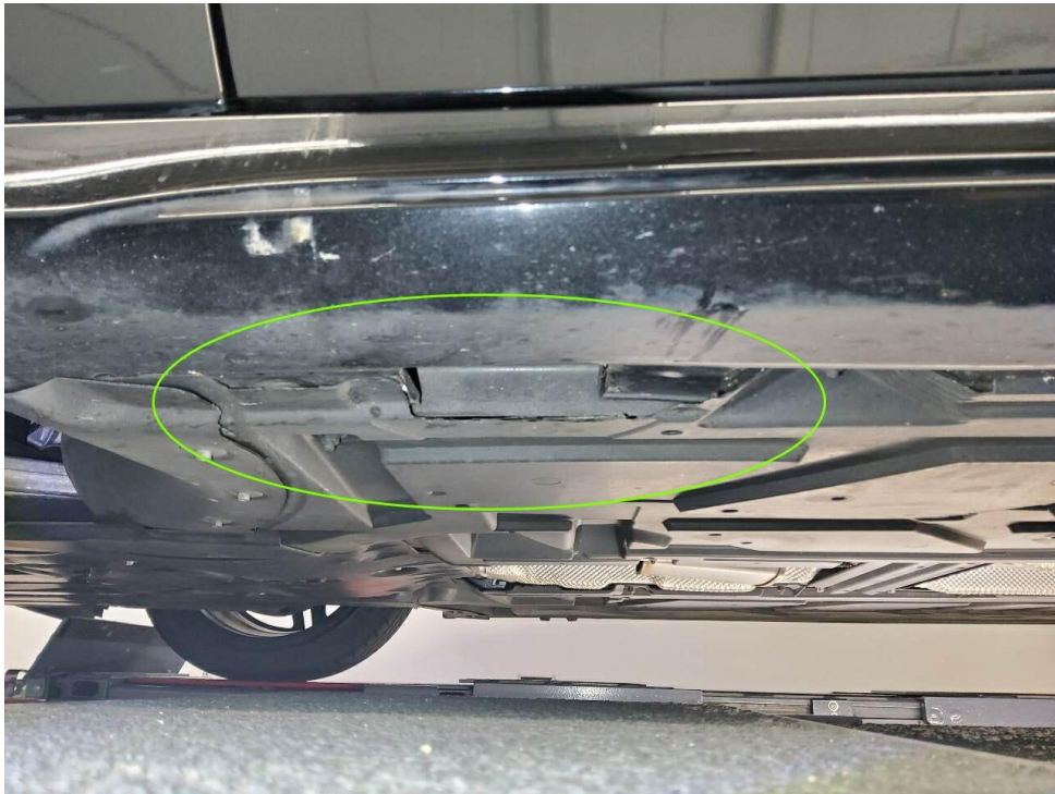
Bild 25 : Aufnahme Hebebühne vorne links fehlt und Unterfahrschutz links vorne gebrochen
