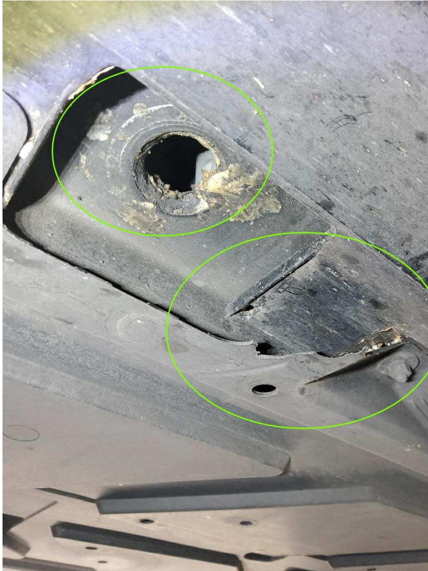
Bild 26 : Aufnahme Hebebühne vorne links fehlt und Unterfahrschutz links vorne gebrochen
