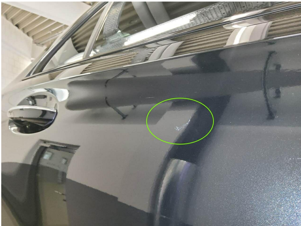
Bild 20 : Tür hinten rechts eingedellt mit Lackbeschädigung
