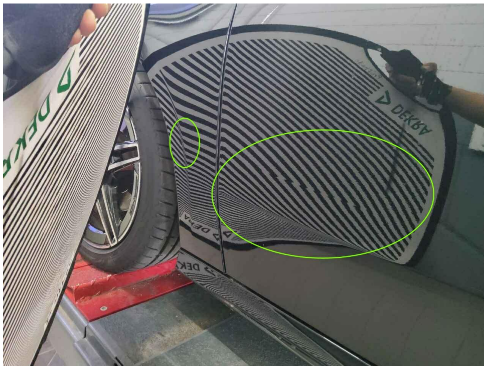
Bild 14 : Kotflügel vorne links und Tür vorne links verschrammt und eingedellt
