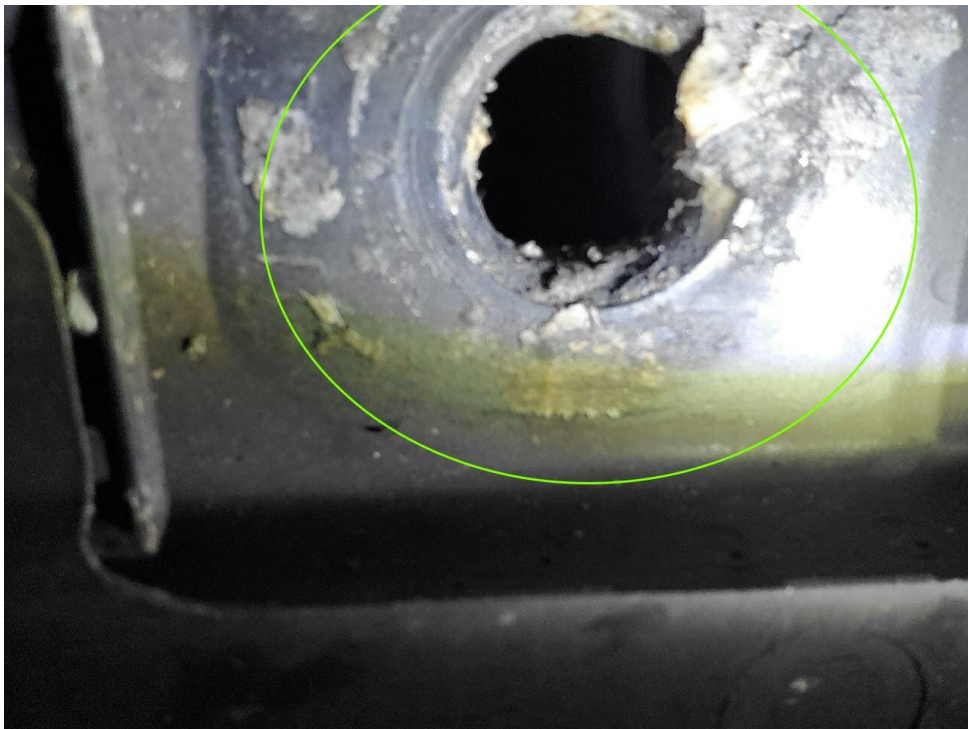
Bild 24 : Aufnahme Hebebühne vorne links fehlt und Unterfahrschutz links vorne gebrochen
