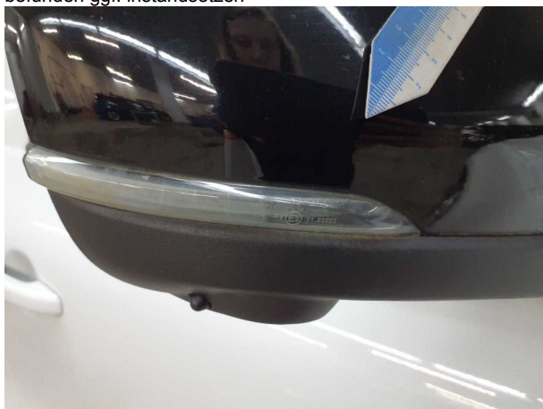
Beschädigung #2: Blinkleuchte: Spiegel rechts - undicht - erneuern
