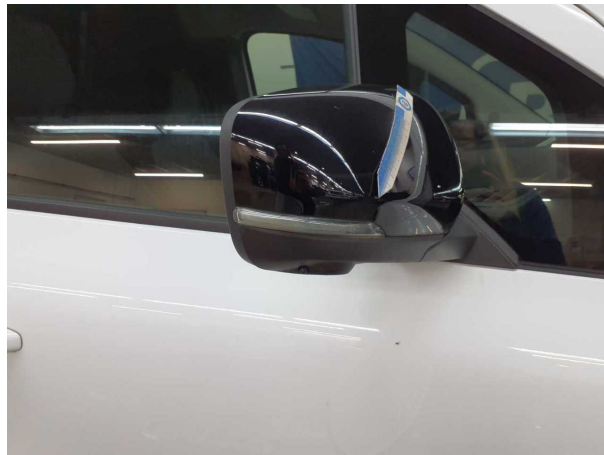
Beschädigung #2: Blinkleuchte: Spiegel rechts - undicht - erneuern
