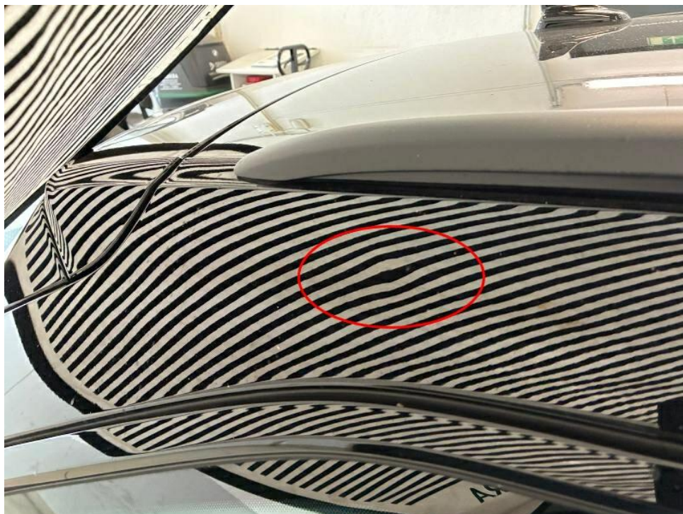
Bild 15 : Dachrahmen rechts Delle
