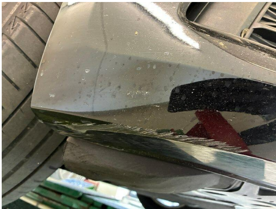
Bild 19 : Stoßfänger vorne Kratzer + Steinschlag
