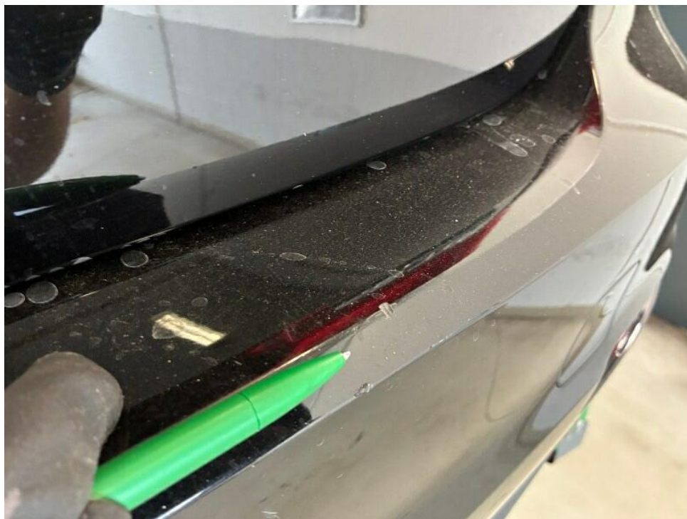
Bild 24 : Stoßfänger hinten + Deko Kratzer + Delle + Beschädigung
