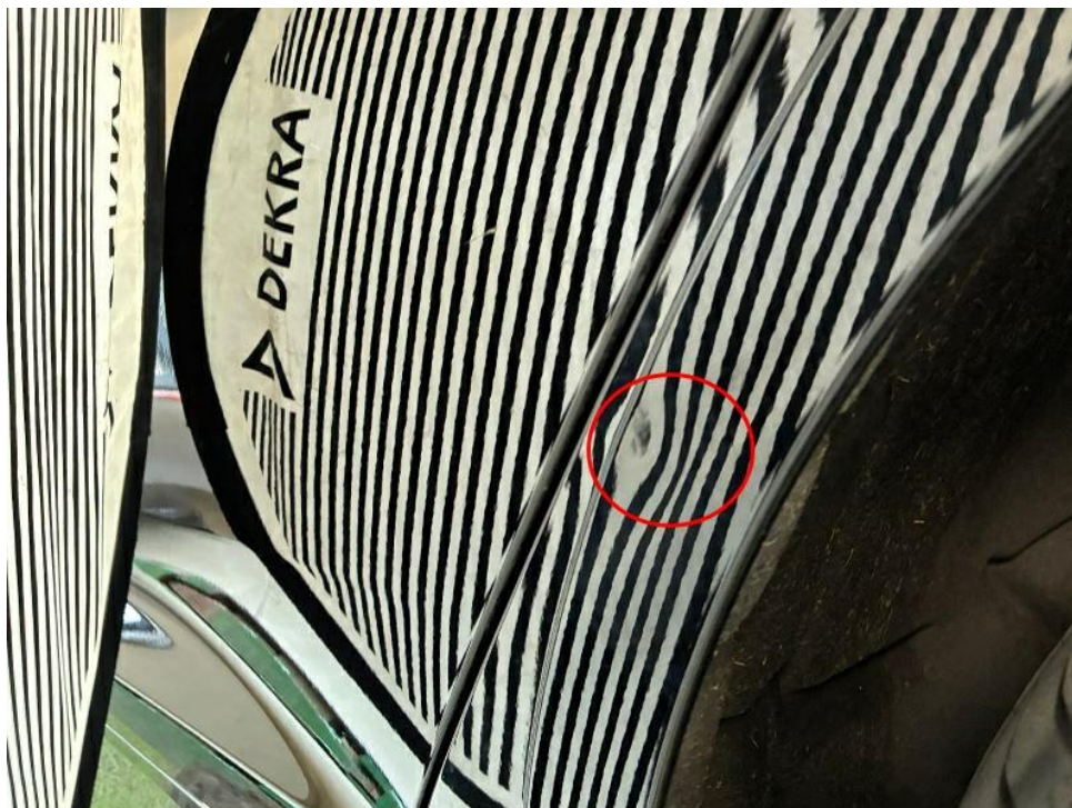
Bild 27 : Seitenwand hinten links Delle
