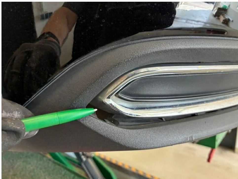
Bild 25 : Stoßfänger hinten + Deko Kratzer + Delle + Beschädigung
