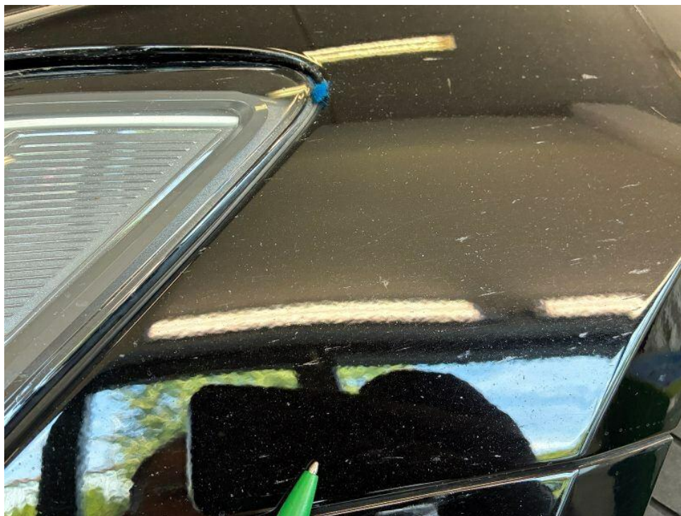
Bild 29 : Kotflügel vorne links Steinschlag
