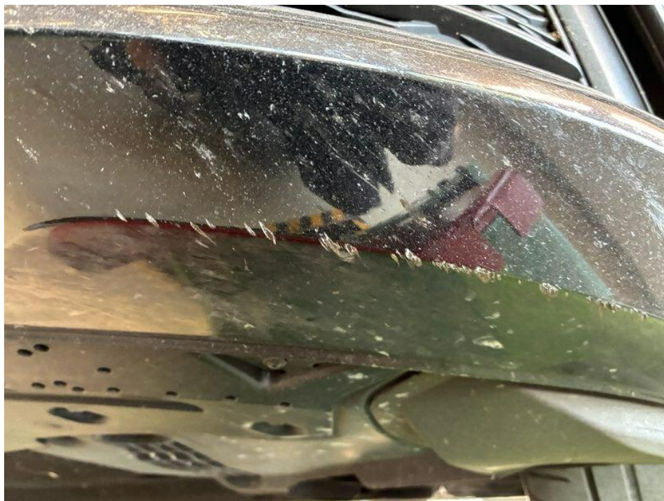
Bild 18 : Stoßfänger vorne Kratzer + Steinschlag
