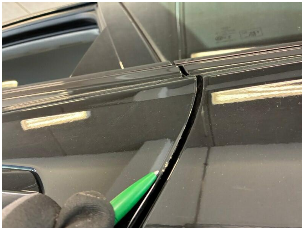
Bild 28 : Türe hinten links Kratzer
