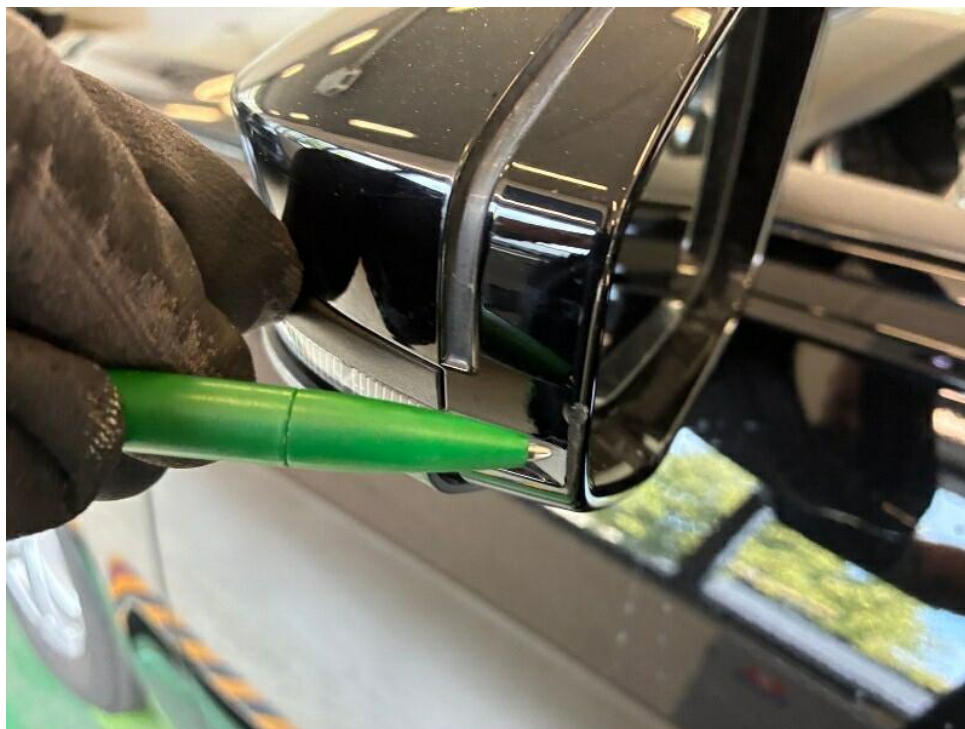
Bild 30 : Spiegelgehäuse links Kratzer
