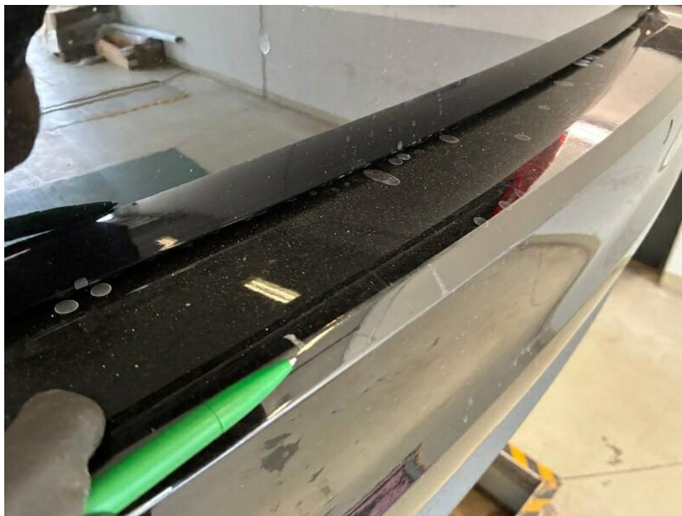
Bild 23 : Stoßfänger hinten + Deko Kratzer + Delle + Beschädigung
