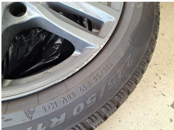
Beschädigung #1: 2.Radsatz: 1 Leichtmetallfelge - verkratzt / verschürft - kein Abzug
