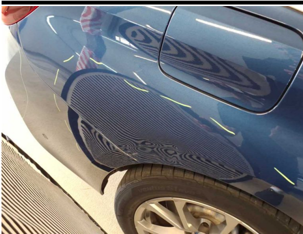
Beschädigung #10: Seitenwand rechts: Seitenwand - Delle / Lackschaden - instandsetzen und lackieren
