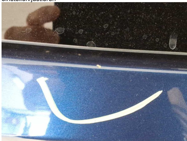
Beschädigung #6: Heckklappe/-tür: Heckklappe - verkratzt / verschürft - Smart Repair
