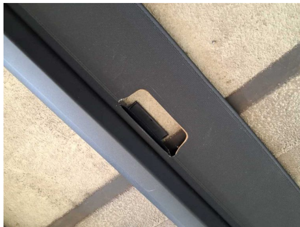
Beschädigung #2: Interieur: Laderaumabdeckung / Rollo (Abdeckung) - beschädigt - erneuern
