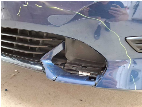
Beschädigung #11: Stossfänger vorn: Stossfänger vorn - beschädigt - erneuern
