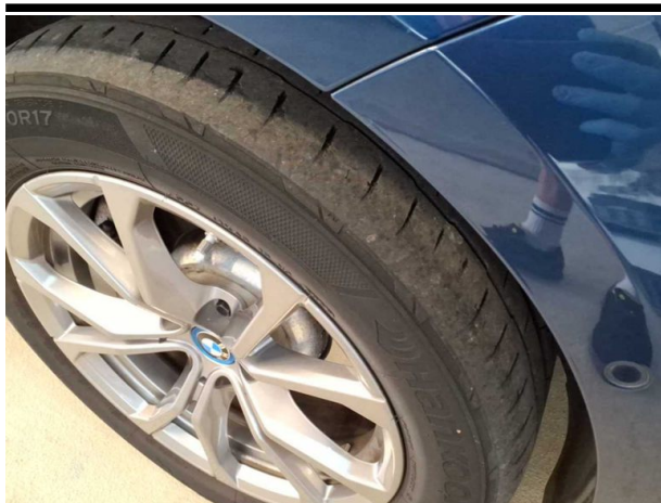
Beschädigung #5: Vermessung: Fahrwerk - Fehlstellung - einstellen/justieren
