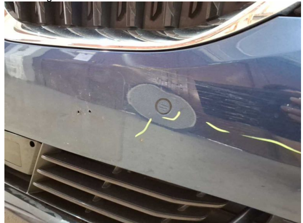
Beschädigung #11: Stossfänger vorn: Stossfänger vorn - beschädigt - erneuern
