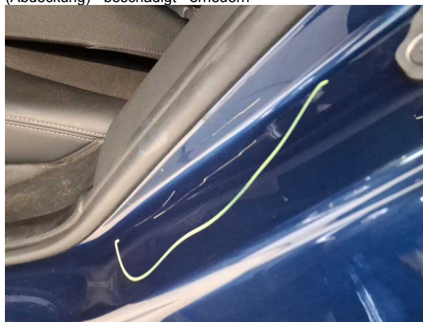
Beschädigung #3: Seitenwand links: Einstieg - verkratzt / verschürft - Smart Repair
