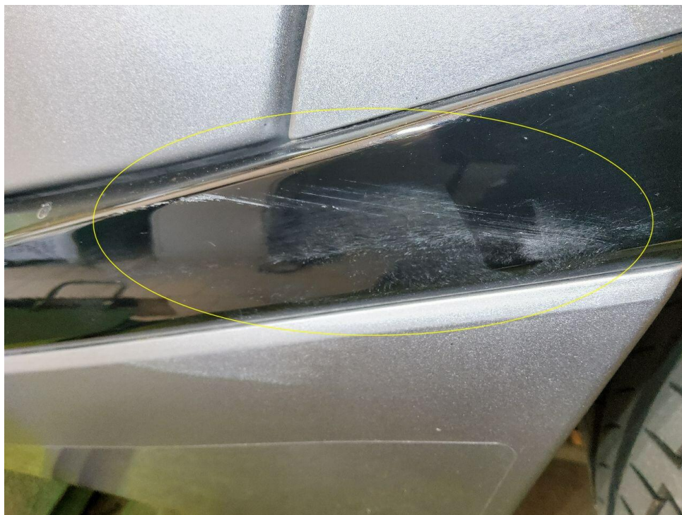
Bild 7 : Stoßleiste Tür hinten links zerkratzt
