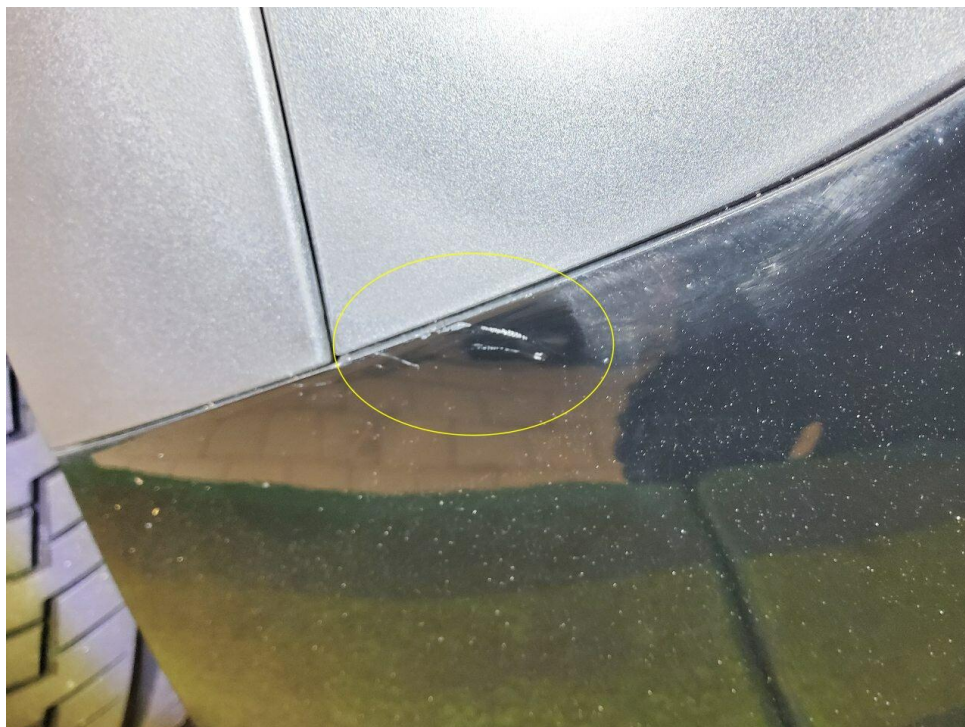
Bild 8 : Mittelblende Stoßfänger hinten links zerkratzt
