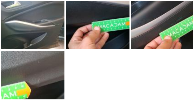
Door panel RR, Scratch(es), Replace
