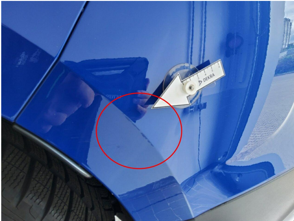
Bild 19 : Stoßfänger hinten links verschrammt
