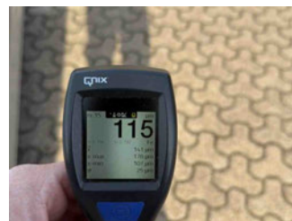
Lackstärke Kotflügel vorne links
