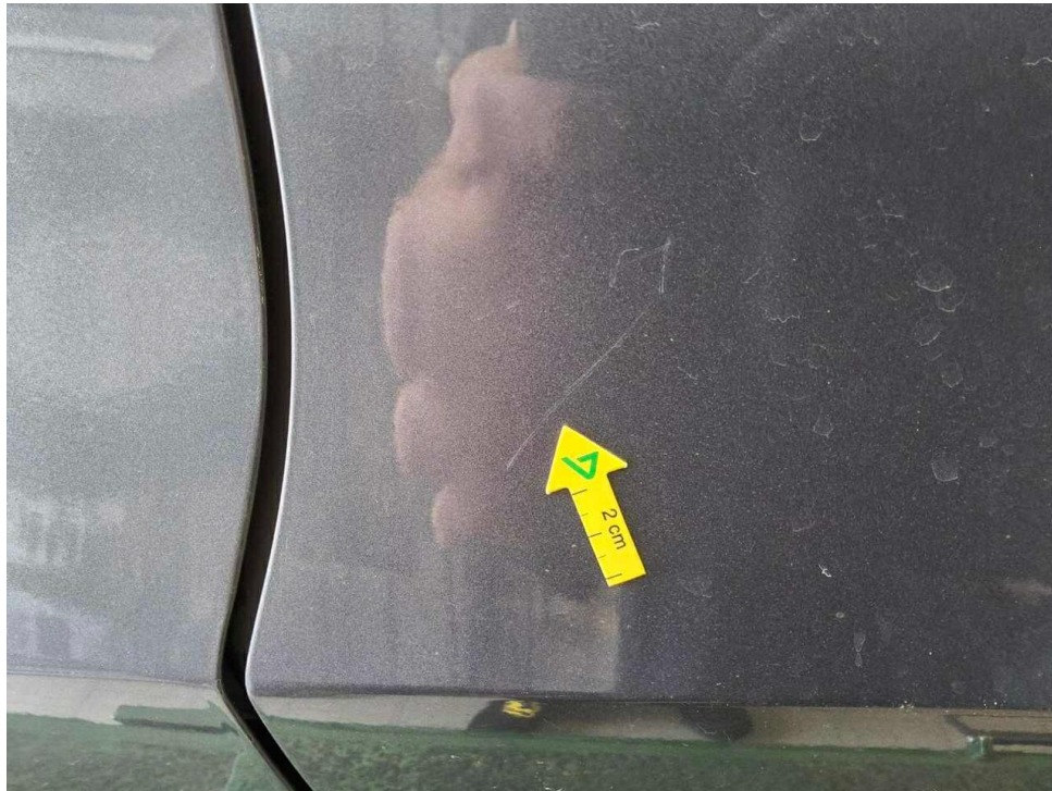
Bild 17 : Tür hinten links Lackierung, zerkratzt, lackieren mit Lackaufbau
