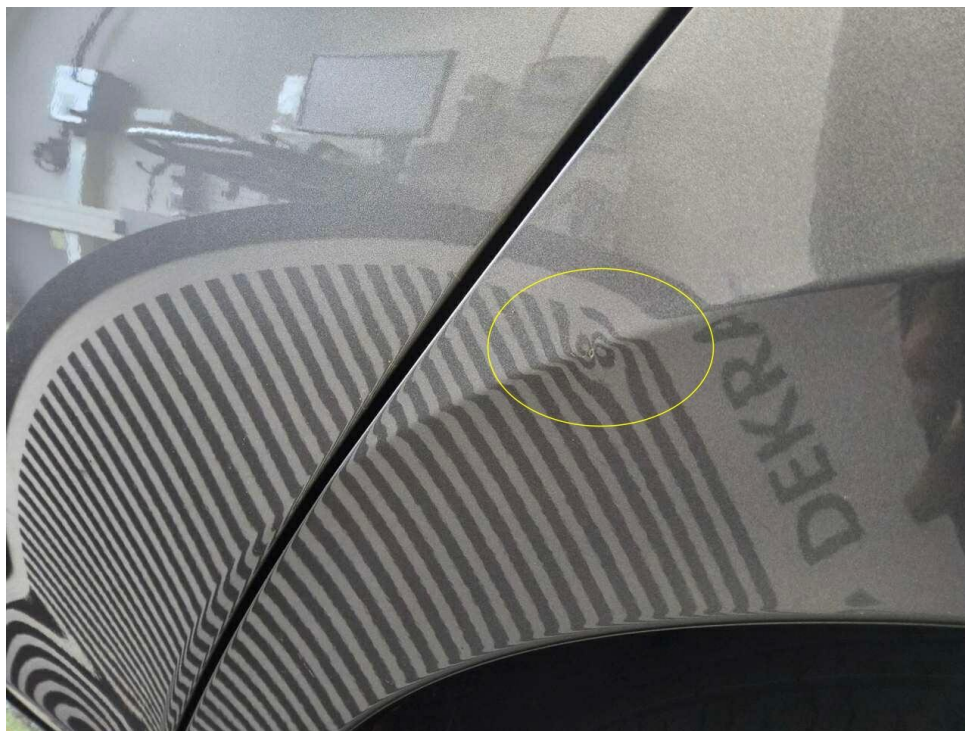
Bild 22 : Seitenteil hinten links, deformiert, instandsetzen und lackieren mit Lackaufbau
