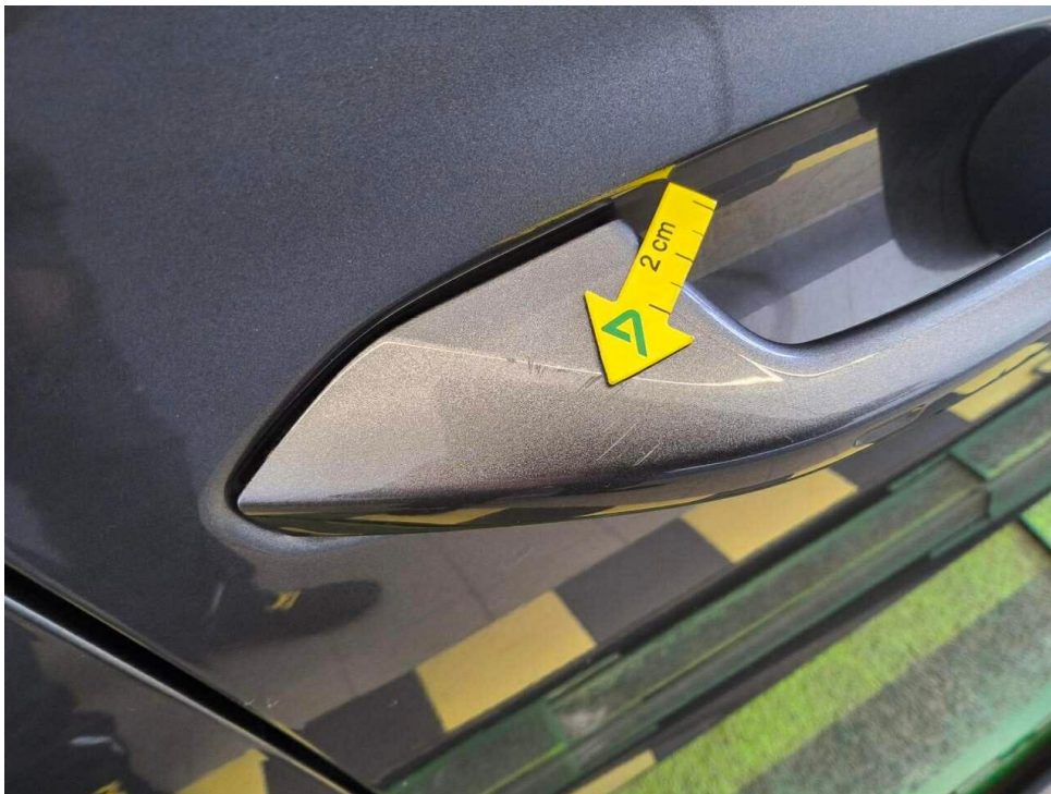
Bild 14 : Tür vorne rechts Türgriff, zerkratzt, smart repair
