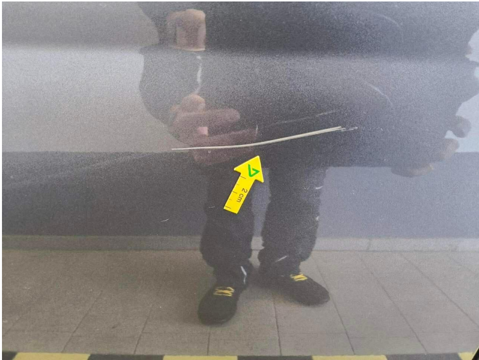
Bild 15 : Tür hinten rechts Lackierung, zerkratzt, lackieren mit Lackaufbau
