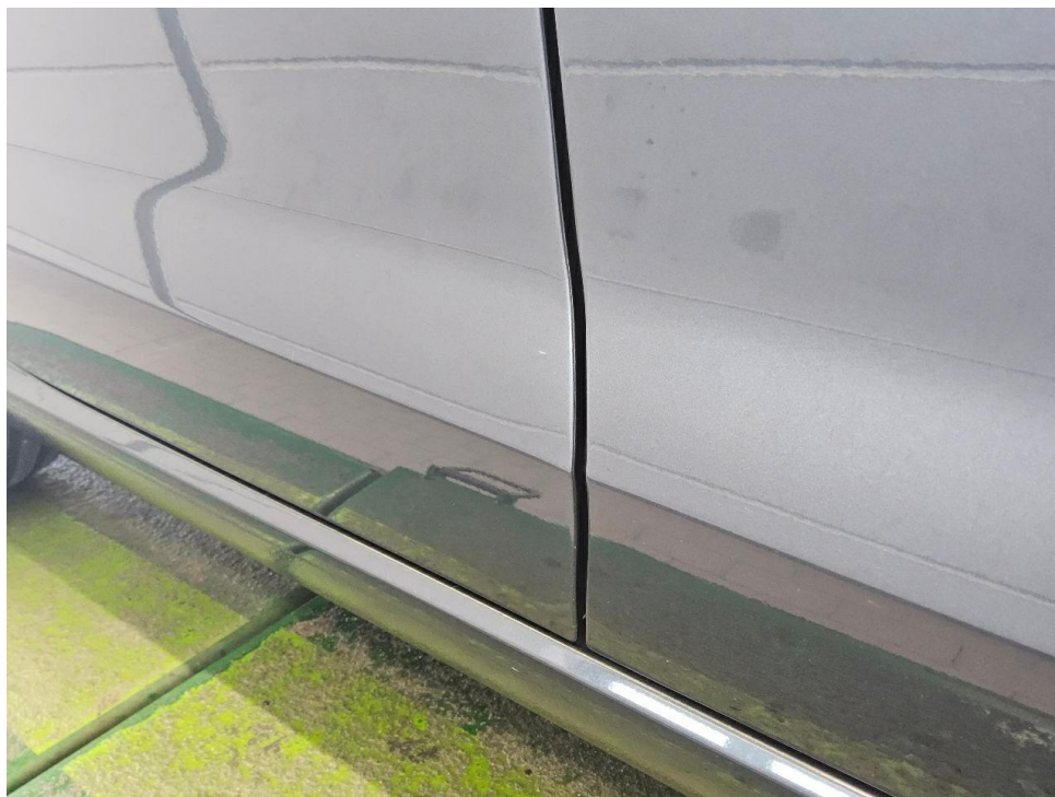
Bild 17 : Tür hinten rechts, Steinschlag, Gebrauchsspur
