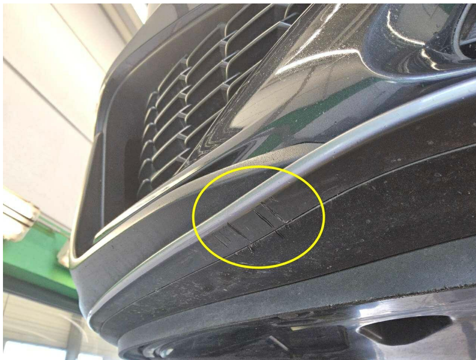
Bild 15 : Frontspoiler Lackierung, zerkratzt, smart repair
