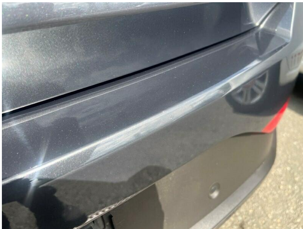
Bild 23 : Stoßfänger hinten, Ladekante verkratzt, Gebrauchsspur
