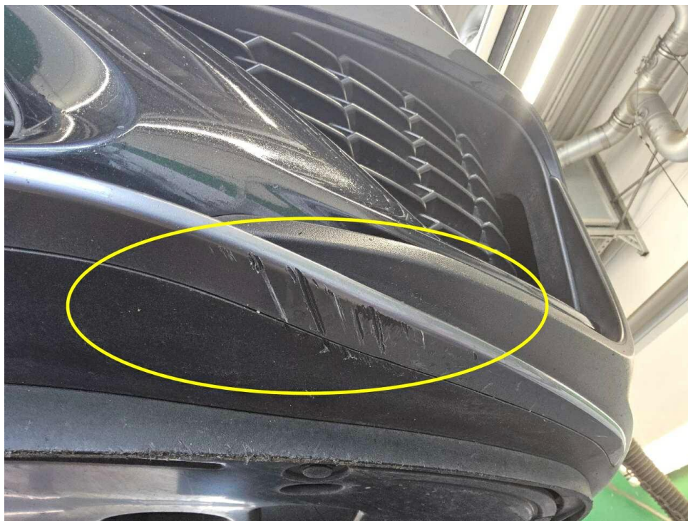
Bild 16 : Frontspoiler Lackierung, zerkratzt, smart repair
