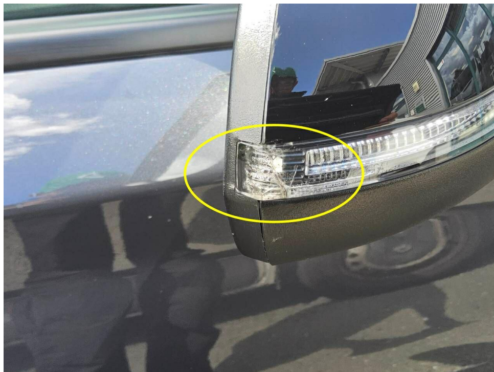
Bild 14 : Außenspiegel rechts, Blinkerglas gebrochen
