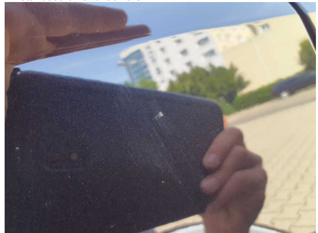
Beschädigung #4: Tür hinten rechts: Tür - Delle / Lackschaden... - instandsetzen und lackieren
