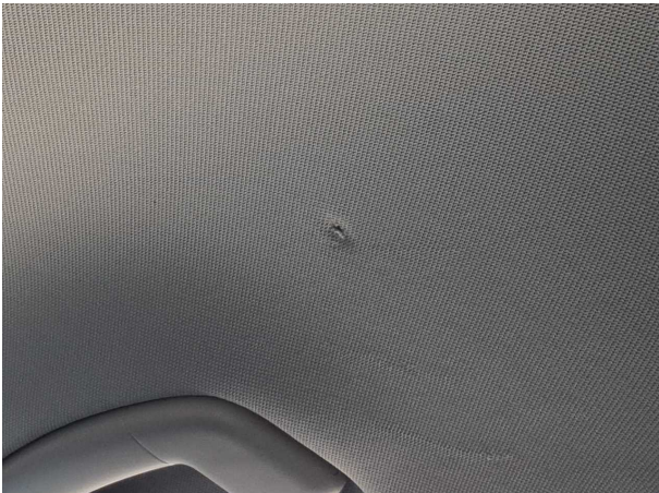
Beschädigung #3: Verkleidungen/Abdeckungen: Dachhimmel - Löcher - erneuern
