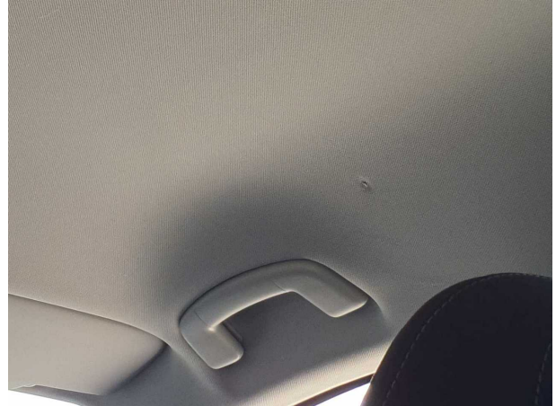
Beschädigung #3: Verkleidungen/Abdeckungen: Dachhimmel... Löcher - erneuern
