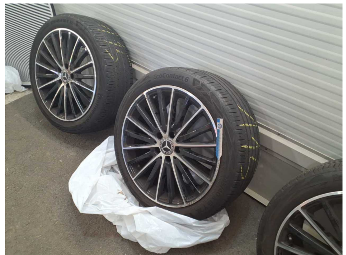
Damage 6: 2nd wheel set: 1 alloy rim (Mit Materialabtrag, Felge 2. Achse) - Scratched - Replace
