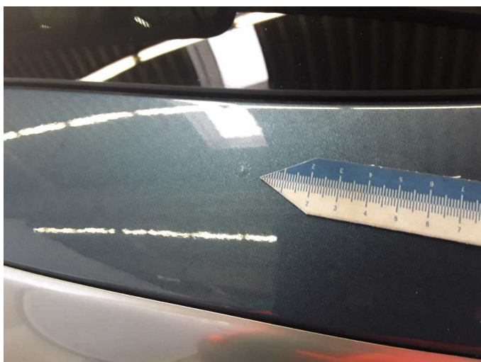
Damage 13: Boot lid / rear door: Boot lid (Rostansatz) - Corrosion - Paint
