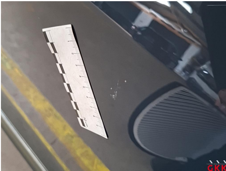
Bild 26 Tür vorne rechts, beschädigt, instand setzen - lackieren
