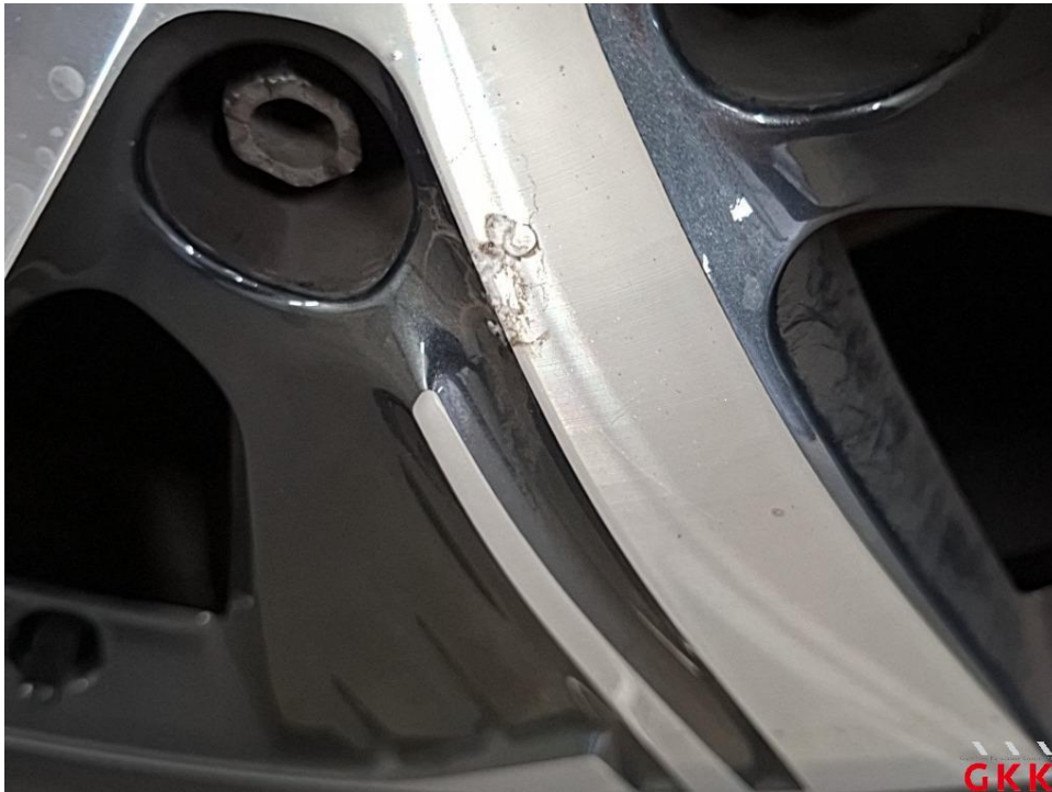
Bild 17 LM-Rad, vorne links, verkratzt, aufbereiten
