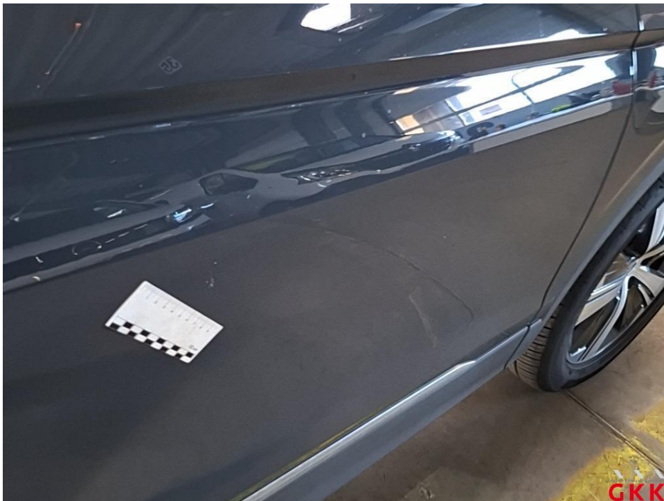
Bild 24 Tür vorne rechts, beschädigt, instand setzen - lackieren
