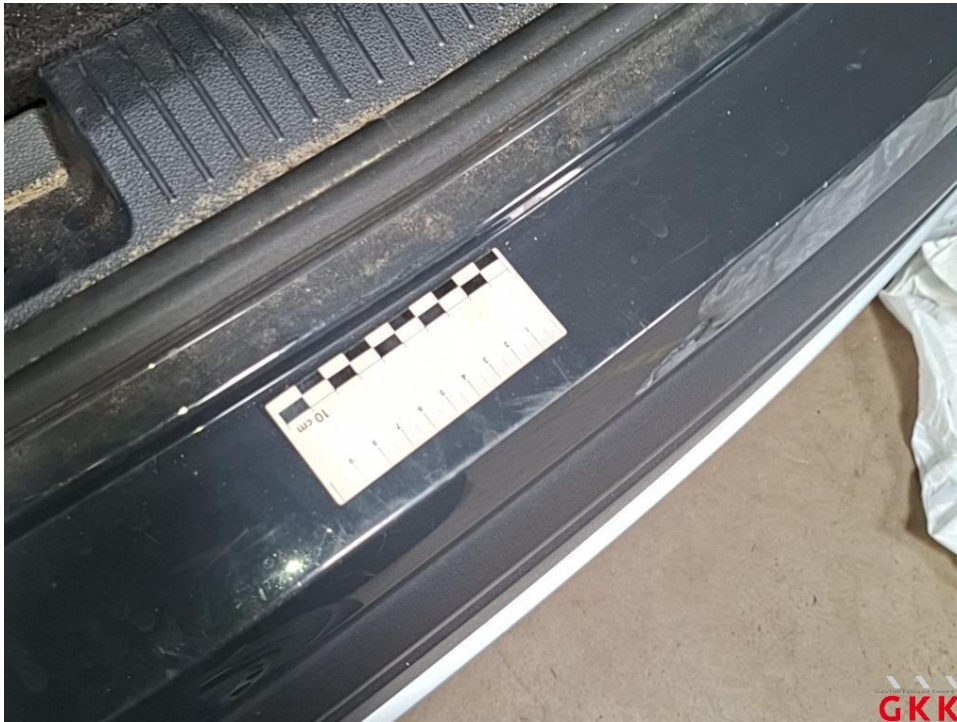
Bild 21 Stoßfänger hinten, Verkleidung oberhalb -lackiert-, verkratzt, lackieren
