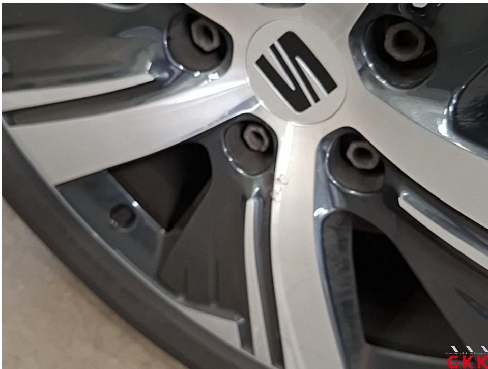
Bild 16 LM-Rad, vorne links, verkratzt, aufbereiten
