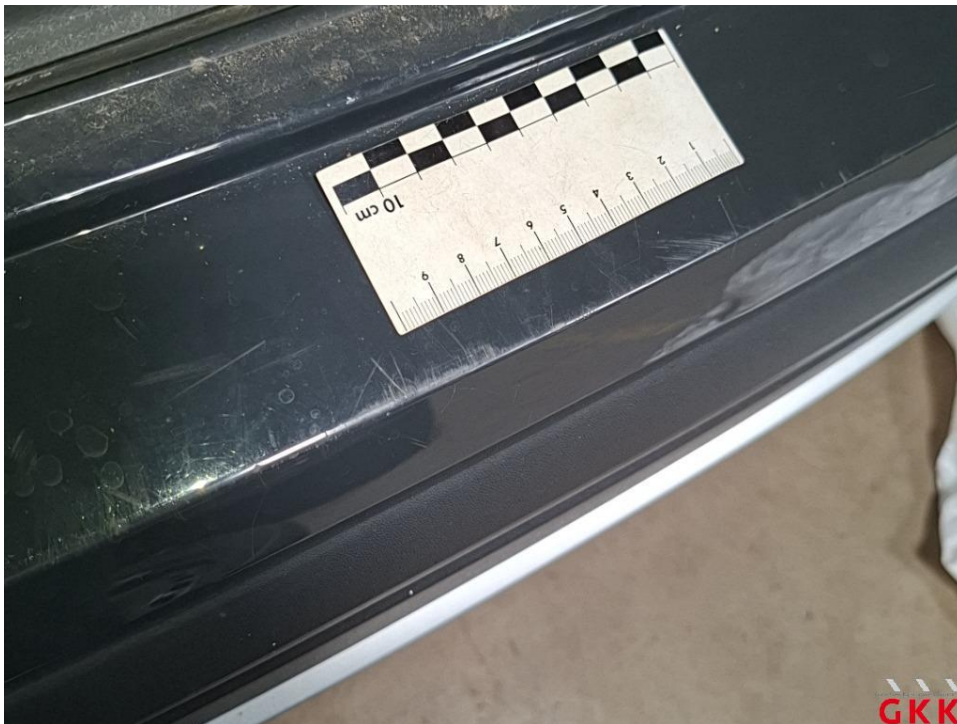
Bild 22 Stoßfänger hinten, Verkleidung oberhalb -lackiert-, verkratzt, lackieren
