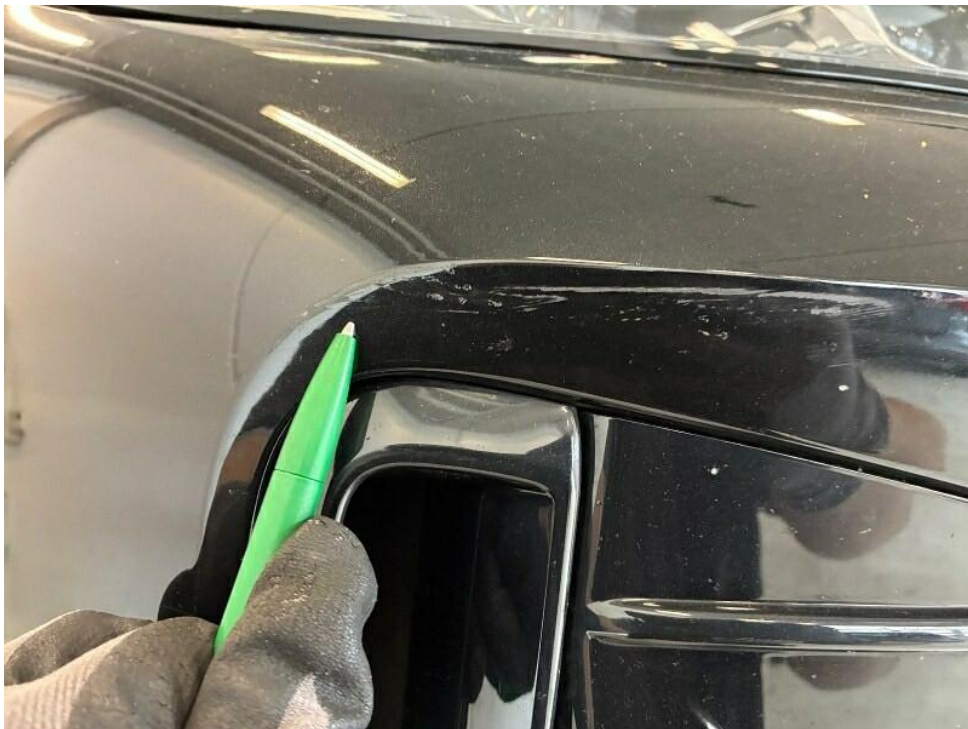
Bild 16 : Stoßfänger vorne Kratzer + Abschürfung
