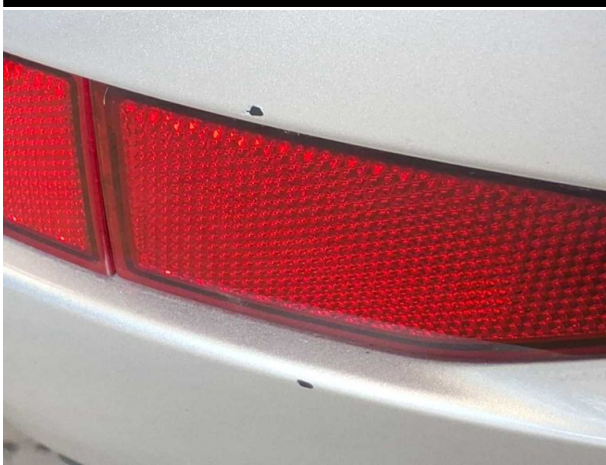
Beschädigung #2: Stossfänger hinten: Stossfänger hinten - Kratzer - instandsetzen und lackieren
