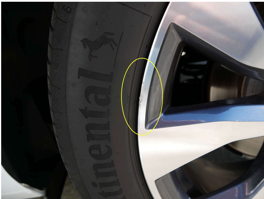
Bild 22 Alufelge HL verschrammt.
