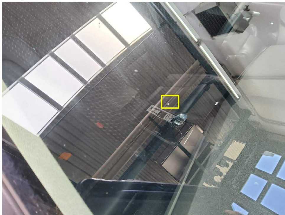
Bild 15 : Frontscheibe, oberflächliche Abplatzung
