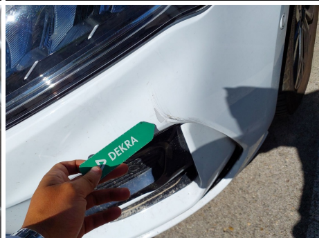
Paragolpes / Delantero / Abolladura
