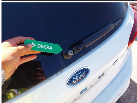
Cubierta de la escobilla del limpiaparabrisas / Trasero / Faltante
