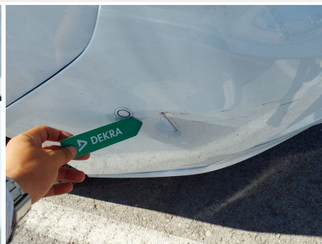
Paragolpes / Trasero / Abolladura
