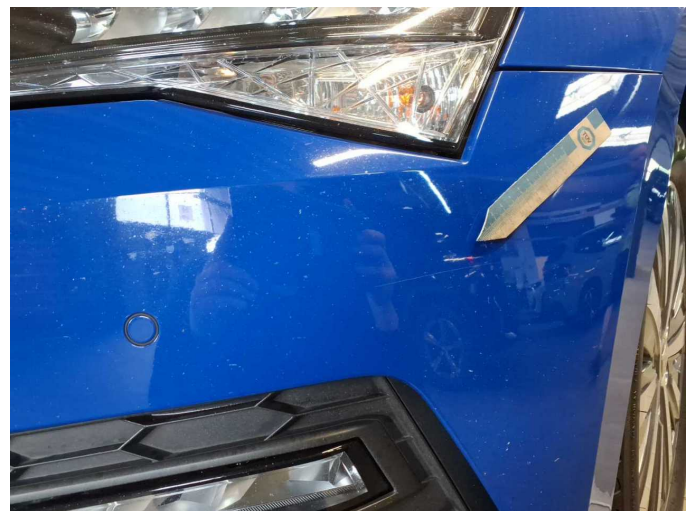
Damage 7: Front bumper: Front bumper (Sandstrahleffekt, Kratzer, fehlstellung) - Stone chips - Paint
