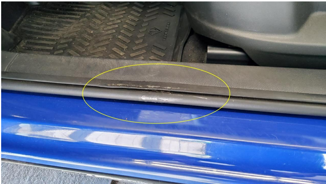
Bild 14 : Türdichtung vorne links Einstieg gerissen
