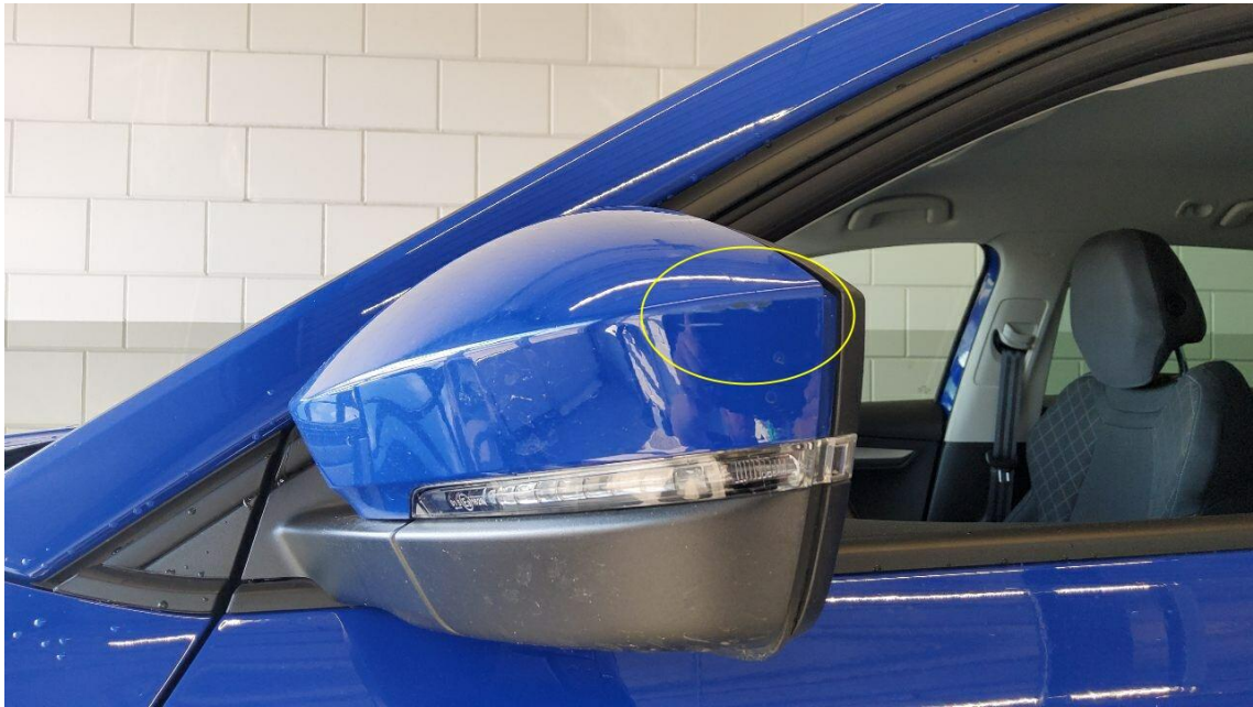
Bild 15 : Spiegelkappe links zerkratzt
