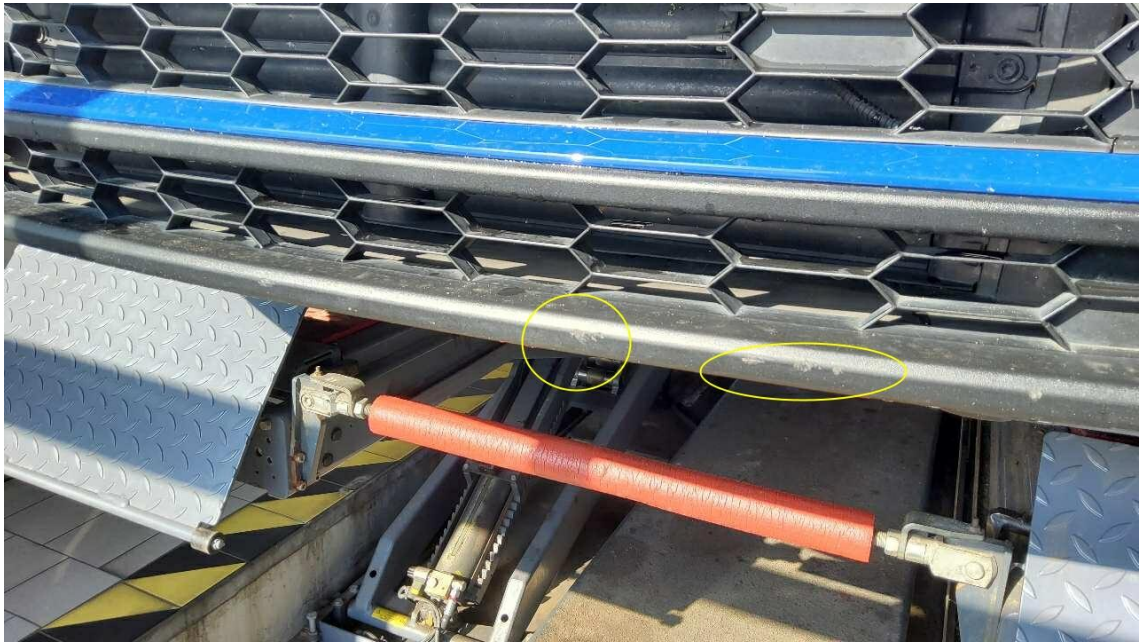
Bild 21 : Stoßfänger vorne Spoiler Kratzer
