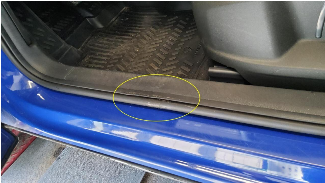
Bild 13 : Türdichtung vorne links Einstieg gerissen
