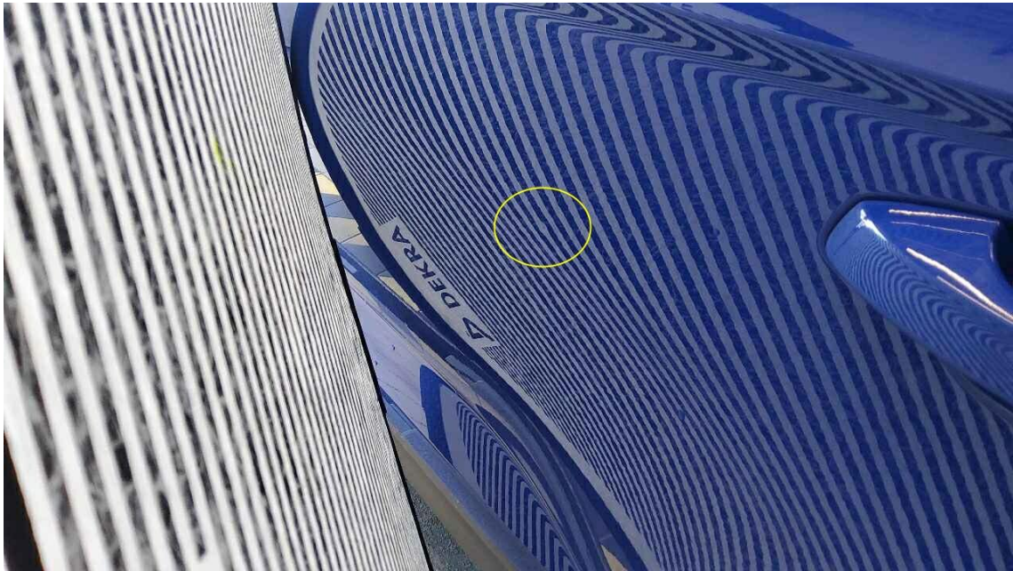
Bild 17 : Delle Tür hinten links
