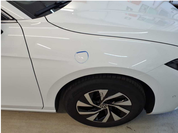
Beschädigung #2: Kotflügel rechts: Kotflügel rechts - Delle / Lackschaden - Smart Repair
