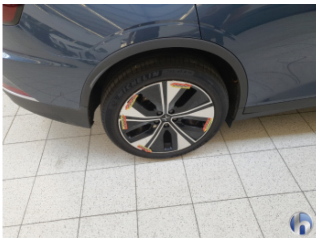
6. Felge Hinten - Rechts Beschädigt - Smart Repair
