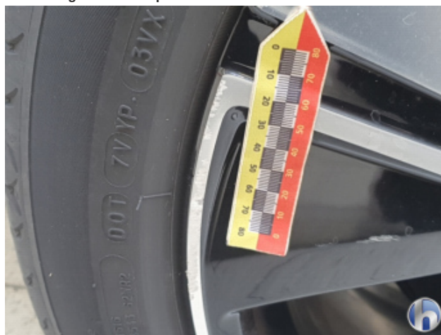
6. Felge Hinten - Rechts Beschädigt - Smart Repair
