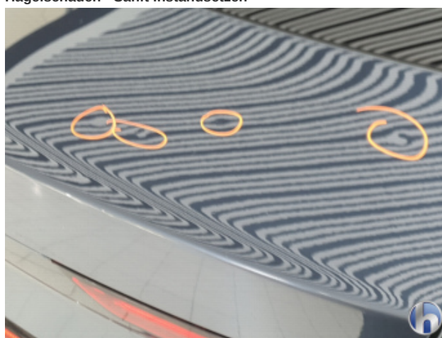
9. Heckklappe Hagelschaden - Sanft Instandsetzen
