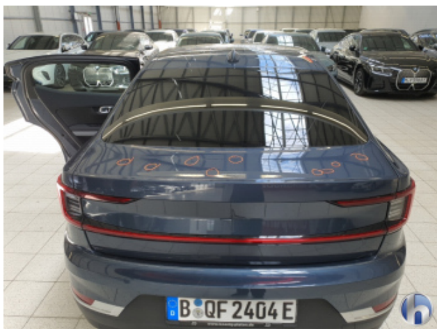
9. Heckklappe Hagelschaden - Sanft Instandsetzen
