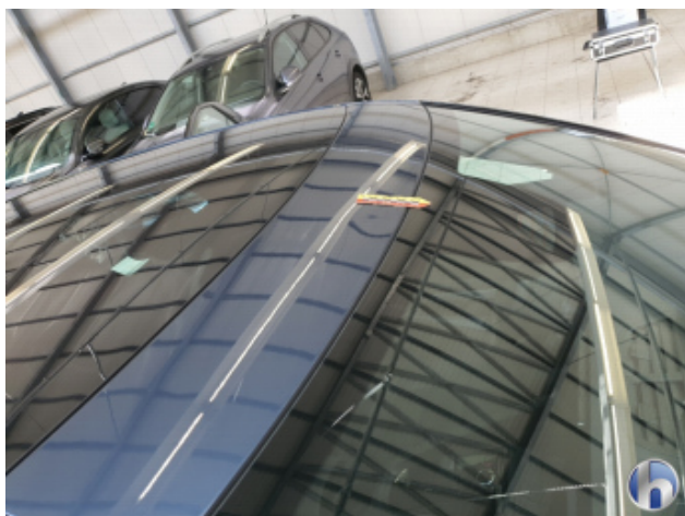
4. Dach Hagelschaden - Sanft Instandsetzen
