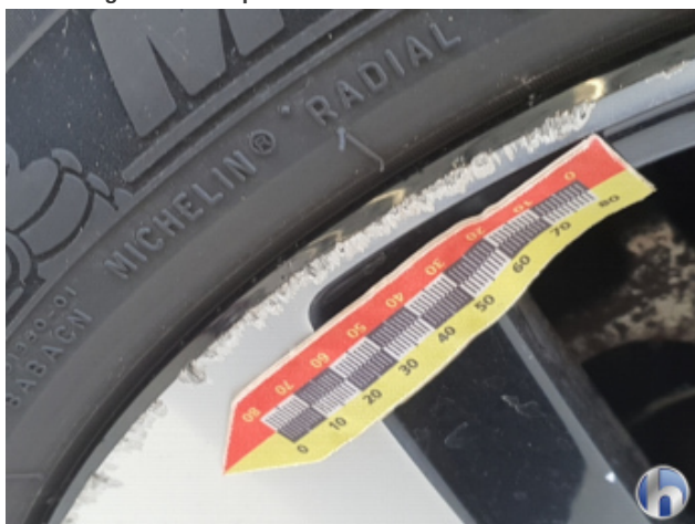
6. Felge Hinten - Rechts Beschädigt - Smart Repair
