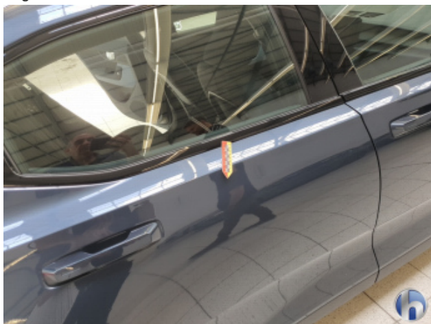
5. Tür Hinten - Rechts 1 Delle - Sanft Instandsetzen
