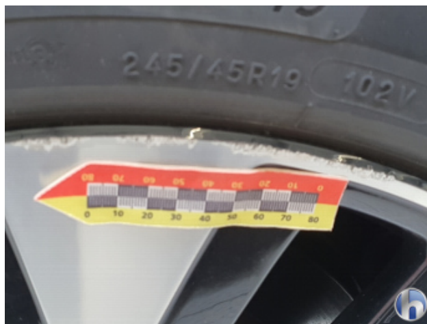
6. Felge Hinten - Rechts Beschädigt - Smart Repair
