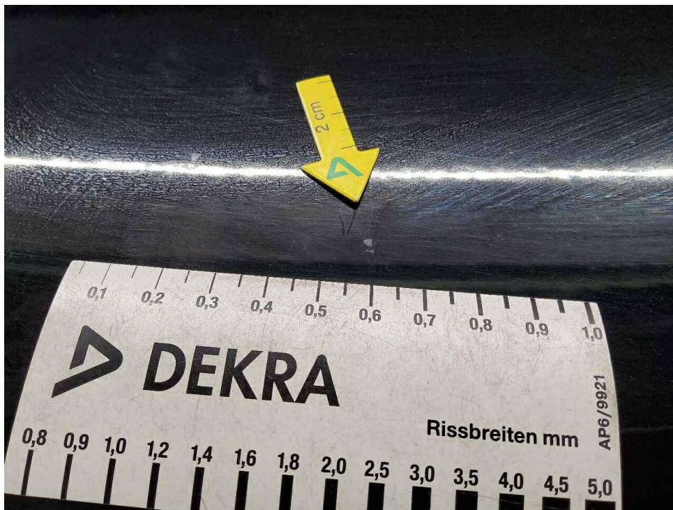
Bild 24 : Tür hinten rechts, Steinschlag, eingedellt
