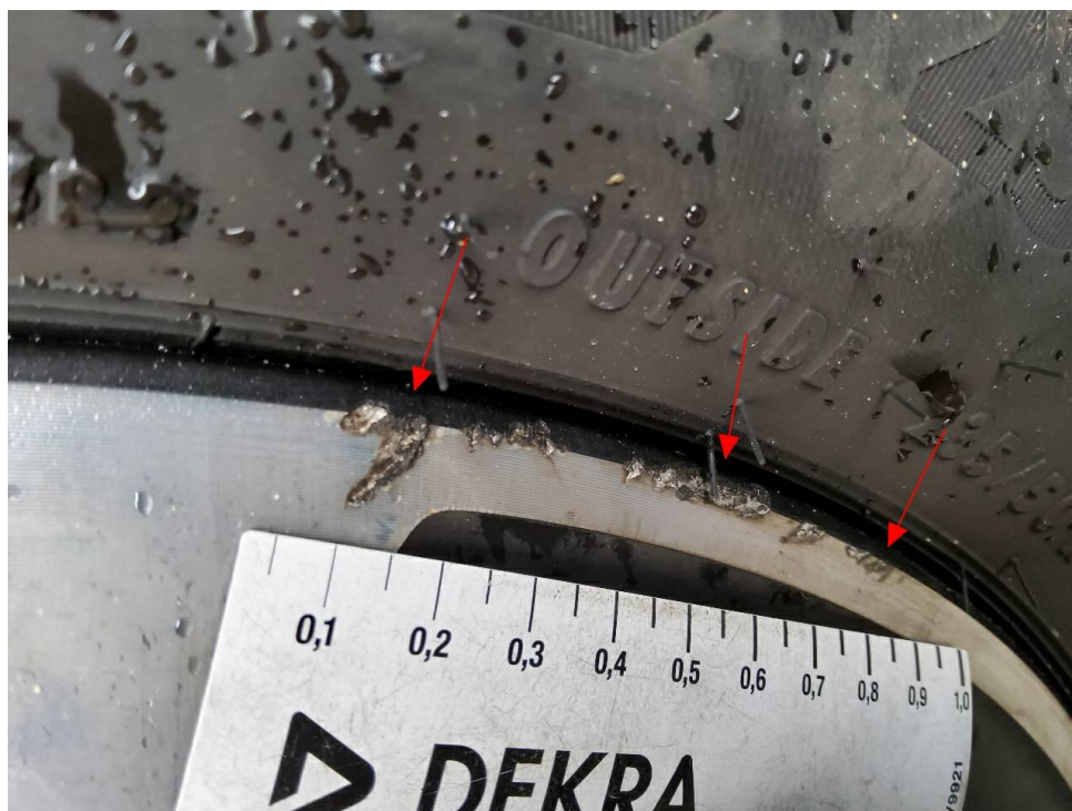
Bild 29 : LM-Felge vorne rechts, glanzgedreht, verschrammt
