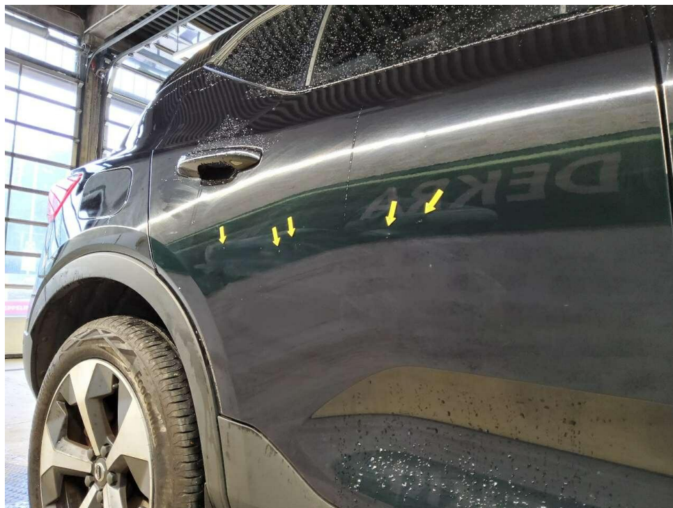
Bild 19 : Tür hinten rechts, Steinschlag, eingedellt
