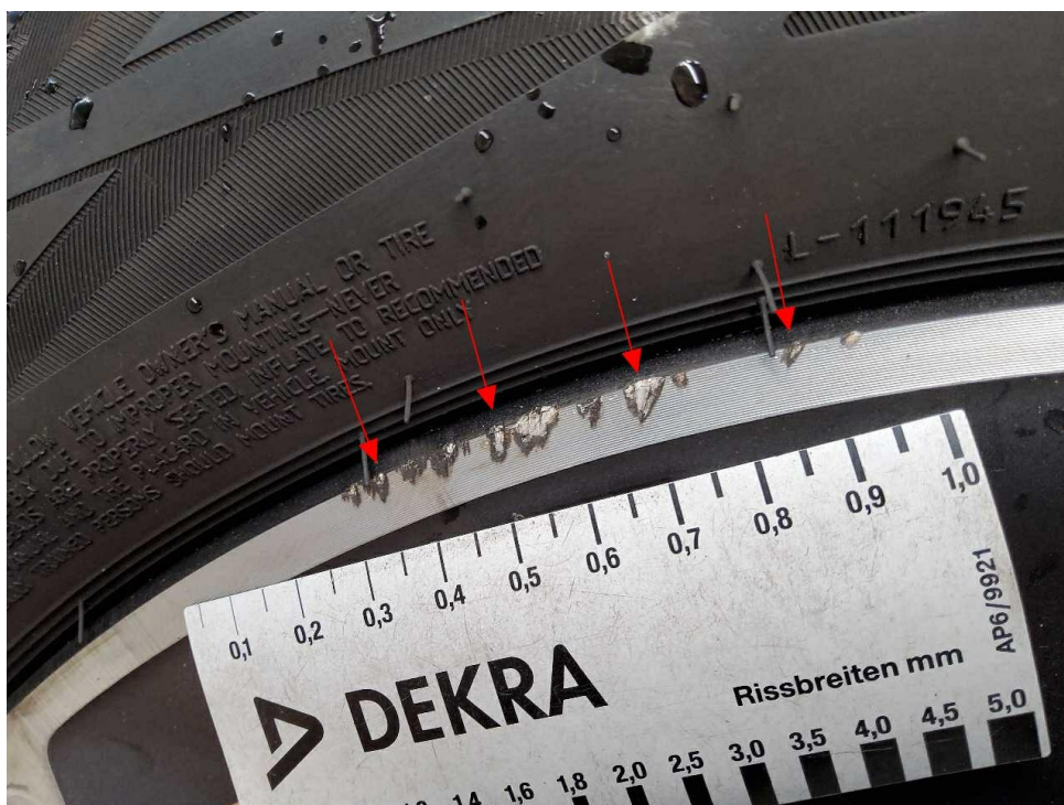
Bild 28 : LM-Felge vorne rechts, glanzgedreht, verschrammt
