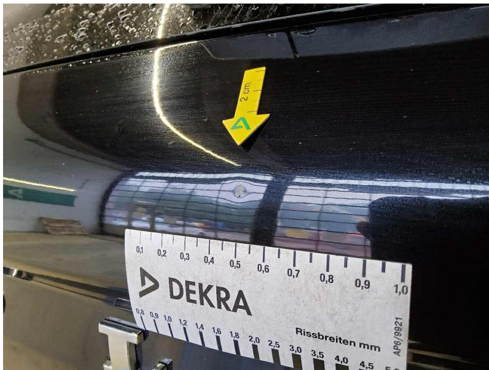
Bild 26 : Heckklappe, eingedellt, zerkratzt
