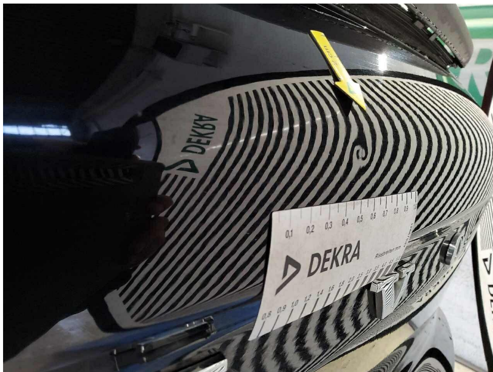
Bild 27 : Heckklappe, eingedellt, zerkratzt
