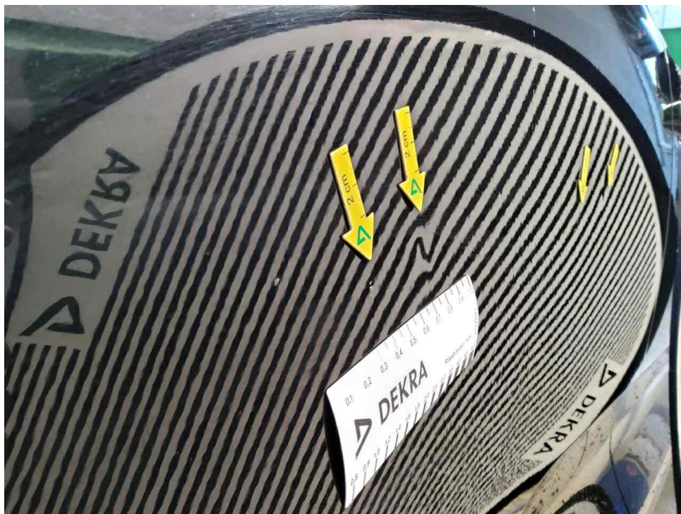
Bild 23 : Tür hinten rechts, Steinschlag, eingedellt
