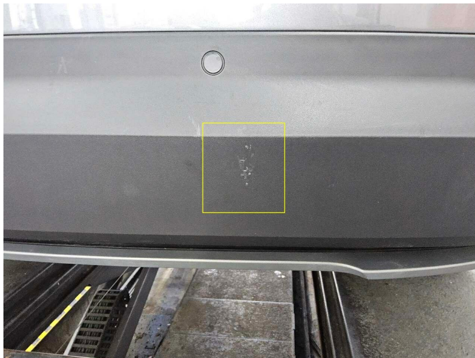
Bild 15 : Stoßfänger hinten Blende unten, zerkratzt
