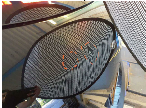
Beschädigung #2: Heckklappe/-tür: Heckklappe - Delle(n) - sanft instandsetzen
