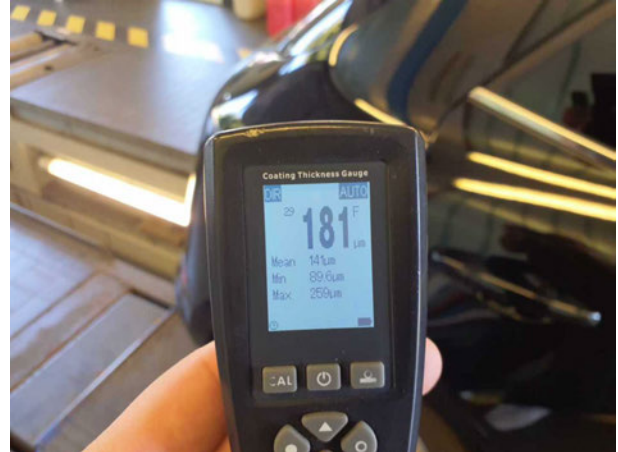
Nachlackierung 1: Seitenwand rechts
