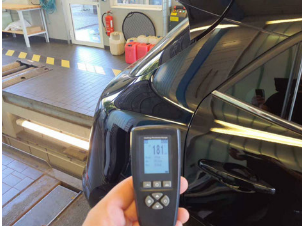
Nachlackierung 1: Seitenwand rechts
