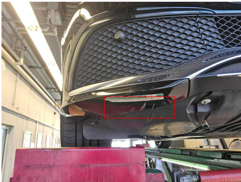
Bild 15 : Stoßfänger vorne Lackierung, verschrammt, smart repair
