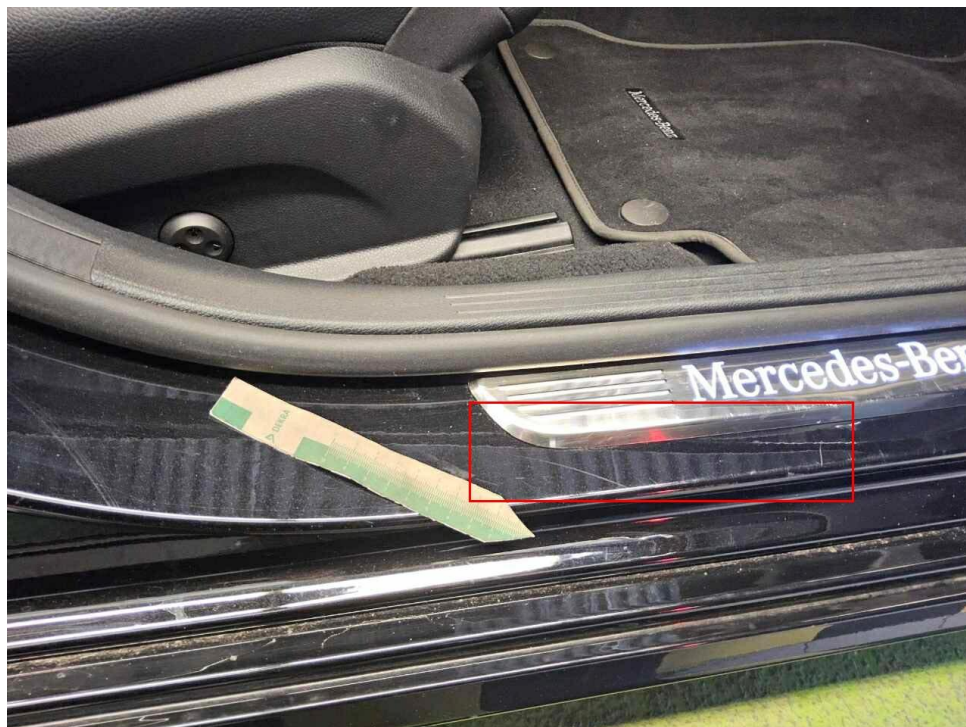
Bild 18 : Tür vorne rechts Einstieg, zerkratzt, polieren
