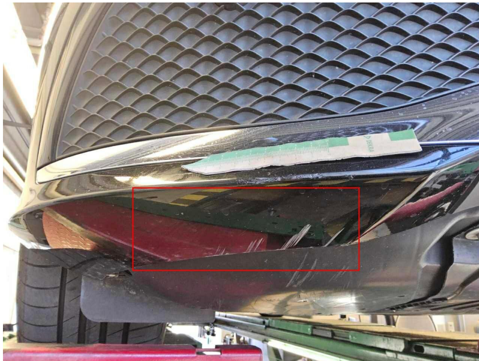
Bild 14 : Stoßfänger vorne Lackierung, verschrammt, smart repair
