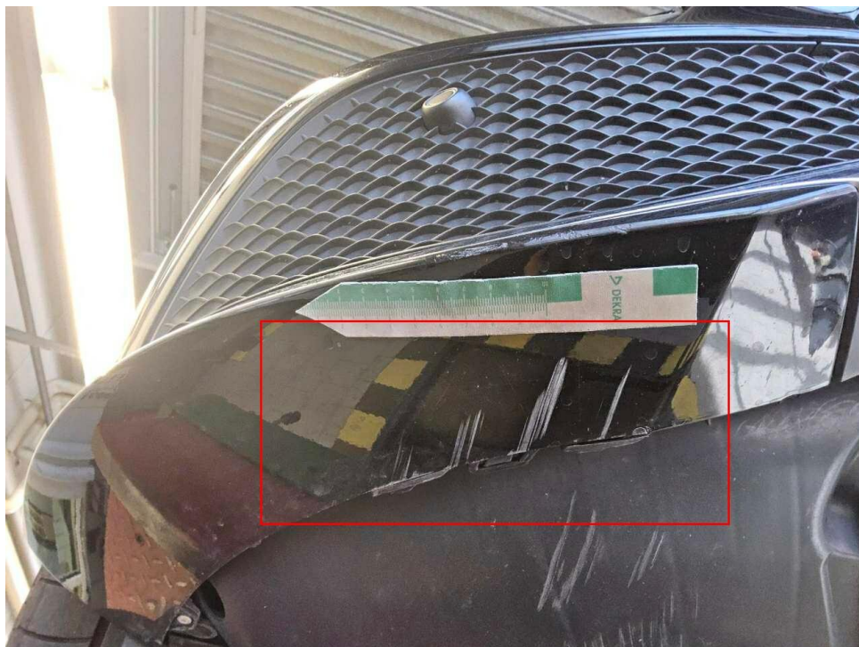
Bild 16 : Stoßfänger vorne Lackierung, verschrammt, smart repair
