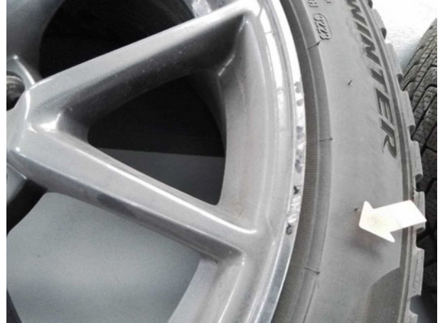
Beschädigung #1: 2.Radsatz: 1 Leichtmetallfelge (Winter) - verkratzt / verschürft - Wertminderung
