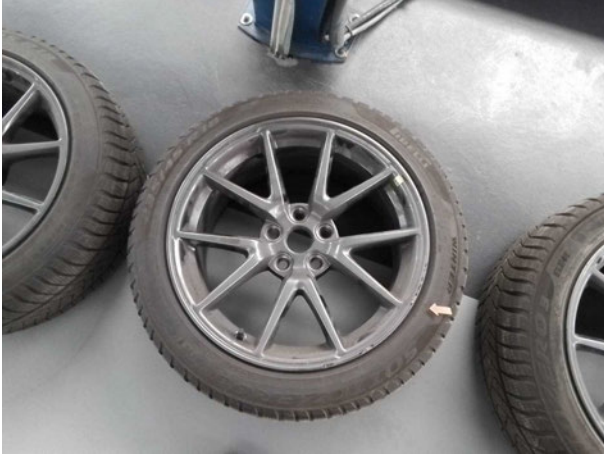
Beschädigung #1: 2.Radsatz: 1 Leichtmetallfelge (Winter) - verkratzt / verschürft - Wertminderung
