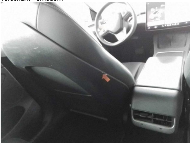
Beschädigung #5: Sitz vorn: Sitzkastenverkleidung links - verkratzt / verschürft - erneuern
