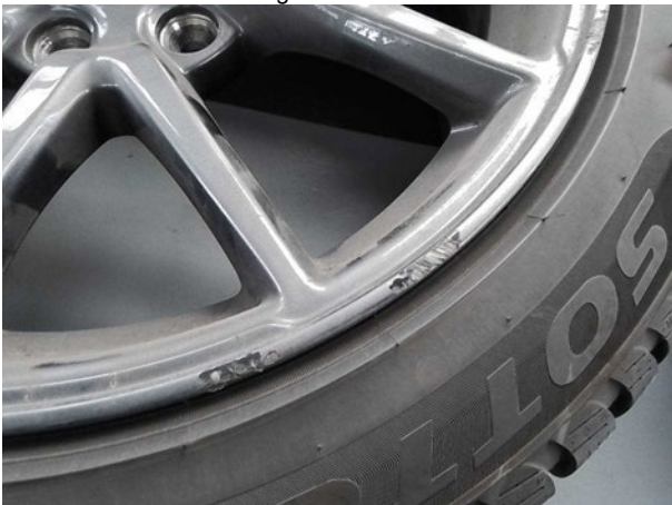
Beschädigung #1: 2.Radsatz: 1 Leichtmetallfelge (Winter) - verkratzt / verschürft - Wertminderung
