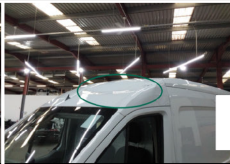
Dach / Vorne / Delle
