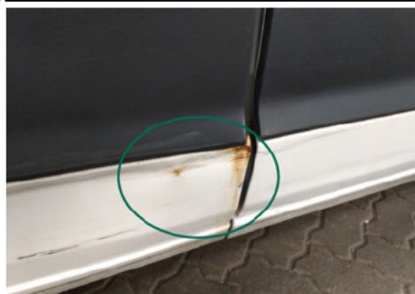
Schweller / Hinten Rechts / Delle
