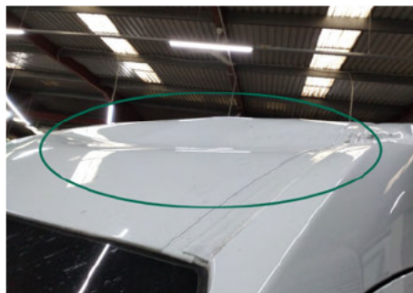
Dach / Vorne / Delle
