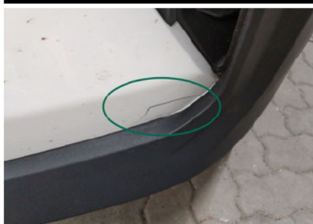
Stoßfänger oberhalb / Vorne / Gebrochen
