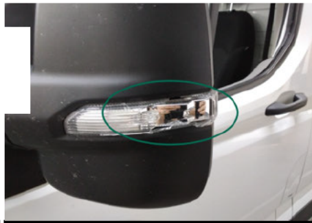
Blinker / Links / Gebrochen
