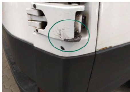
Heckklappen / Kofferraumtürscharnier / Unten Rechts / Abgewetzt
