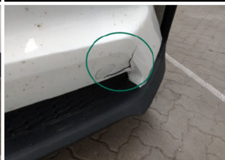
Stoßfänger oberhalb / Vorne / Gebrochen
