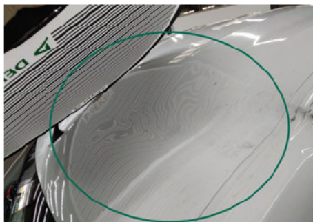
Dach / Vorne / Delle
