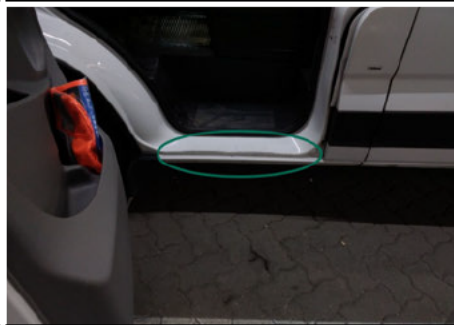
Türeinstieg / Vorne Links / Abgewetzt
