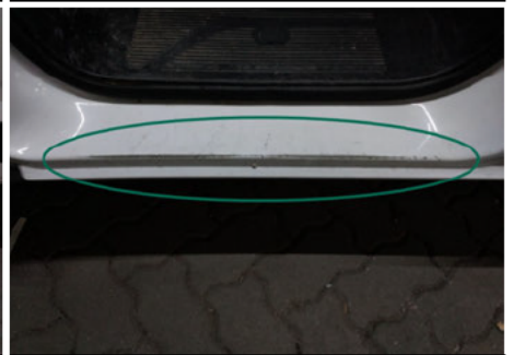
Türeinstieg / Vorne Links / Abgewetzt
