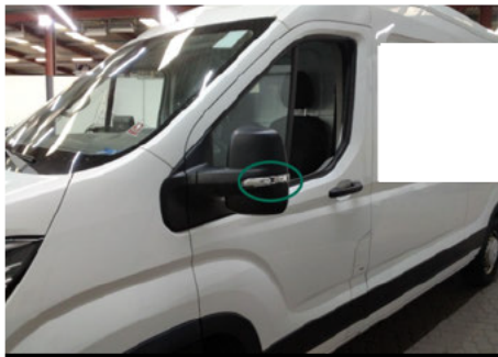
Blinker / Links / Gebrochen
