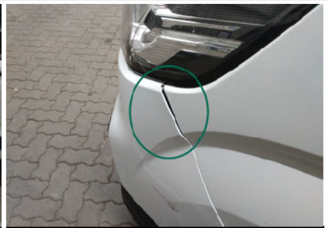
Stoßfängerhalter / Vorne Links / Defekt
