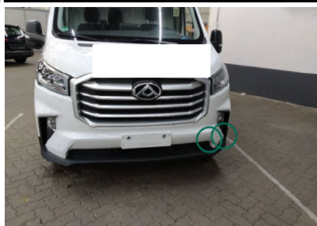
Stoßfänger oberhalb / Vorne / Gebrochen
