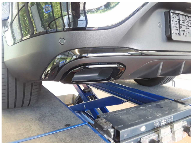
Beschädigung #1: Sonstiges: Sonstiges (Blende Schwarz Stossfänger hinten links) - Kratzer - Smart Repair
