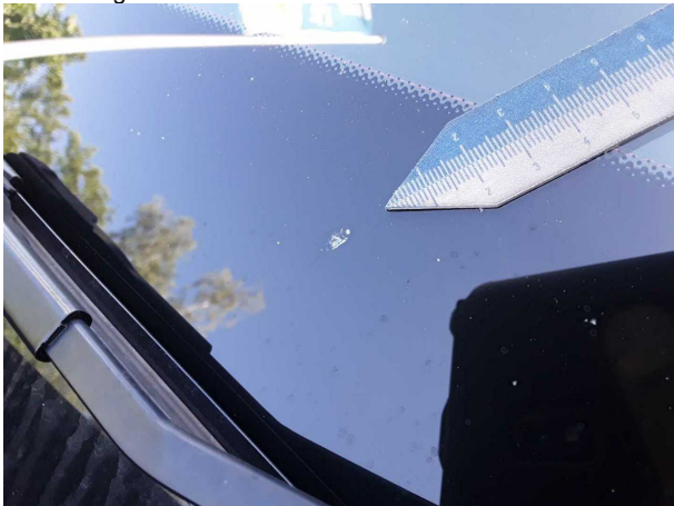
Beschädigung #11: Verglasung: Frontscheibe (Mit Rissbildung) - Steinschlag - erneuern
