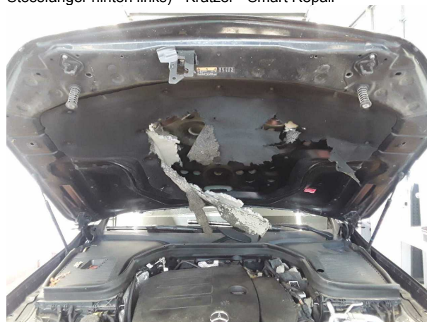
Beschädigung #2: Motorhaube: Dämmmatte - beschädigt - erneuern
