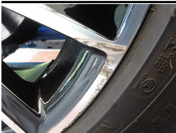
Beschädigung #12: Rad/Reifen: Leichtmetallfelge hinten rechts (Sommerradsatz) - verkratzt / verschürft - erneuern
