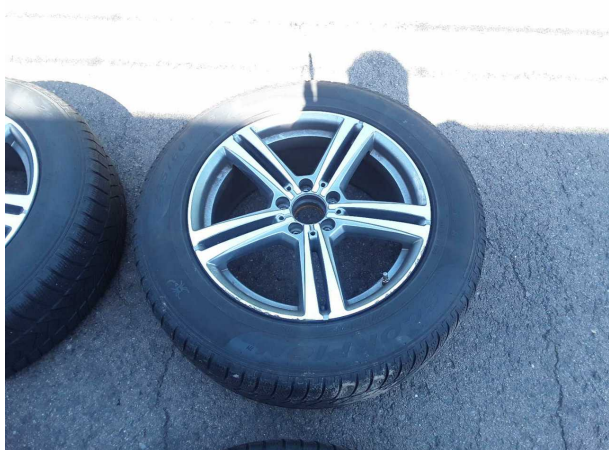
Beschädigung #9: Rad/Reifen: Leichtmetallfelge vorn rechts (Winterradsatz) - verkratzt / verschürft - erneuern
