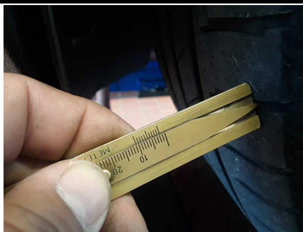
Beschädigung #3: Rad/Reifen: Reifen vorn (Beidseitig) - verschlissen - erneuern
