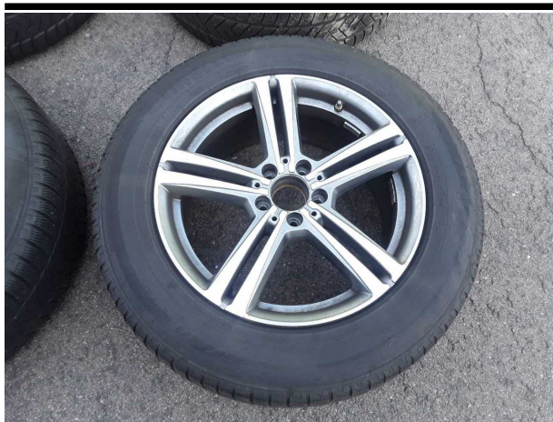
Beschädigung #8: 2.Radsatz: Reifensatz komplett - verschlissen - erneuern
