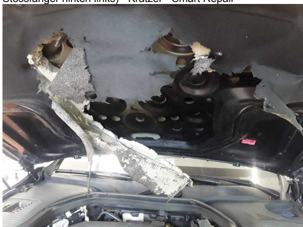
Beschädigung #2: Motorhaube: Dämmmatte - beschädigt - erneuern
