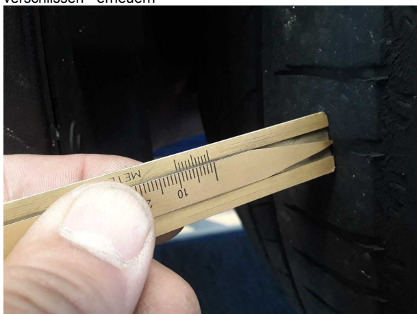
Beschädigung #3: Rad/Reifen: Reifen vorn (Beidseitig) - verschlissen - erneuern
