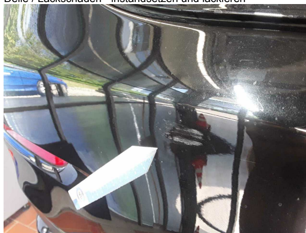
Beschädigung #13: Stossfänger hinten: Stossfänger hinten - Delle / Lackschaden - instandsetzen und lackieren
